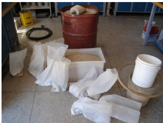
Figura 4. 15 – Preparação e pesagem dos componentes do graute.
