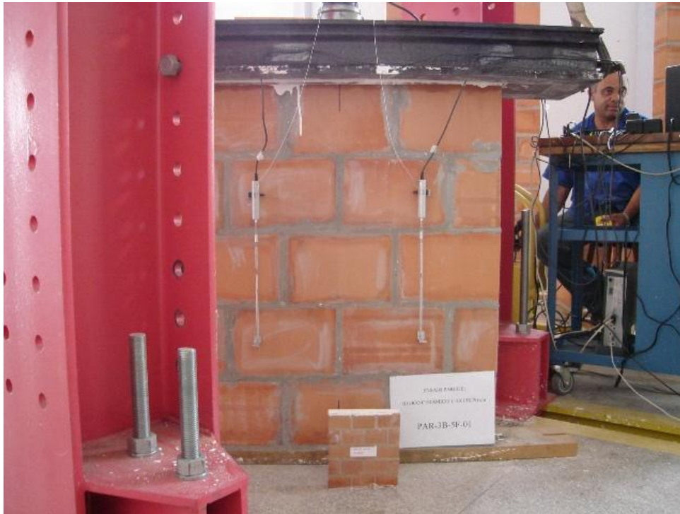
Figura 5. 16 – Painel PAI3B5F na escala natural (1:1) e reduzida (1:5).
