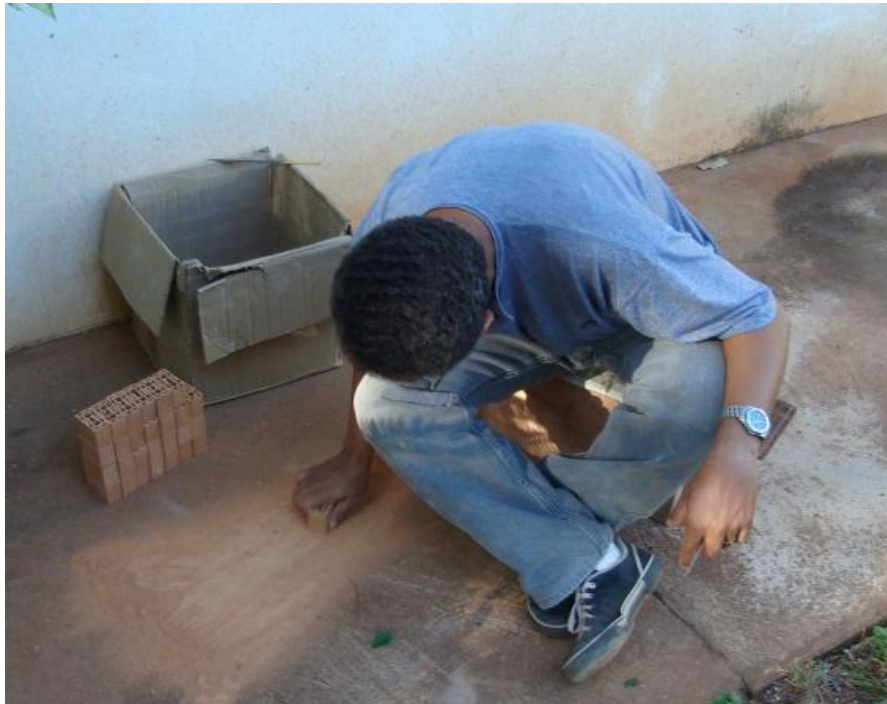
Figura 6.27 – Detalhes do ajuste da altura dos blocos cerâmicos na escala reduzida 1:5.
