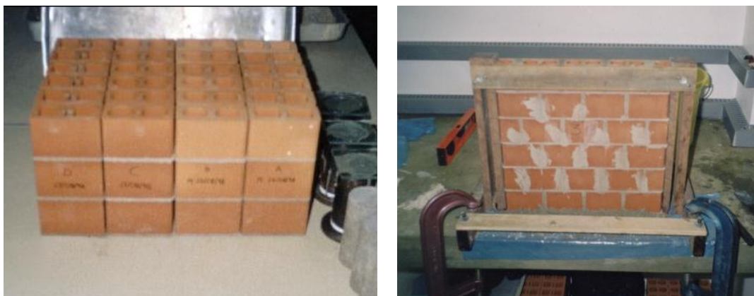
Figura 3. 6 – Corpos-de-prova na escala 1:3 (LIDNER, 2001).
