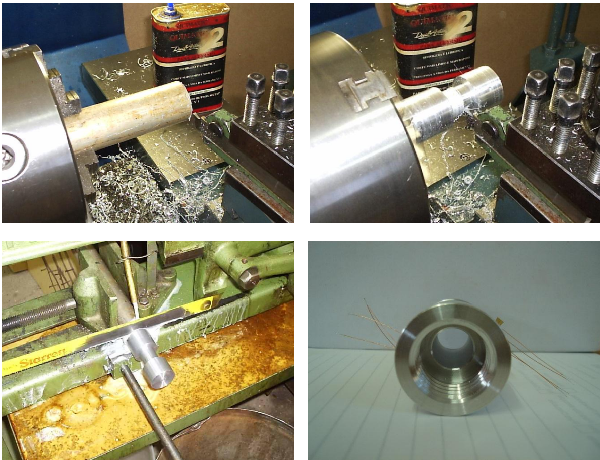
Figura 6. 14 – Detalhes da confecção das células de carga para a instrumentação da base do modelo físico reduzido.
