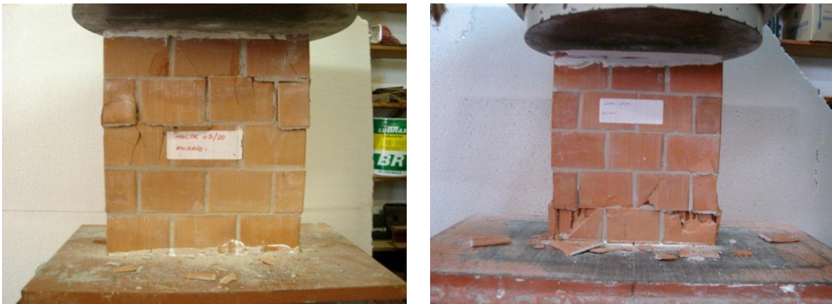
Figura 5. 18 – Forma de ruptura dos painéis PAI3B5F na escala reduzida 1:5.
