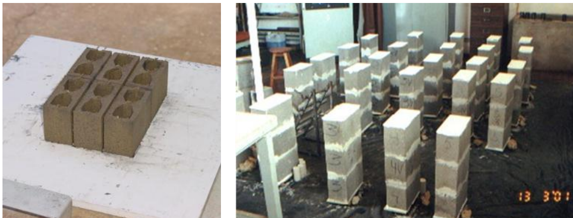
Figura 3. 13 – Blocos de concreto e prismas de três blocos na escala reduzida 1:4 (ANDOLFATO, 2002).
