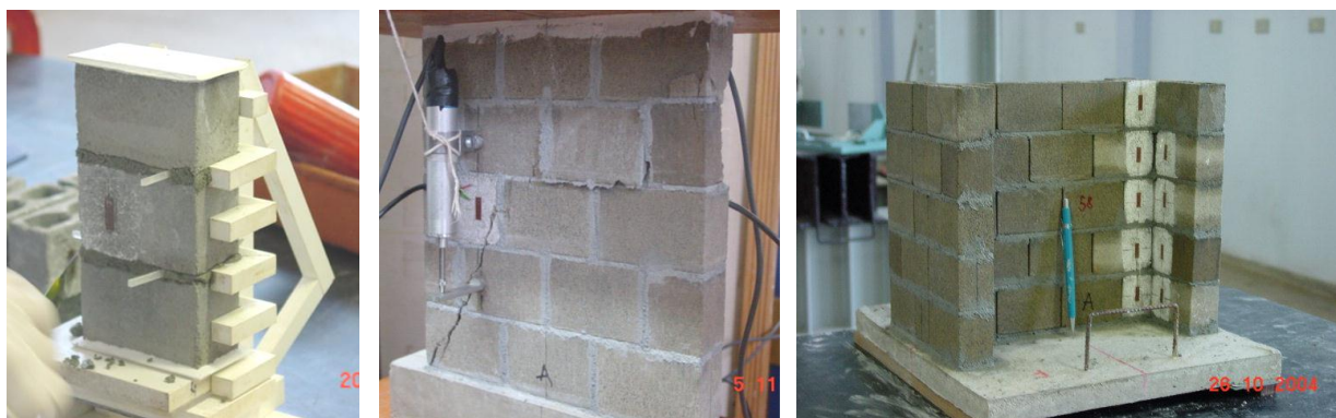
Figura 3.17 – Corpos-de-prova com blocos de concreto na escala reduzida 1:4 (MAURÍCIO, 2005).
