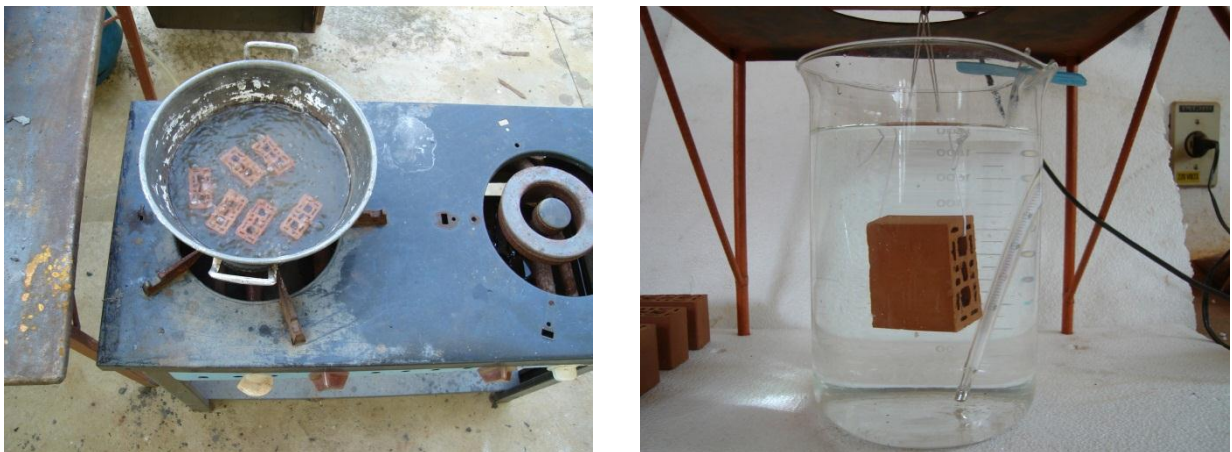
Figura 4. 8 – Detalhes da determinação da área líquida dos blocos cerâmicos na escala reduzida 1:5.
