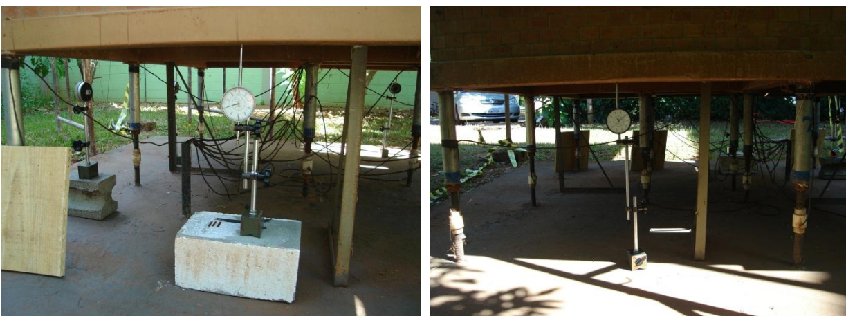
Figura 6. 35 – Instrumentação para verificação do possível surgimento de flechas na grelha de sustentação do modelo físico reduzido.
