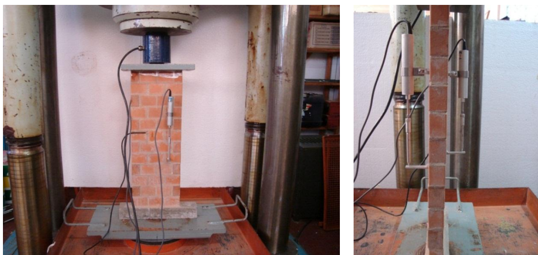
Figura 5. 22 – Detalhes da instrumentação das paredes PAR3B12F na escala reduzida 1:5.
