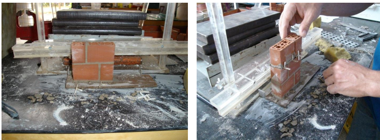
Figura 5.10 – Execução dos prismas PRM3F na escala reduzida 1:5.
