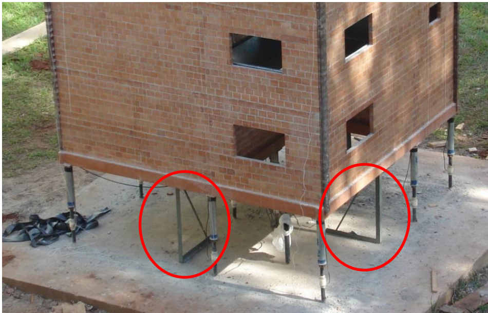
Figura 6. 34 – Detalhes das cantoneiras metálicas na base do modelo físico reduzido.
