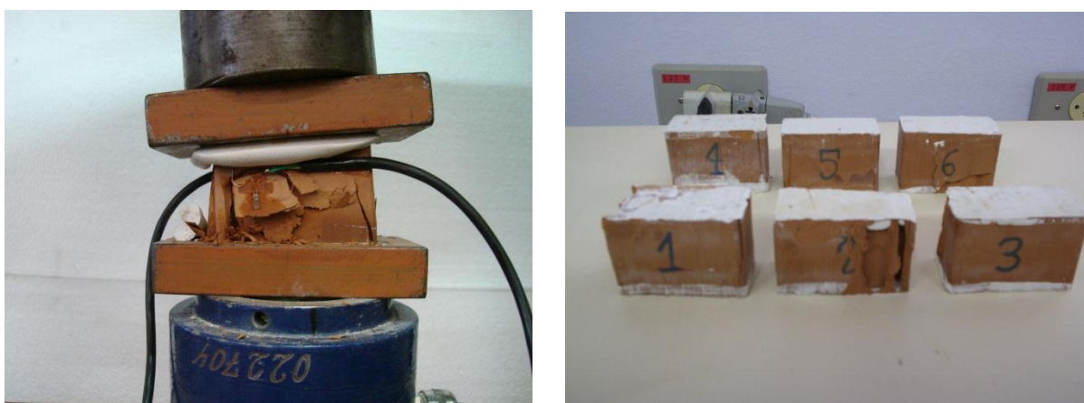
Figura 4. 12 – Forma de ruptura dos blocos cerâmicos na escala reduzida 1:5.
