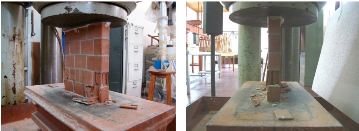
Figura 5. 19 – Detalhes da ruptura dos painéis PAI3B5F na escala reduzida 1:5.
