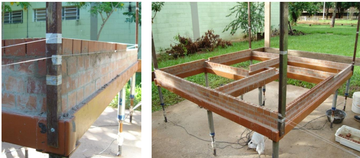
Figura 6. 21 – Detalhes do controle da verticalidade na construção do modelo físico reduzido.
