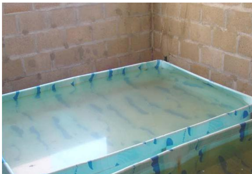
Figura 6. 1 – Forma de aplicação de carregamento uniformemente distribuído utilizado por Andolfato (2006).
