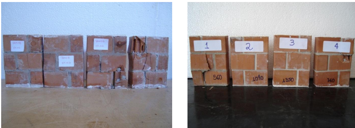
Figura 5. 12 – Forma de ruptura dos prismas contrafiados PRM3F na escala reduzida 1:5.
