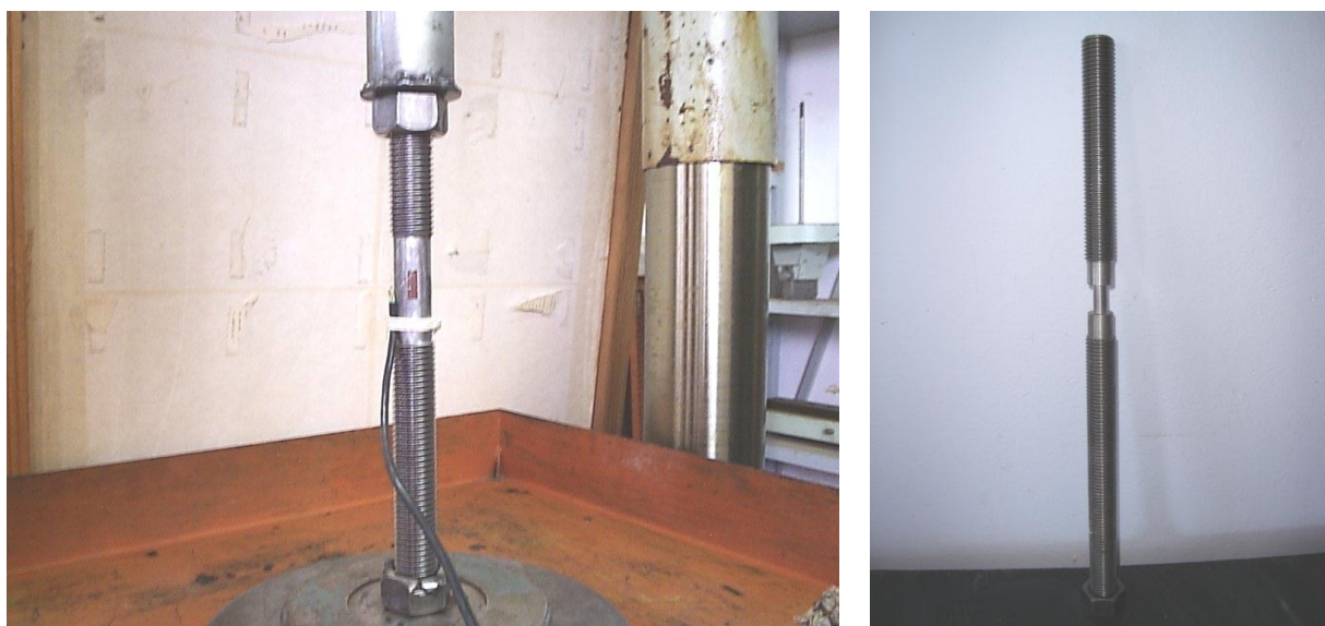
Figura 6.13 – Detalhes da elaboração das primeiras células de carga para a base do modelo físico reduzido.
