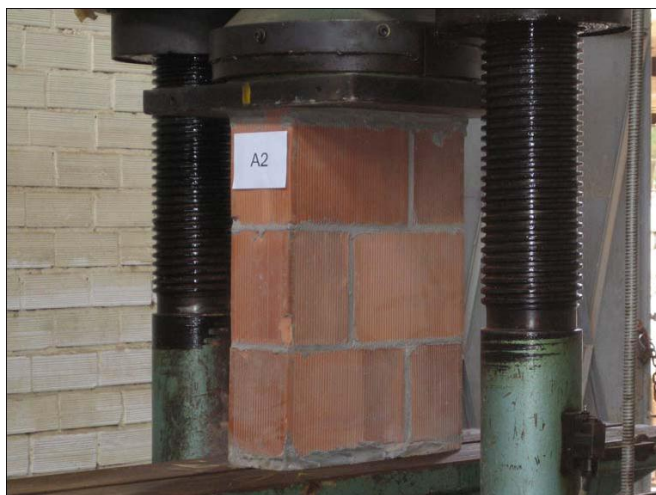
Figura 5. 9 – Modelo de prisma contrafiado PRM3F utilizado por Grohmann (2006).
