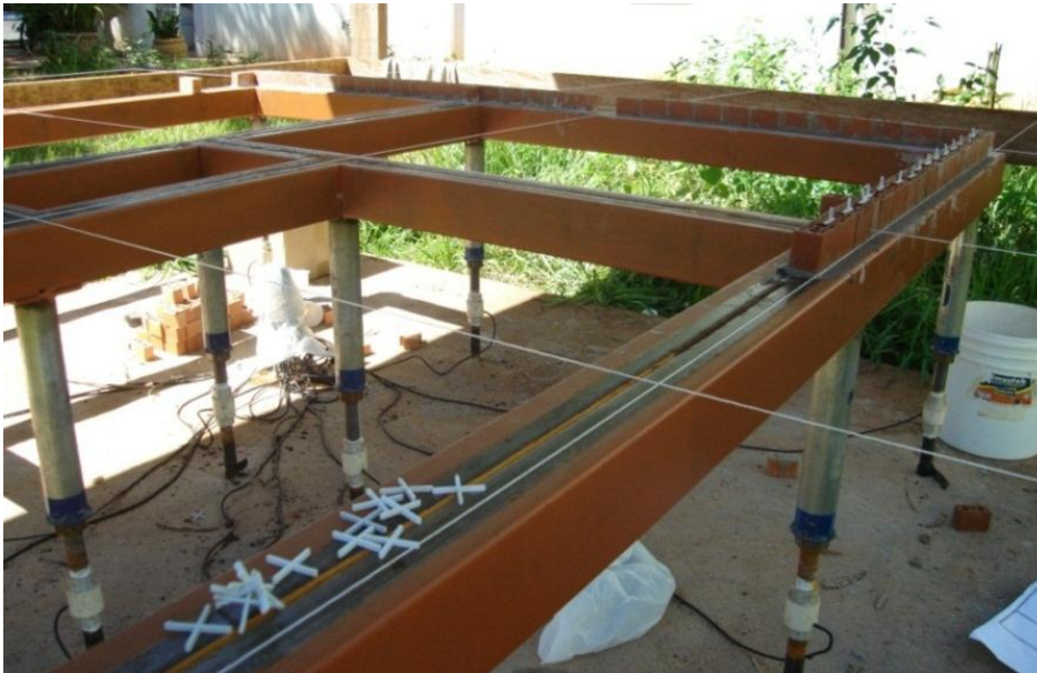
Figura 6. 20 – Detalhes da base de sustentação do modelo físico reduzido
