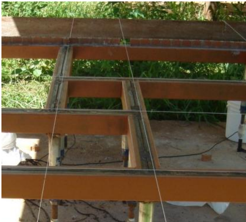
Figura 6. 10 – Detalhes da estrutura metálica de sustentação do modelo físico reduzido.
