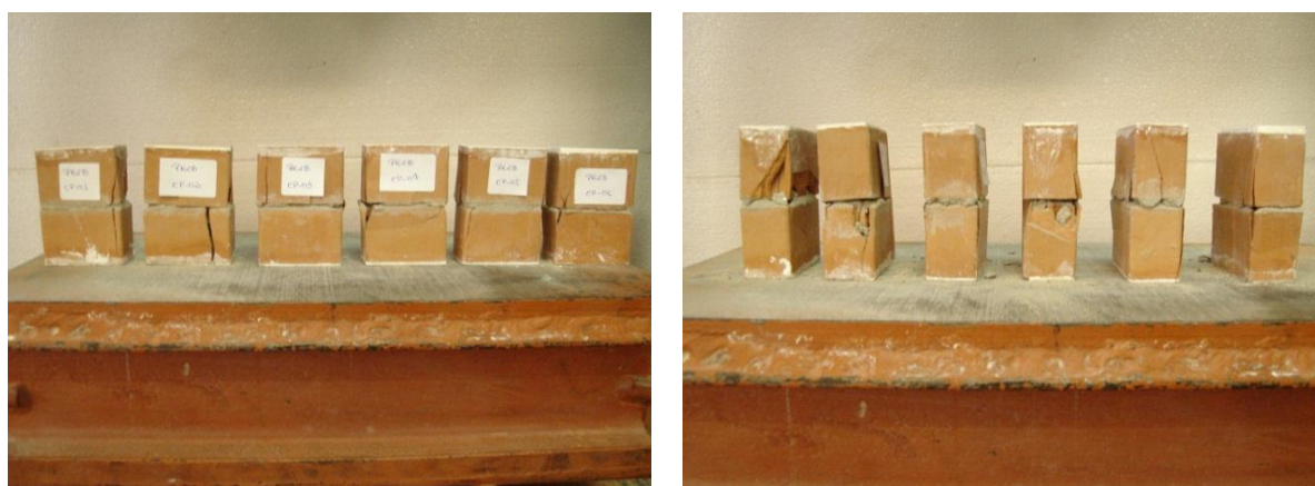
Figura 5. 5 – Forma de ruptura para os prismas PR2B na escala reduzida 1:5.
