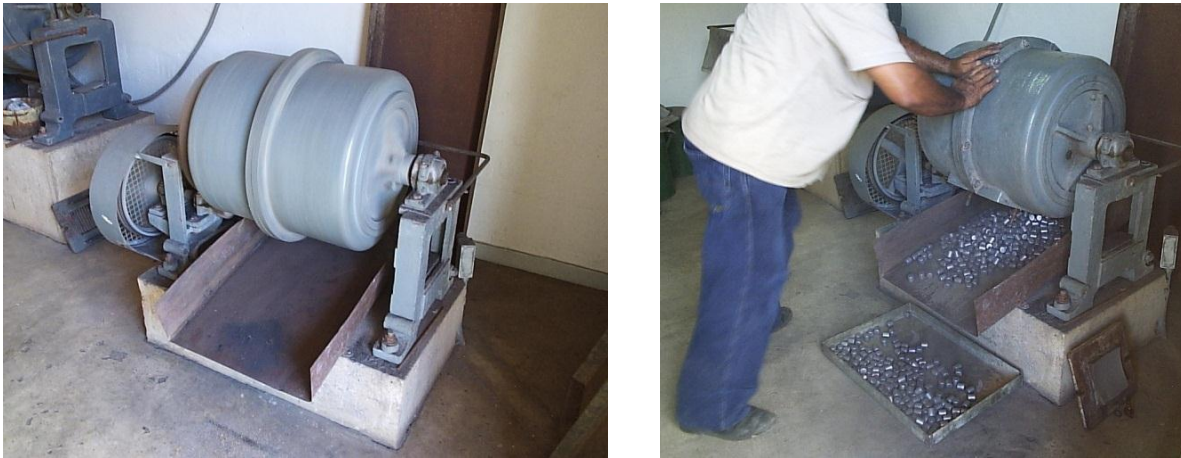
Figura 4. 13 – Detalhes do moinho de agregados miúdos para redução granulométrica da areia.
