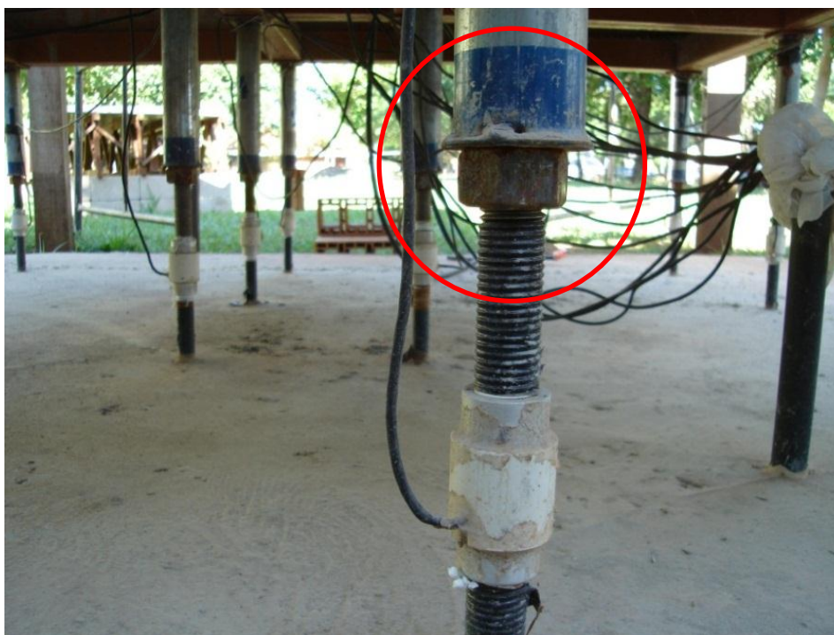
Figura 6. 19 – Detalhes da instrumentação da base no modelo físico reduzido.
