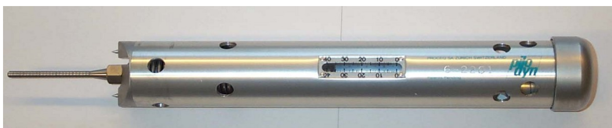
Figura 4.6. O Pilodyn® possui um pino carregado por uma mola, que é impulsionado internamente na superfície da madeira. Em função da profundidade de penetração desse pino, resulta uma medição referente da condição da madeira, RITTER e MORRELL (1990), Foto: ABRAMI et al (2005).
