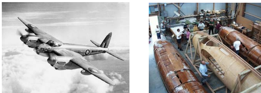
Figura 5.11. Avião Mosquito: primeira estrutura de madeira a ser produzida com peças coladas com adesivos estruturais. Fonte: WARBIRD-NEWS (2014)
