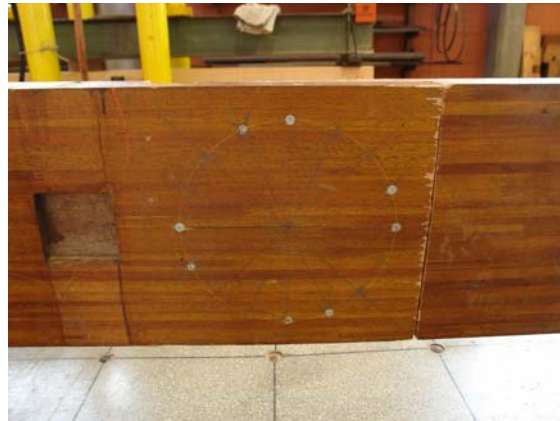
Figura 5.38. Proposta R1-MLC1: Confecção de prótese para viga MLC com ligação momento-resistente Tipo Coroa . Foto: BRITO e CALIL JR. (2014)
