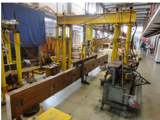
Figura 5.50. Ensaios de flexão estática conforme a distribuição de cargas da ASTM D 198-08: contribuição na proposta de técnica de reabilitação da viga MLC02 com parafusos auto-atarraxantes. Fotos: BRITO
