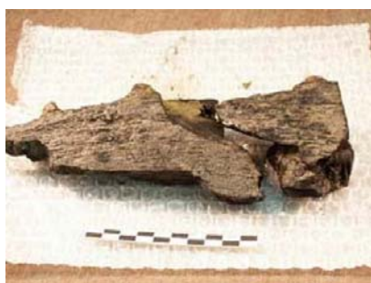
Figura 3.4. Características visuais de fragmentos de madeira biodeteriorada por bactérias. As colorações ouro brilhante evidenciam contaminações por sulfetos de ferro. Fonte: HUISMAN (2005).
