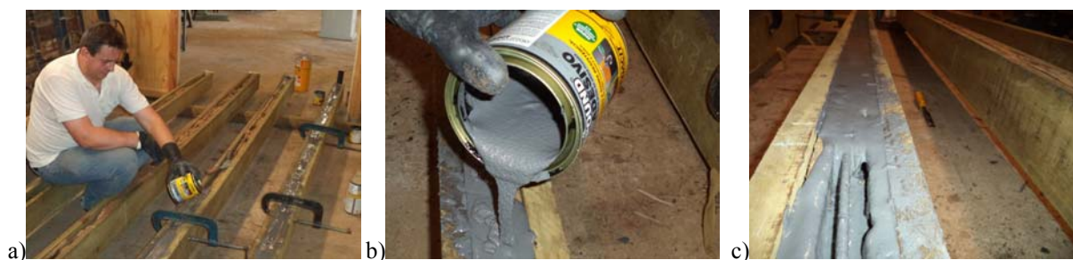
Figura 5.64. Confeção dos corpos-de-prova com reconstituição de região biodeteriorada em zona comprimida de vigas, com aplicação de Compound ® Adesivo com características de argamassa epoxidica estrutural, que proporcionou: a) fácil trabalhabilidade; b) boa fluidez; c) auto-nivelamento. Fotos: BRITO
