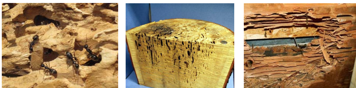
a) Formigas-carpinteiras operárias b) Tronco de árvore deteriorado c) Aspectos visuais Figura 3.43. Características visuais de diagnóstico de galerias e danos provocados por formigas-carpinteiras. Fontes: SCHARF (2007), MARTINS (2009).
