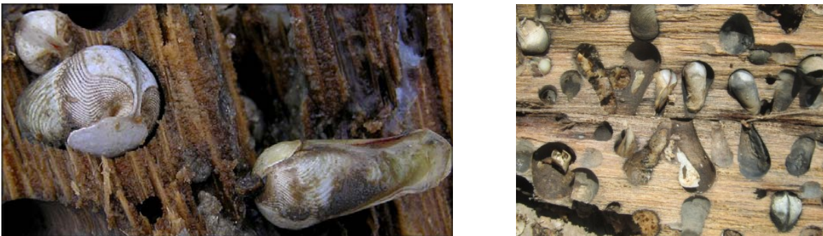
Figura 3.52. Características visuais de diagnóstico de danos madeira interna causada por Pholadidae . Esses perfuradores-marinhos geralmente entocam em camadas na superfície da madeira e são caracterizados por perfurações em forma de pêra, RITTER e MORRELL (1990). Foto: WOOSTER (2009).
