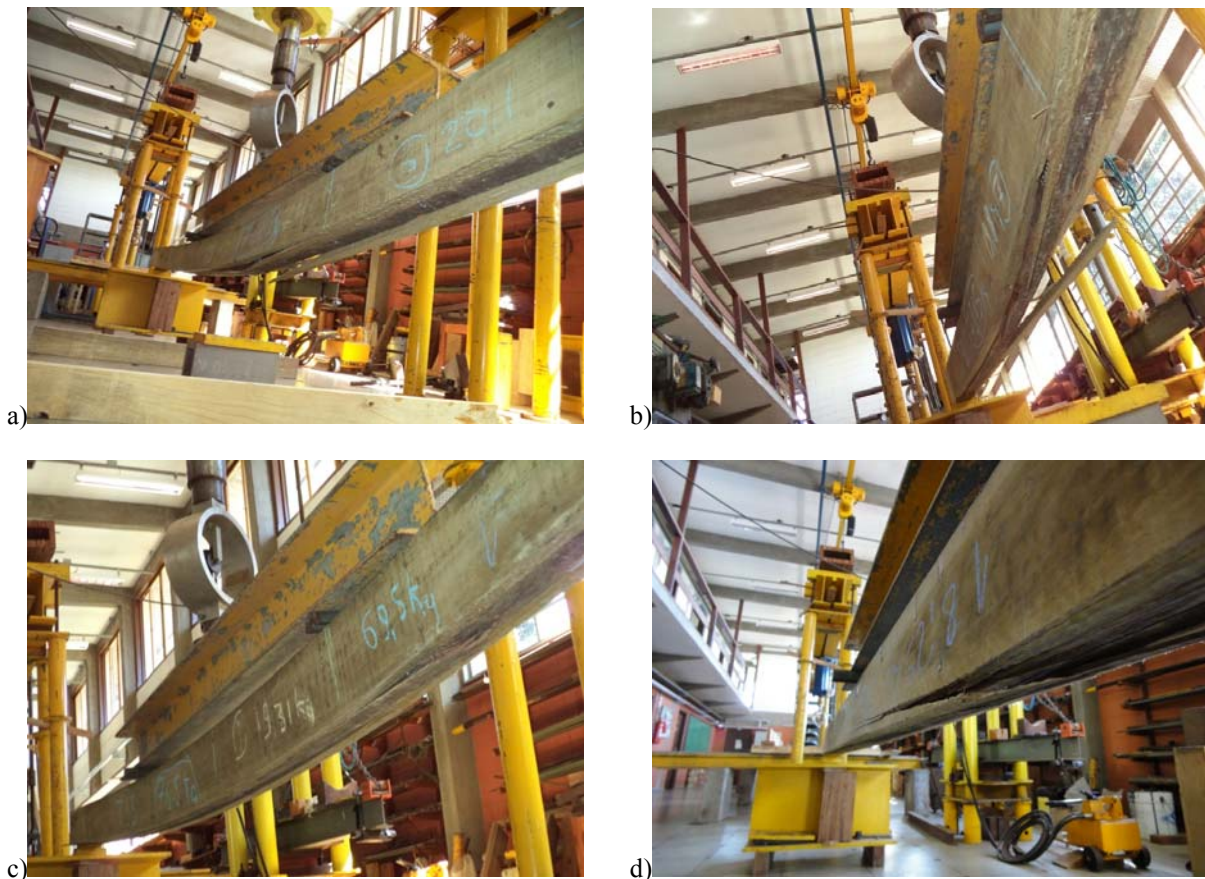
Figura 5.65. Modos de rupturas dúcteis nas vigas reabilitadas pela Proposta R2-CJ2 com cobrejas justapostas pregadas e reconstituídas na região de compressão com Compound® Adesivo estrutural epóxi: a) TS1; b) TS2; c) TS3; d) TS4. Fotos: BRITO
