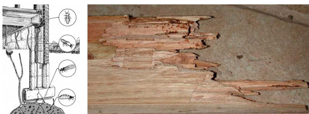
Figura 3.23. Características visuais de diagnóstico de térmitas-subterrâneas: a) esquema geral simplificado do sistema de habitat de colônia de térmitas-subterrâneas, BENNETT (2010). b) características visuais de peça de madeira deteriorada por térmitas-subterrâneas da família Rhinotermitidae coptotermitinae , gênero Coptotermes frenchi , HADLINGTON (1987) apud WALKER (2005).
