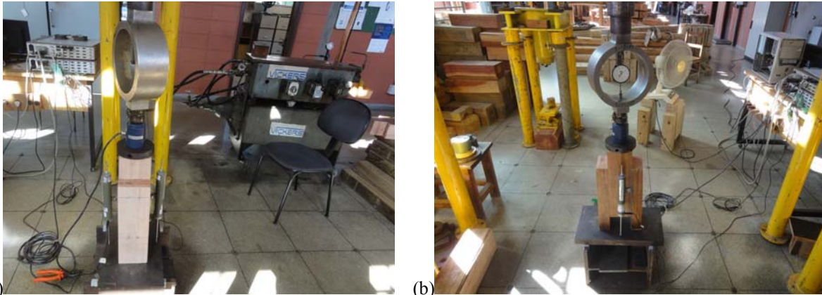
(a) (b) Figura 5.44. Ensaio do Corpo-de-prova CP1-MLC: parafusos na direção normal às fibras. Fotos: BRITO
