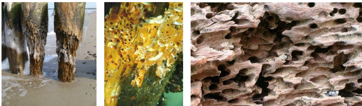
Figura 3.50. Características visuais de diagnóstico de danos internos na madeira causada por teredos. Fontes: IFAÖ (2009), WARREN apud MARTINS (2009).
