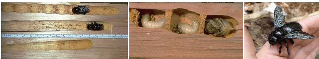
Figura 3.46. Características visuais de diagnóstico de abelhas-carpinteiras: a) os danos por abelhas-carpinteiras em madeira podem ser graves, quando ocorrem infestações. Essas abelhas constroem túneis longos de grandes diâmetros paralelos às fibras para depositar seus ovos, e podem resultar em perdas significativas de área de seção transversal; b) larvas e pupa, KAAE (2013); c) abelha-carpinteira adulta, MARTINS (2009).
