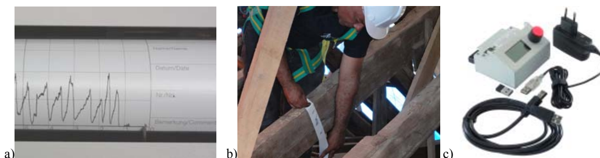
Figura 4.32. Registros analógicos e digitais dos perfis de sondagens gerados pelo Resistograph® IML-RESI-F500-S: a) no perfil em papel especial tipo carbono para impressão do diagrama gerado pelo Resistograph in loco ; b) Comparação do diagrama do perfil de sondagem na face externa da viga deteriorada, (Foto BRITO, 2012); c) Microcomputador de bordo acoplado ao Resistograph, e os dados podem ser posteriormente transferidos via USB ou Bluetooth para Notebook. Fonte: BRITO e CALIL JR. (2013)b
