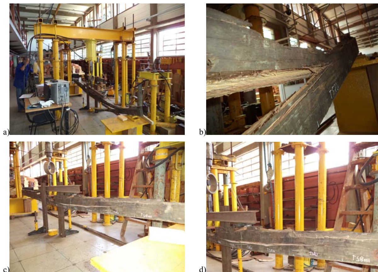
Figura 5.54. Ensaios de flexão de vigas transversinas parcialmente biodeterioradas na região superior de compressão (foram notáveis à separação longitudinal, paralela às fibras da região de madeira sã da região da madeira biodeteriorada): a) Visão do Modo de Ruptura Brusca, sem aviso, na viga TS7, com visão detalhada em b); c) Modo de ruptura por cisalhamento na viga TS8 (visão detalhada em (d)). Fotos: BRITO
