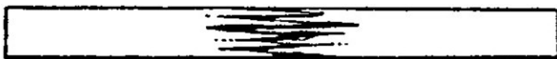
c) Ruptura por tração em lascas [ingl.: Splintering Tension] comum em madeiras duras (Vista da tensão superficial).
