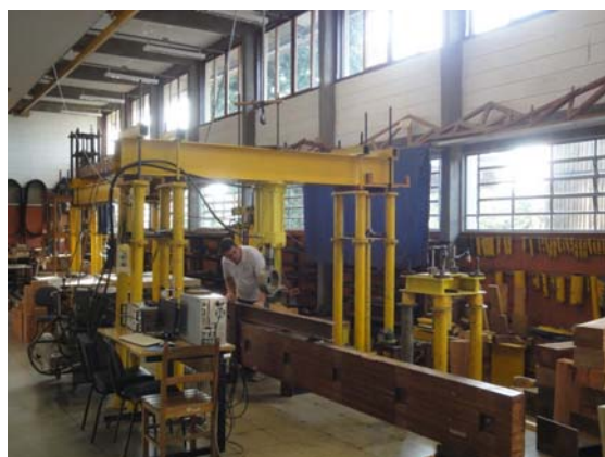
Figura 5.50. Ensaios de flexão estática conforme a distribuição de cargas da ASTM D 198-08: contribuição na proposta de técnica de reabilitação da viga MLC02 com parafusos auto-atarraxantes. Fotos: BRITO
