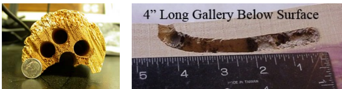
Figura 3.45. Características visuais de Orifícios de abelhas-carpinteira e aberturas de galerias (Túneis) paralelas às fibras produzidas por ataque abelhas-carpinteiras, ATM (2010).
