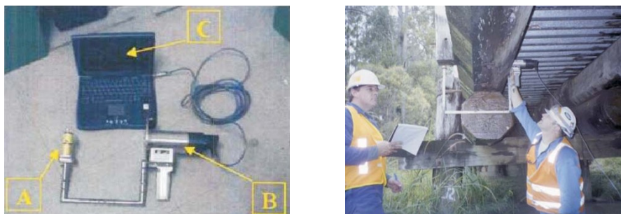
Figura 4.14. Sistema de Inspeção Lixi Profiler : consiste de um isótopo (A), um canal (MCP) de placa de aquisição de dados para detector de micro (B), um microcomputador portátil (C) com sistema operacional MS Windows e software do equipamento (Intico Pty Ltd). Fonte: GRAHAM (2005)
