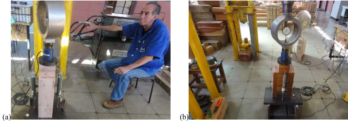
Figura 5.47. Ensaio do Corpo-de-prova CP2-MLC: parafusos na direção paralela às fibras. Fotos: BRITO
