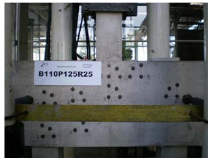
B - Detalhe dos extensômetros mecânicos no modelo durante o ensaio
