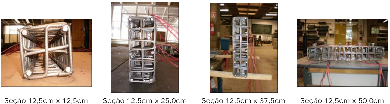
Figura 3.15 – Detalhe das armaduras de fretagem de pilares
