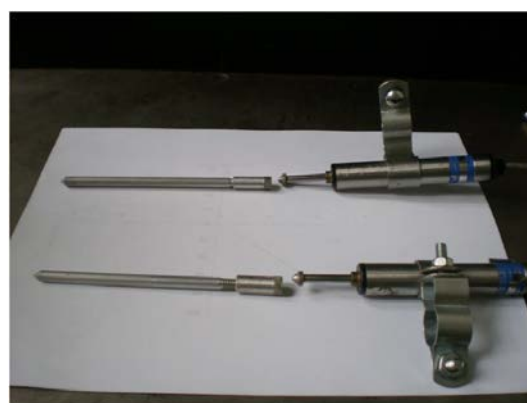
B - Detalhes dos transdutores e haste adicional
