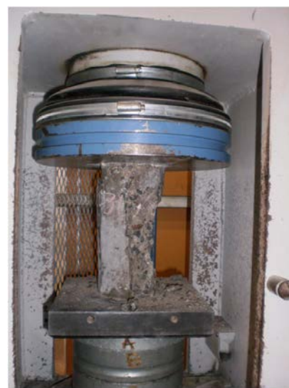
CP de estacas após rompimento
