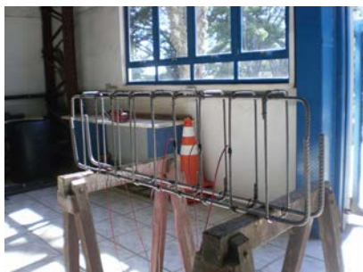
Figura 3.17 - Montagem das armaduras de blocos da série B110 e B115
