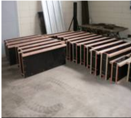
Fôrmas dos blocos
