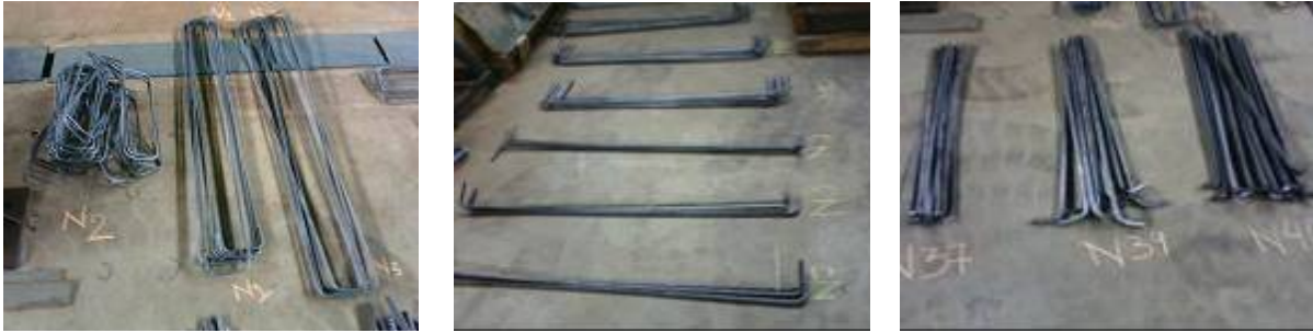
Figura 3.10 – Barras de aço para montagem da armadura dos modelos
