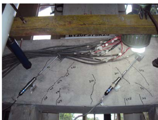
A - Modelo com os transdutores durante ensaio
