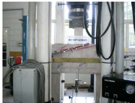
Transdutor TD1 (base), transdutores TD6 e TD7 (face)
