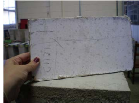
Figura 3.44 – Detalhe da placa de gesso utilizada sobre os pilares durante o ensaio
