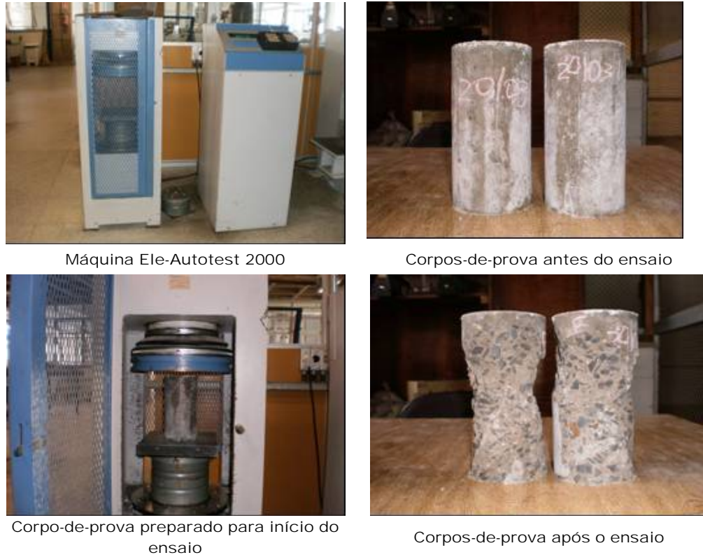
Figura 3.9 – Ensaio para determinação da resistência à compressão
