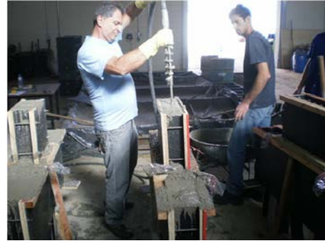
Detalhe do vibrador
