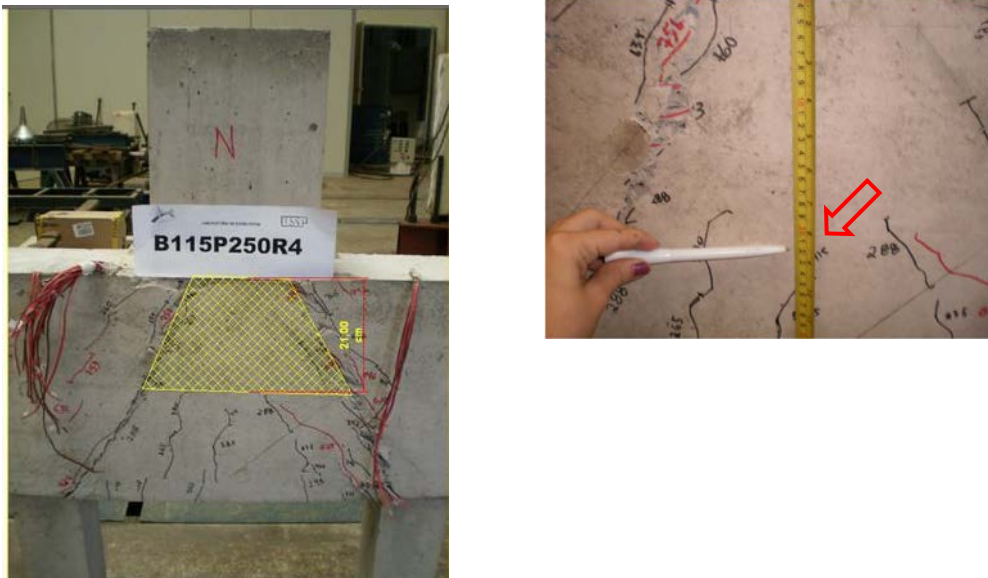
Figura 4.37 – Região nodal pilar do modelo B115P250R4
