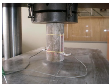
Extensômetro de base 100 mm
