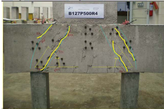
Figura 4.79 – Formação da biela experimental B127P500R4
