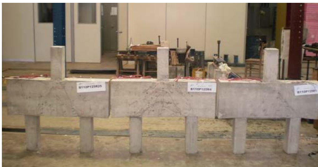
Figura 4.20 – Modelos da série B110 após ensaios
