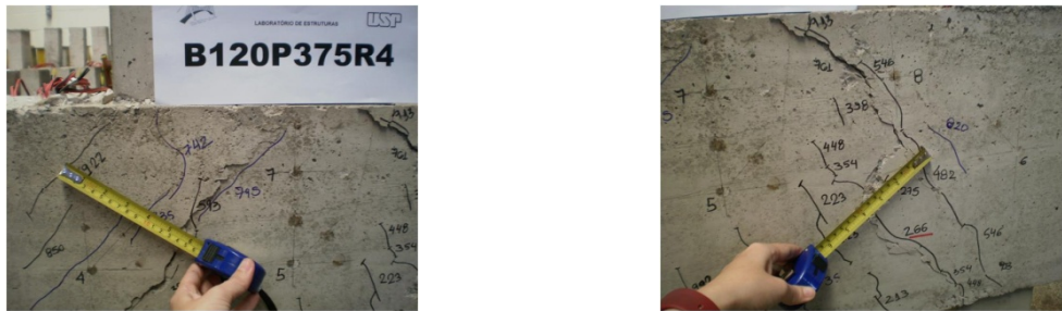
Figura 4.59 – Largura da biela B120P375R4 (face sul)
