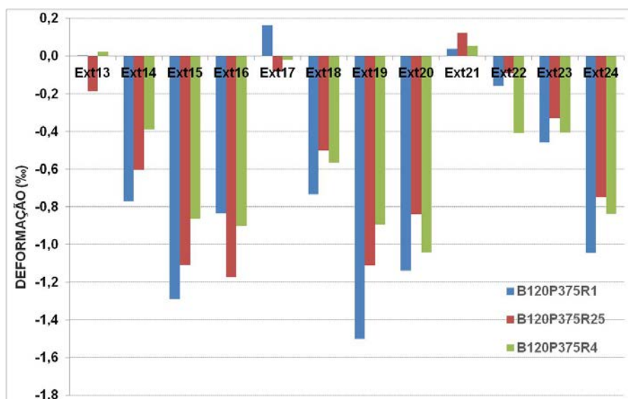
Figura 4.137 – Deformações máximas nas barras dos pilares dos modelos da série B120
