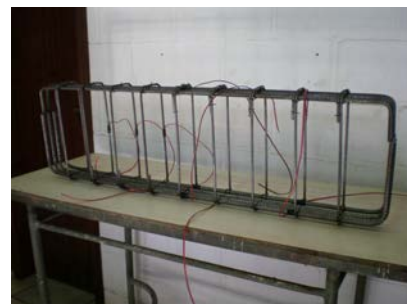
Figura 3.17 - Montagem das armaduras de blocos da série B110 e B115
