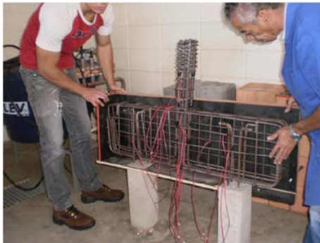
Posicionamento da armadura
