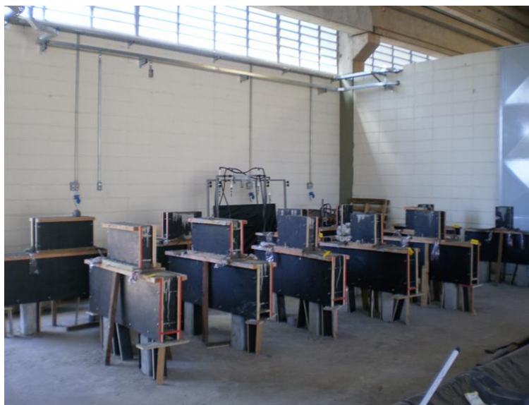
Figura 3.33 – Vista geral do modelos de blocos sobre estacas após a concretagem
