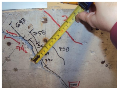
Figura 4.39 – Medidas da biela experimental do modelo B115P250R4
