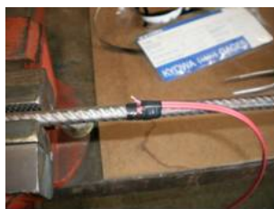
Extensômetro e fio prontos para soldagem
