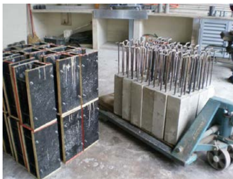
Figura 3.25 – Estacas sem as fôrmas
