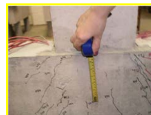
Altura região nodal pilar (face norte)
