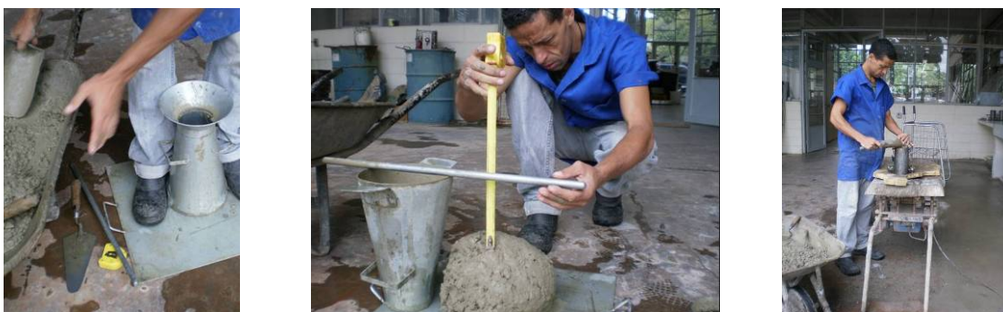
Realização do teste de abatimento de cone (slump)
