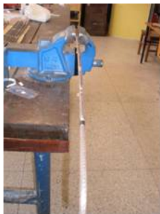
Barra de pilar com 3 pontos de extensômetros
