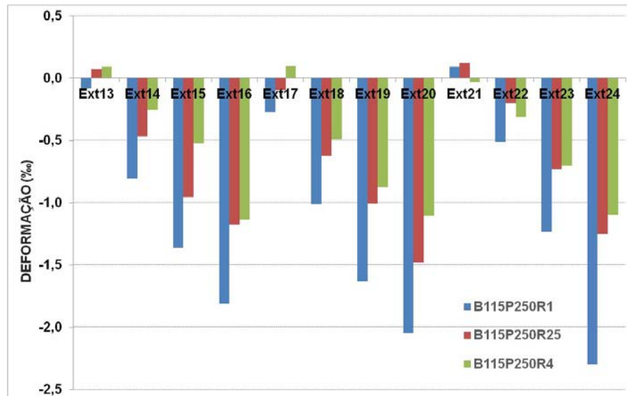
Figura 4.132 – Deformações máximas nas barras dos pilares dos modelos da série B115
