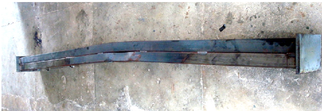
Figura 4.29: Configuração deformada do perfil caixão após o ensaio termoestrutural.
