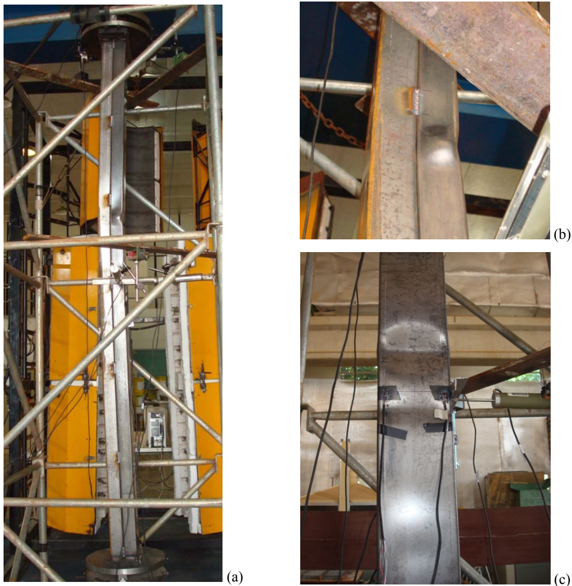
Figura 4.14: Configuração deformada do perfil caixão (a) deslocamento lateral, (b) modo de falha local na mesa e (c) falha local na alma.
