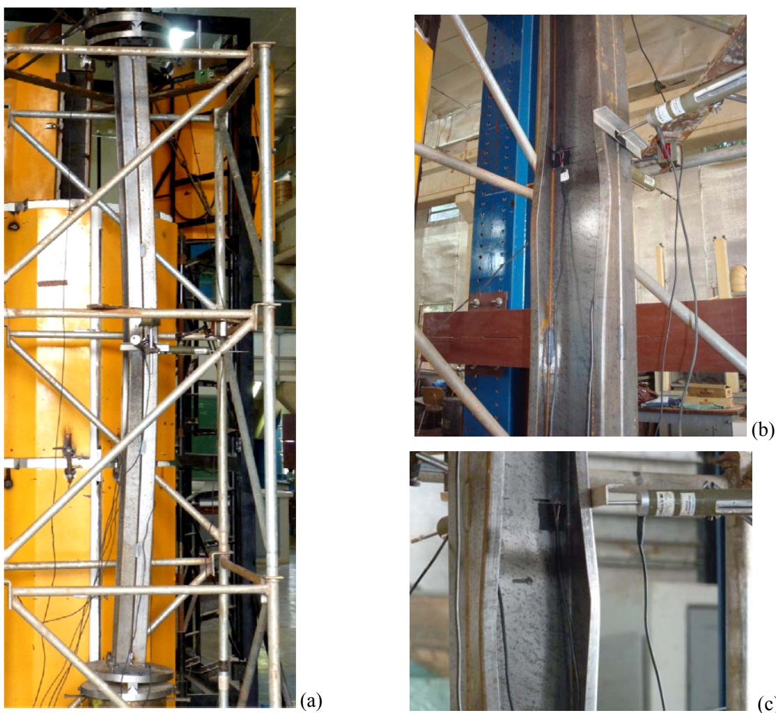
Figura 4.13: Configuração deformada do perfil I enrijecido: (a) modo de falha por flexão, (b) modo de falha local na alma e distorcional e (c) detalhe da perda de estabilidade nos elementos da seção transversal.
