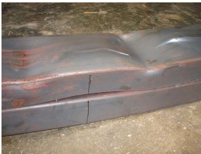
Figura 4.40: Detalhe da falha local na alma e na mesa, bem como o distorcional no conjunto mesa enrijecedor.
