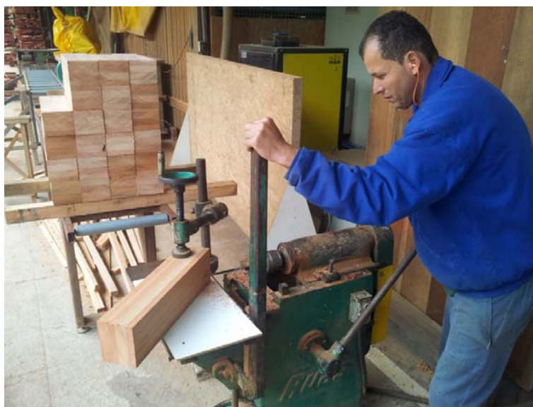
Figura 66 – Pré-furação corpo de prova de Lyptus.
