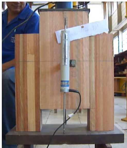
Figura 73 – Corpo de Prova de Lyptus a 90°
