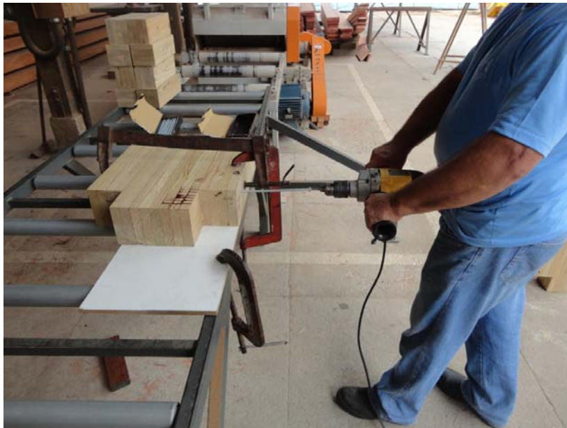
Figura 65 – Confecção dos corpos de prova de Pinus.
