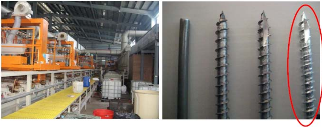
Figura 35 – Processo de Zincagem (Rothoblass 2012)
