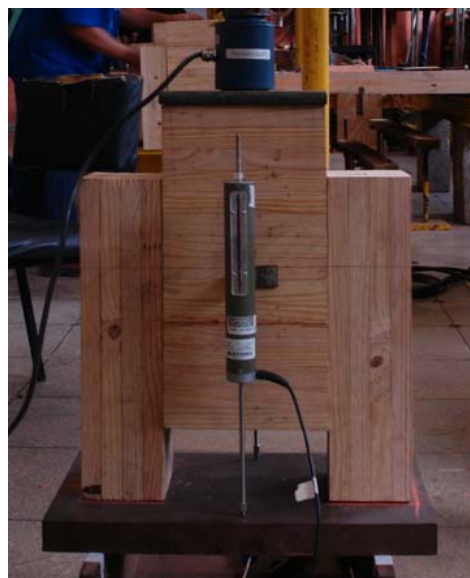
Figura 95 – Corpo de Prova de Pinus a 45°.
