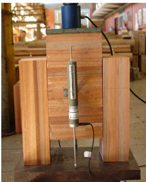
Figura 91 – Corpo de Prova de Lyptus a 45°.
