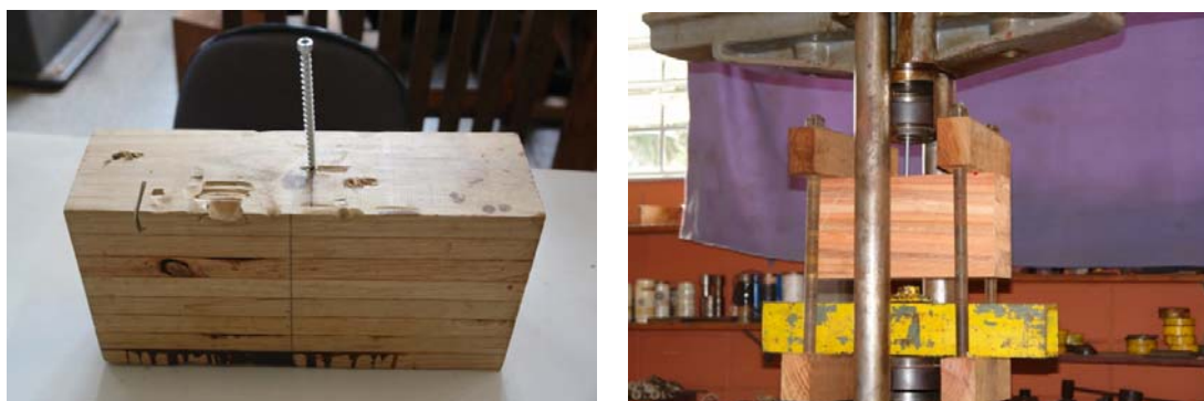
Figura 104 – Ensaio de arrancamento de parafuso.
