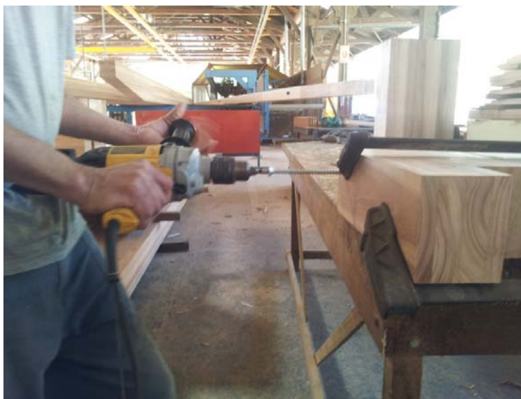
Figura 67 – Confeção dos corpos de prova de Lyptus.
