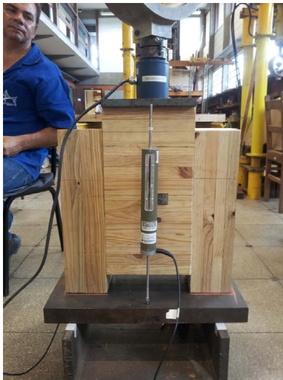
Figura 85 – Corpo de Prova de Pinus a 90°.
