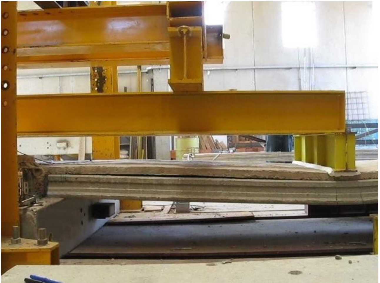
Figura 5.55 – Vista lateral da laje da direita modelo 3 (EM3) quando a força foi aplicada pela segunda vez. Foto tirada do lado de referência.
