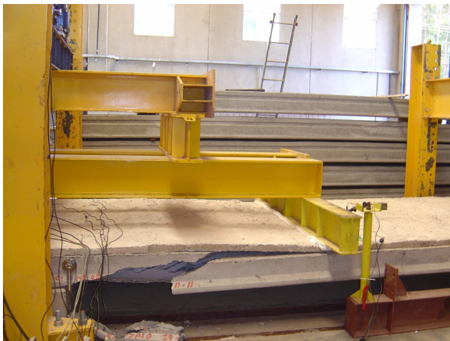
Figura 5.22 – Vista lateral da laje que sofreu ruptura no EM1. Laje da direita com relação ao lado de referência. Foto tirada no lado de referência.
