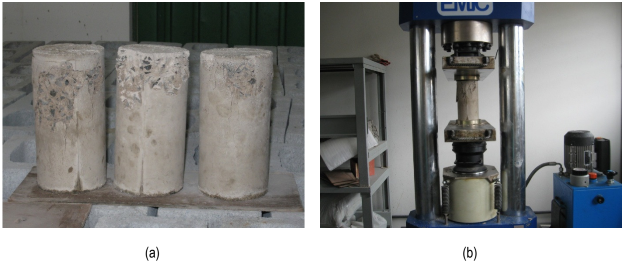
Figura 4.30 – Ensaio de resistência à compressão do concreto da capa. (a) Três corpos de prova ensaiados para cada modelo; (b) Prensa servo-hidráulica utilizada (LSE/UFSCar).
