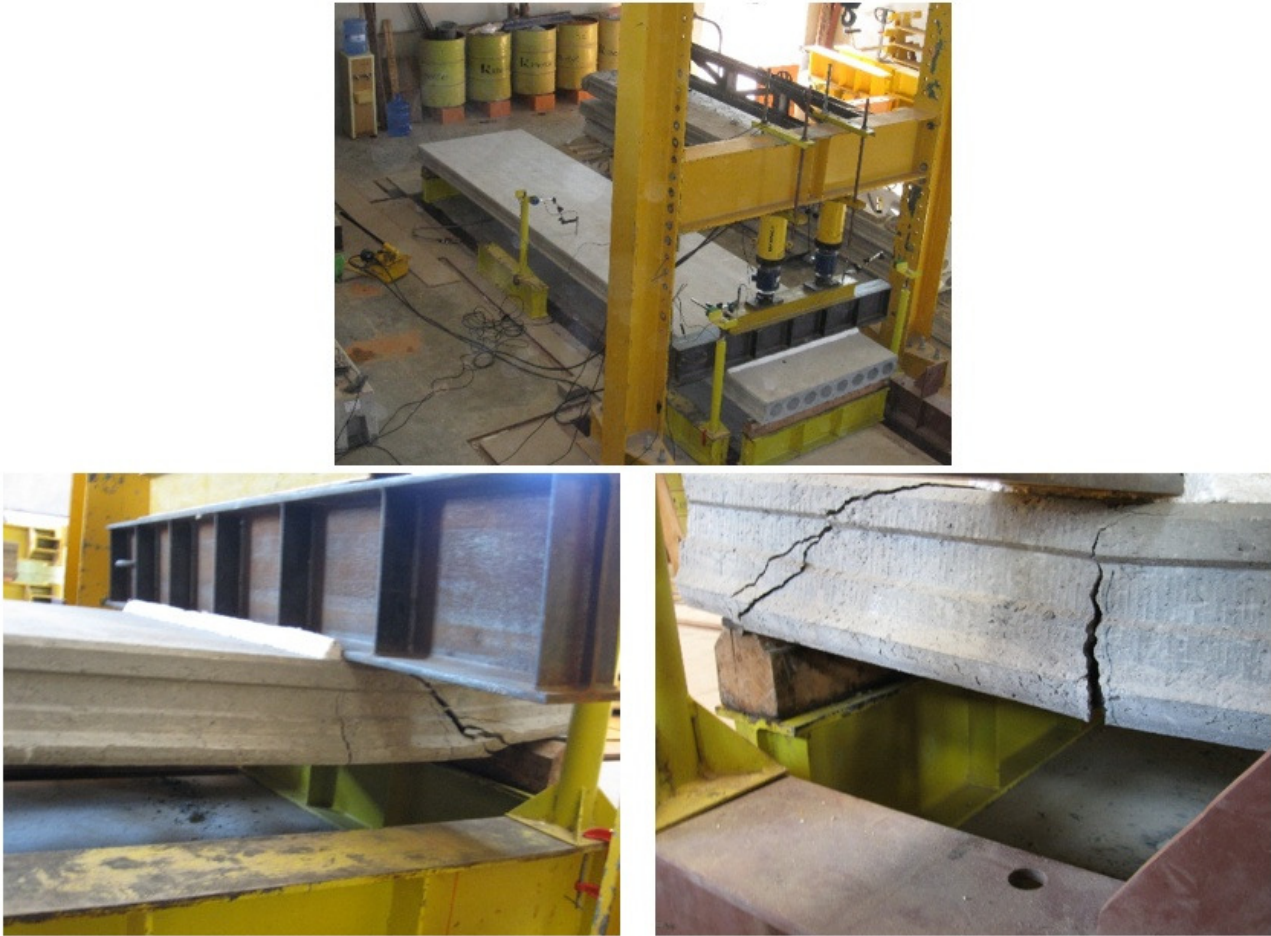
Figura 8.15 – Ruptura por flexo-cortante (ensaios de caracterização da laje EM3-L4-A).
