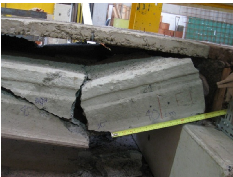
Figura 5.41 – Vista lateral de EM2 após a ruptura, mostrando a inclinação das fissuras. Com relação à face inferior da laje, a fissura começa com 30^\circ e depois altera para 45^\circ até atingir a interface laje-capas. Foto tirada do lado de referência.
