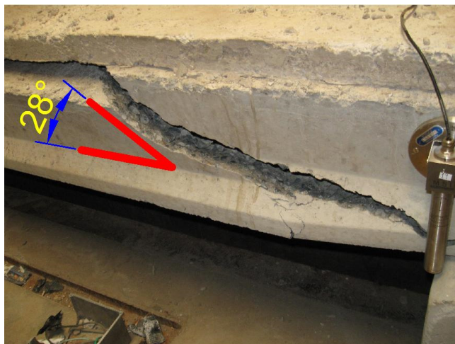
Figura 5.25 – Inclinação das fissuras diagonais decorrentes das solicitações tangenciais para a ruptura de EM1. Foto tirada no lado oposto.
