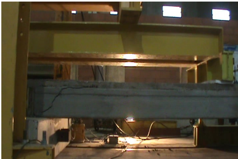
Figura 5.40 – Vista lateral de EM2 no instante da ruptura. Laje da esquerda com relação ao lado de referência. Foto tirada do lado oposto.
