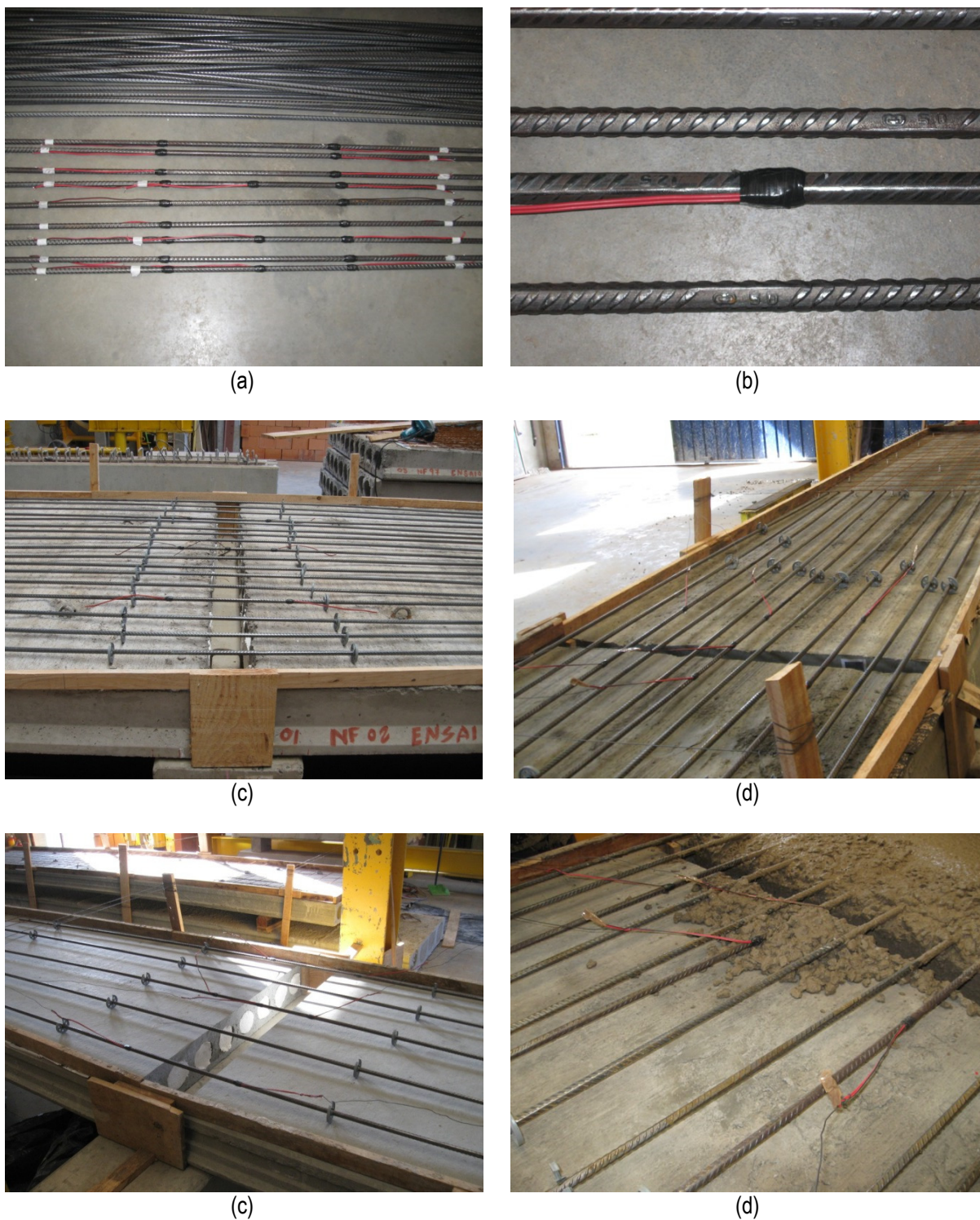
Figura 5.16 – Pontos de instrumentação (extensômetros): (a) Nove barras após a colagem dos extensômetros; (b) Visão aproximada de um extensômetro colado em uma barra; (c) Posicionamento das barras e dos extensômetros no EM1; (d) Posicionamento das barras e dos extensômetros no EM2; (e) Posicionamento das barras e dos extensômetros no EM3; (f) Concretagem da capa na região do apoio intermediário.
