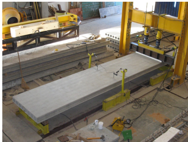
Figura 4.23 – Foto do ensaio de cisalhamento da laje EM3-L4-A.
