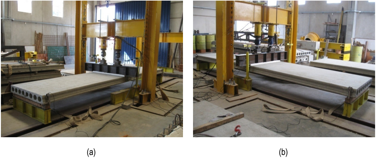
Figura 4.21 – Fotos dos ensaios de caracterização de lajes sem capa. (a) EM3-L2; (b) EM3-L3.
