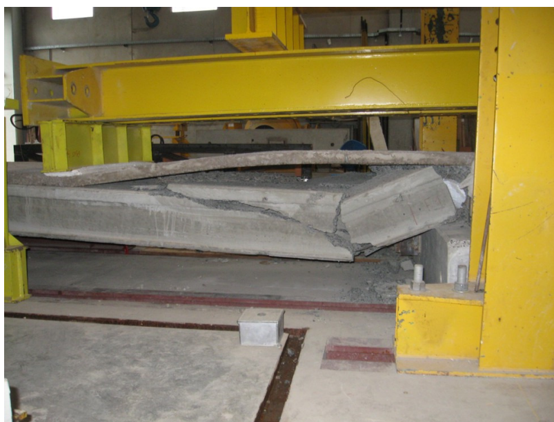
Figura 5.37 – Vista lateral da laje que sofreu ruptura no EM2. Laje da esquerda com relação ao lado de referência. Foto tirada no lado de referência.
