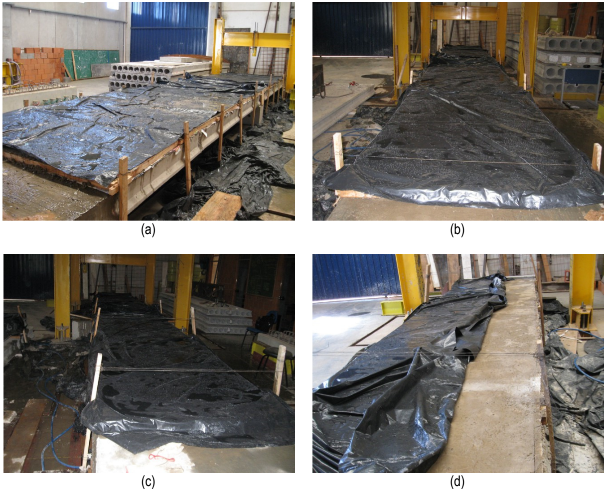
Figura 5.11 – Cura dos modelos: (a) EM1; (b) EM2; (c) EM3; (d) Superfície se manteve úmida com o passar de um dia após a molhagem.
