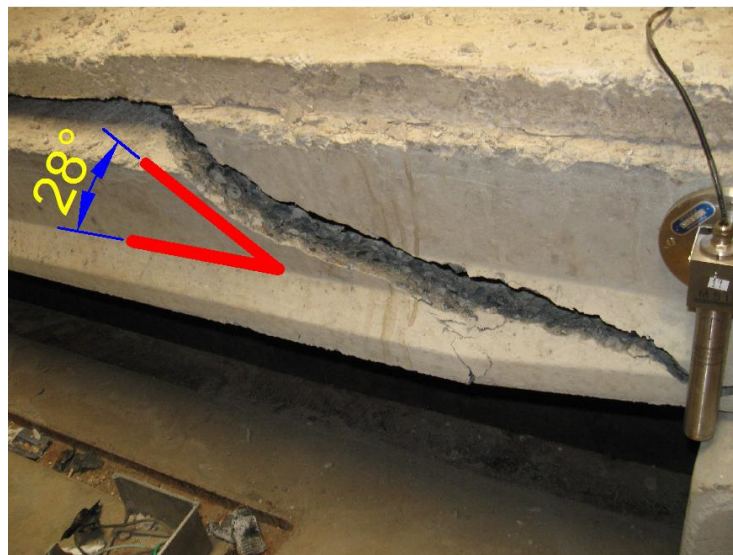
Figura 5.25 – Ruptura por tração diagonal do EM1. Seção composta.
