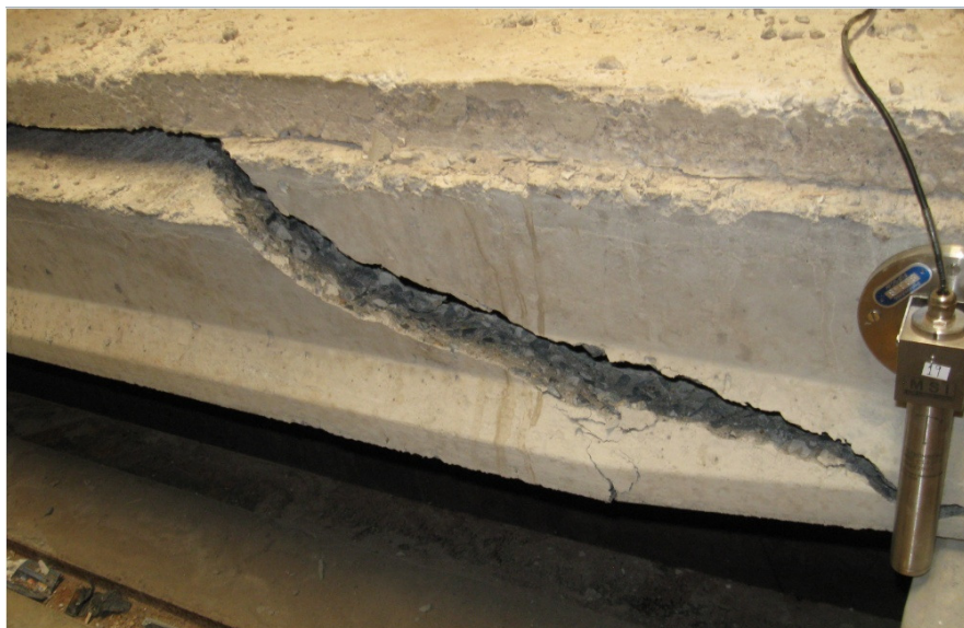
Figura 8.17 – Ruptura por tração diagonal (ensaio de continuidade de EM1).
