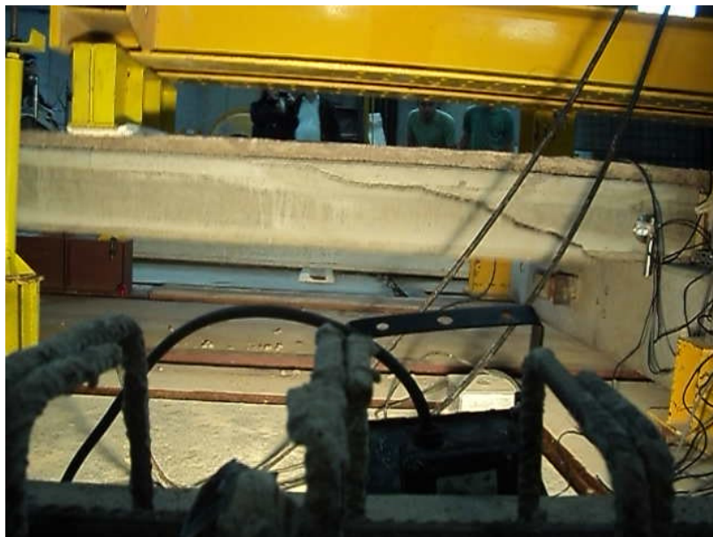
Figura 5.39 – Vista lateral de EM2 no instante da ruptura. Laje da esquerda com relação ao lado de referência. Foto tirada do lado de referência.
