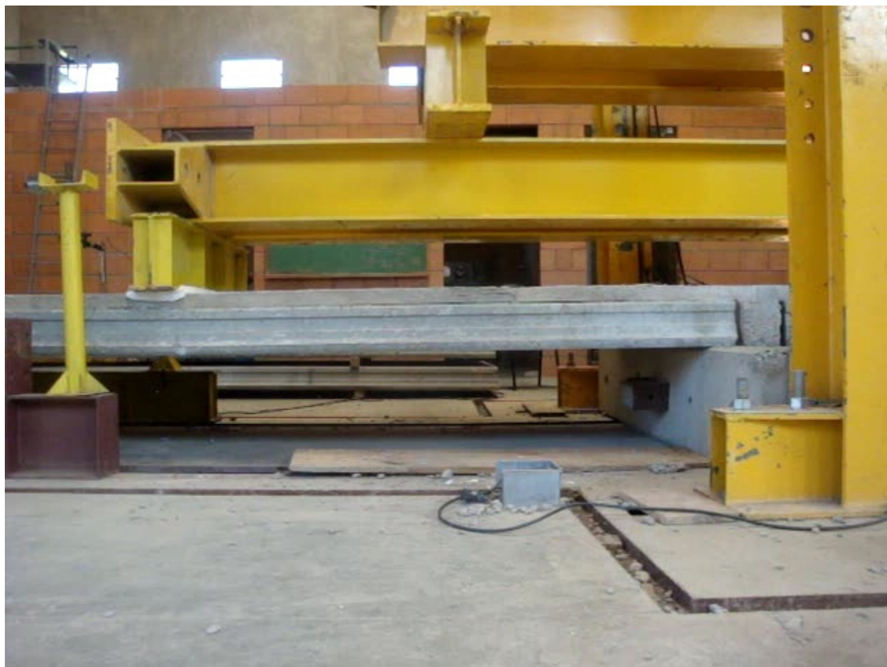
Figura 5.54 – Vista lateral da laje da direita modelo 3 (EM3) no instante da ruptura por flexão. Foto tirada do lado oposto.
