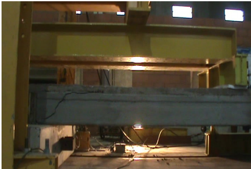
Figura 5.40 – Ruptura por tração diagonal do EM2. Seção simples.
