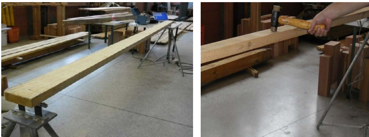
Figura 3.10 - Esquema do ensaio de vibração transversal
