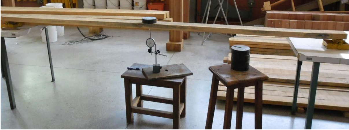
Figura 3.9 - Esquema do ensaio de flexão estática.
