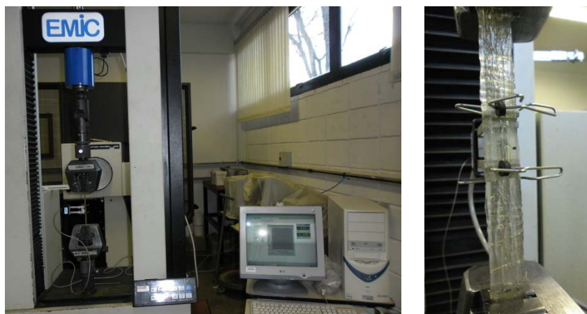
Figura 3.8 - Máquina universal de ensaio EMIC e detalhe do clip-gage com o corpo de prova com fibra de vidro.
