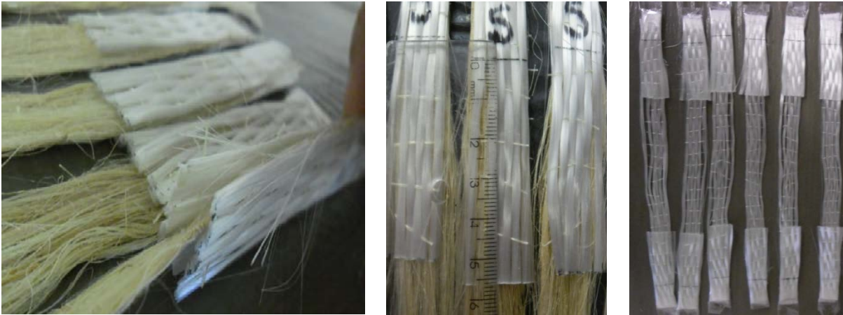
Figura 3.4 - União das abas nos extremos dos corpos de prova com fita adesiva.
