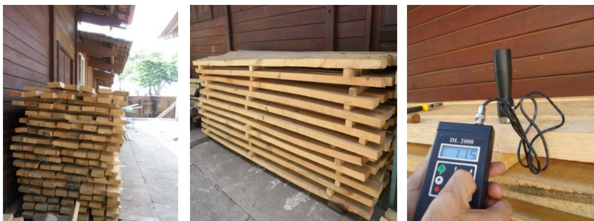
Figura 3.2 - Empilhamento para secagem ao ar da madeira Pinus sp e controle da umidade.
