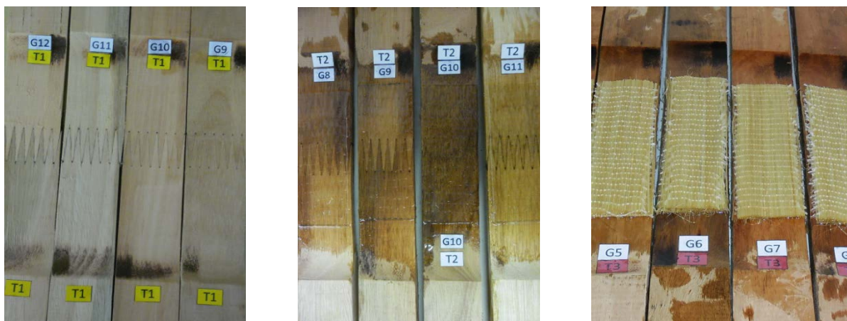
Figura 3.19 - Corpos de prova isentos de defeitos sem reforço e com reforço de fibra de vidro e de sisal.
