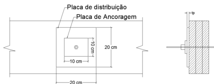
Figura 5 - Sistema de ancoragem utilizado na ponte do rio Monjolinho.
