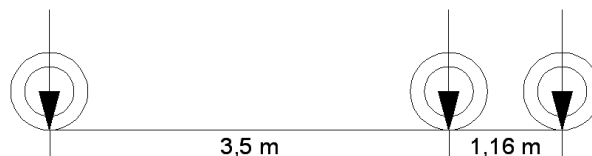
Figura 37 - Esquema estático utilizado nas análises.
