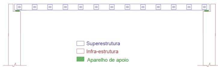
Figura 10 - Principais elementos das pontes protendidas (Fonte: FONTE 2004).
