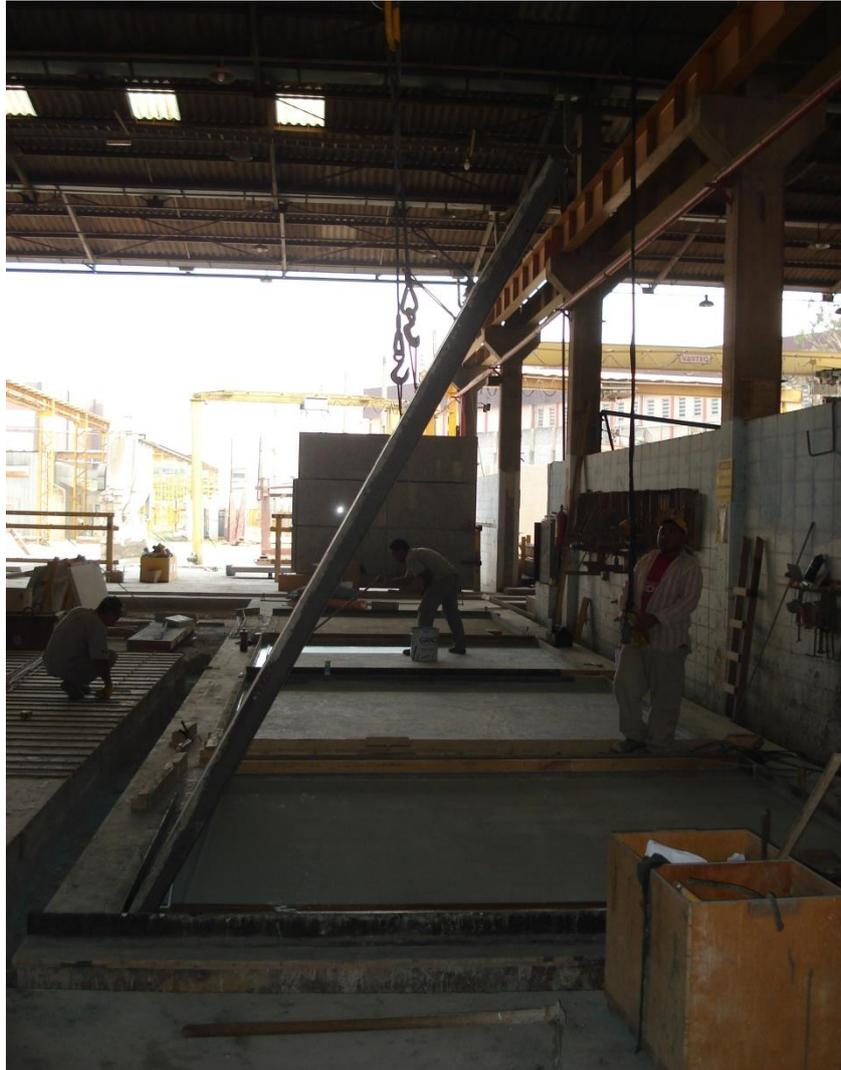
Figura 2.10 – Desforma de painel por rotação sobre uma borda (Fonte: arquivo pessoal)
