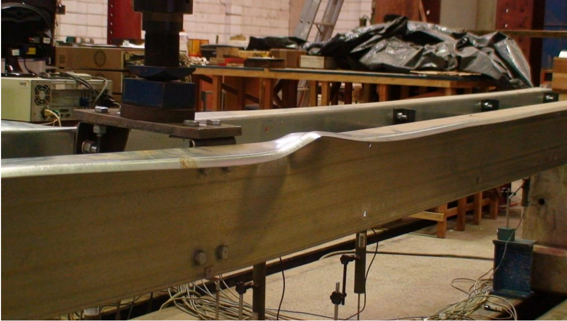
Foto 12 - Detalhe do modo de falha do protótipo Z2-C (modo distorcional).
