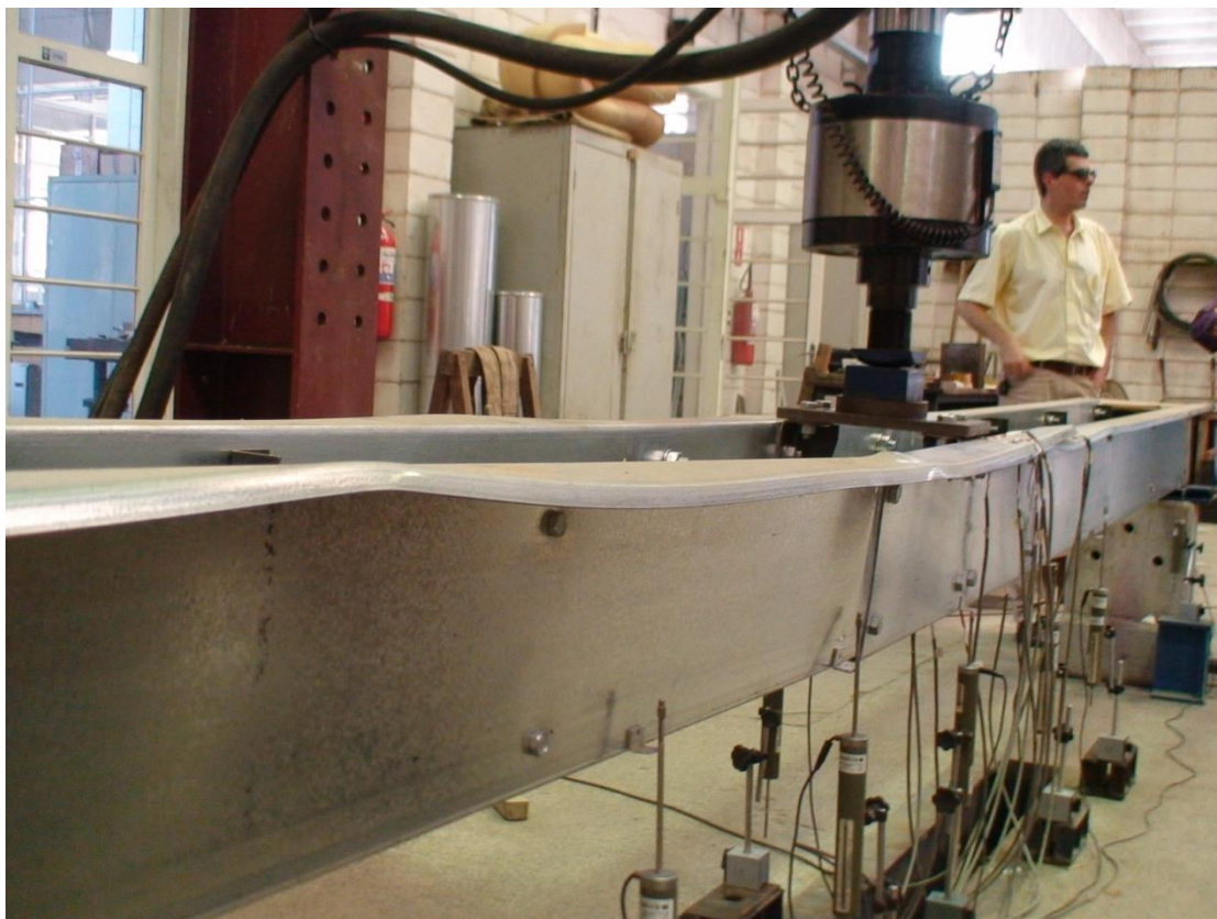
Foto 14 - Detalhe do modo de falha do protótipo Z2-T5 (modo distorcional-local).
