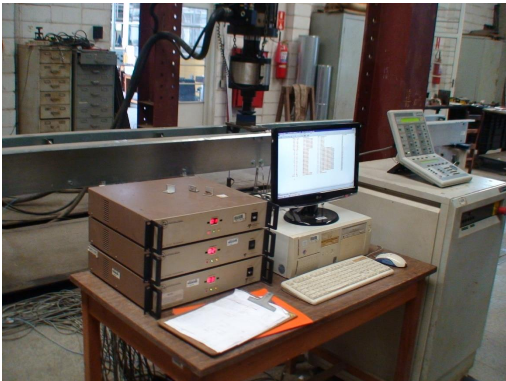
Foto 3 – Detalhe do sistema de aquisição dos dados.
