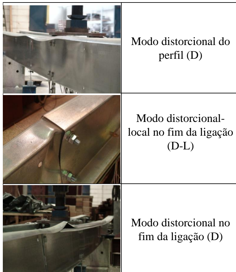
Figura 19 - Modos de falha observados nos ensaios.
