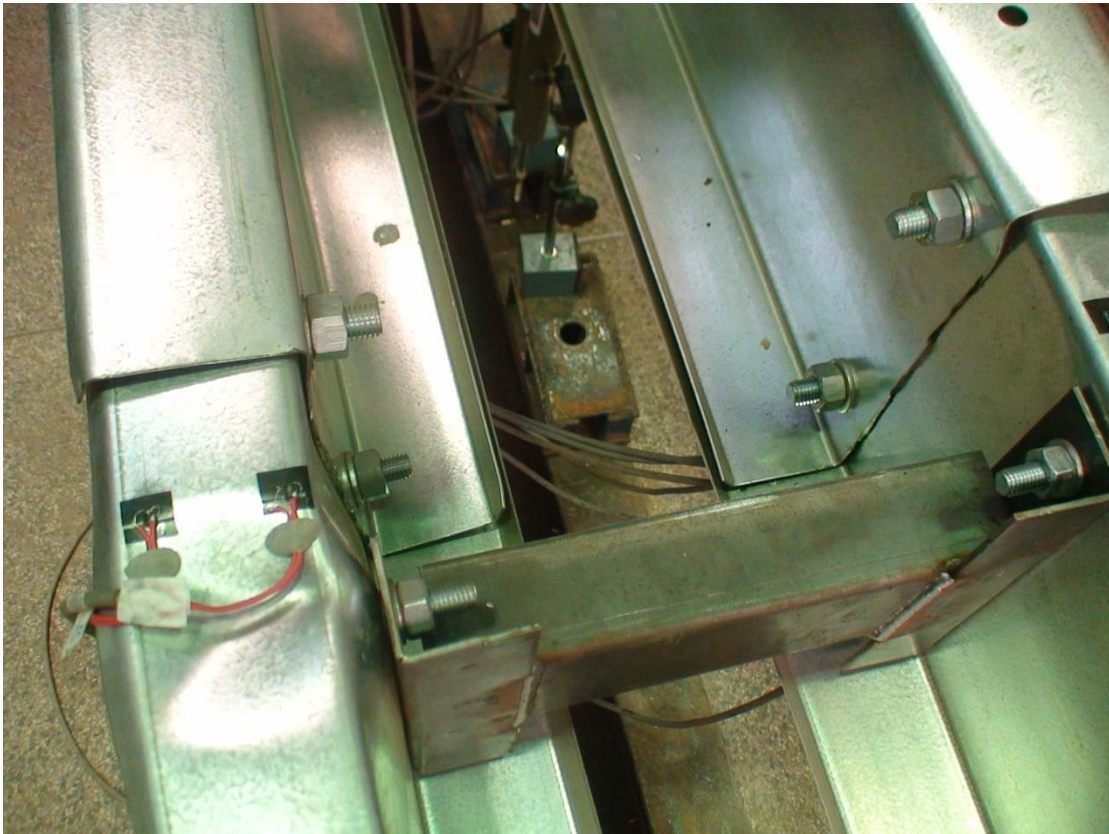
Foto 9 – Detalhe do modo de falha do protótipo Z1-L5P (modo distorcional-local). Notar que o local de falha coincide com o travamento mais próximo.
