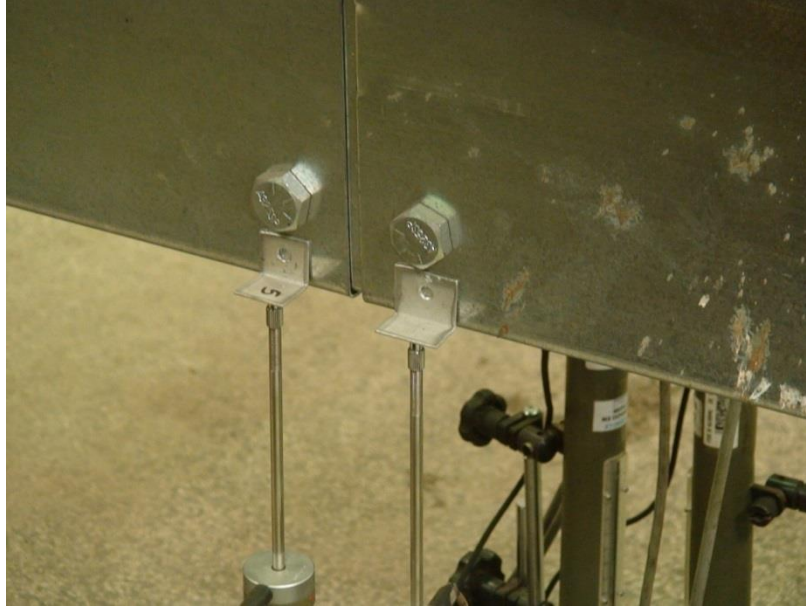
Foto 1 - Transdutores de deslocamento posicionados junto à seção central nos protótipos com luva.
