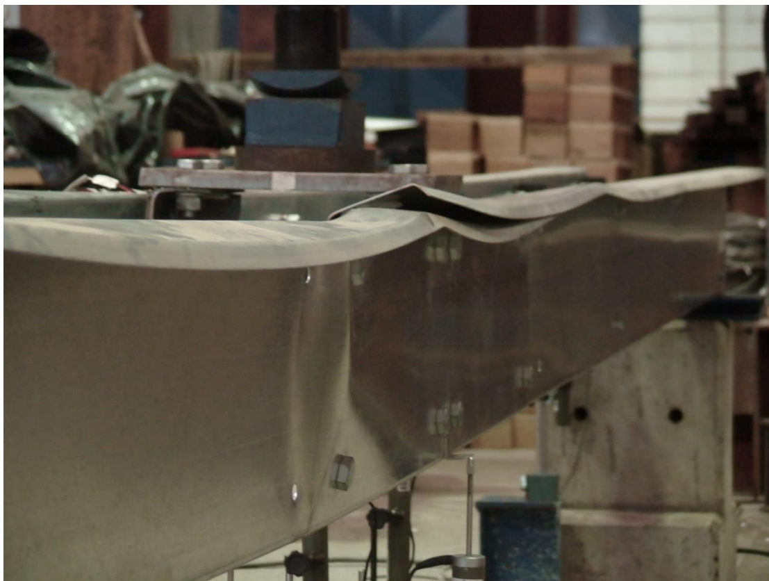
Foto 10 - Detalhe do modo de falha do protótipo Z1-T5 (modo distorcional-local).
