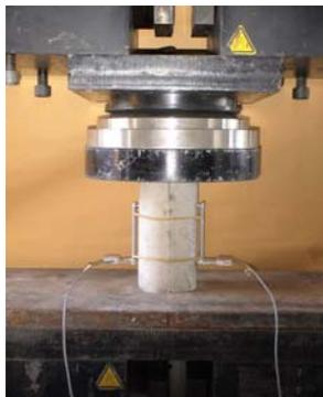
Figura 6.3 - Ensaio para a determinação da resistência à compressão e do módulo de elasticidade.
