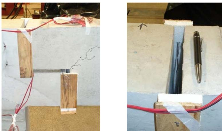
Figura 7.14 - Sistema de vedação para grauteamento da ligação.
