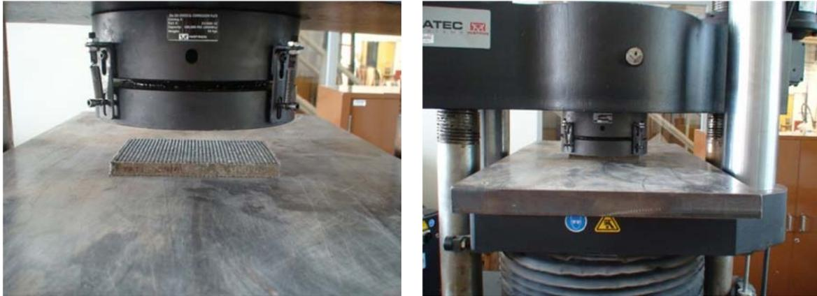
Figura 7.7 - Ensaio de compressão da almofada de apoio.
