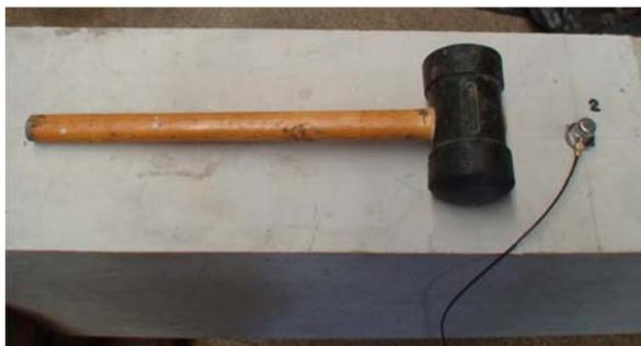
Figura 7.94 - Martelo usado para excitação dos modelos e acelerômetro fixado à viga.
