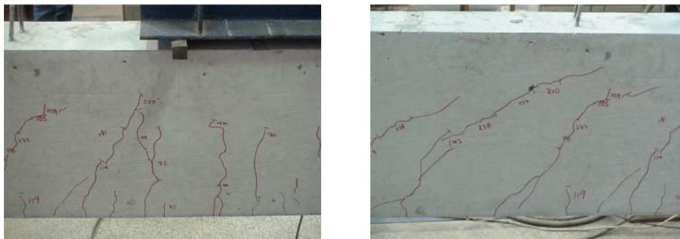
Figura 7.34 - Fissuração na região central, à esquerda; fissuração no terço da viga, à direita.
