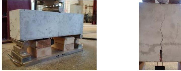
Figura 7.61 - Montagem do ensaio, à esquerda e abertura da fissura na iminência da ruptura do modelo, à direita.
