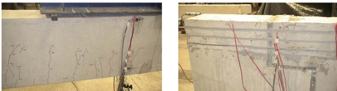
Figura 7.29 - À esquerda, fissuração na região central; à direita, fissuração a região do dente.
