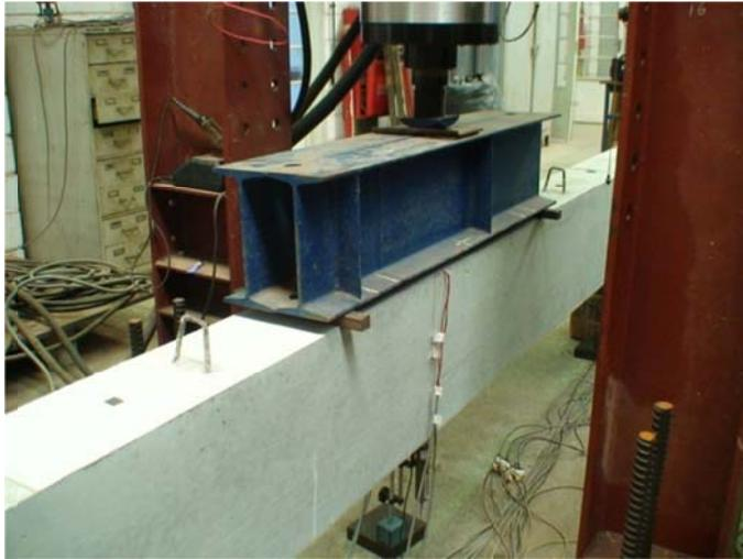
Figura 7.20 - Detalhe do sistema de distribuição da força.
