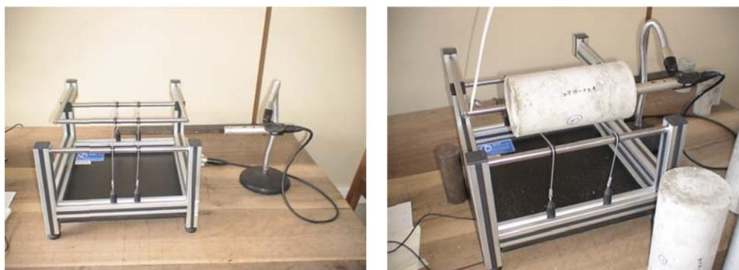
Figura 7.6 – Equipamento Sonelastic®, à esquerda e ensaio para determinação do módulo de elasticidade dinâmico do concreto, à direita.
