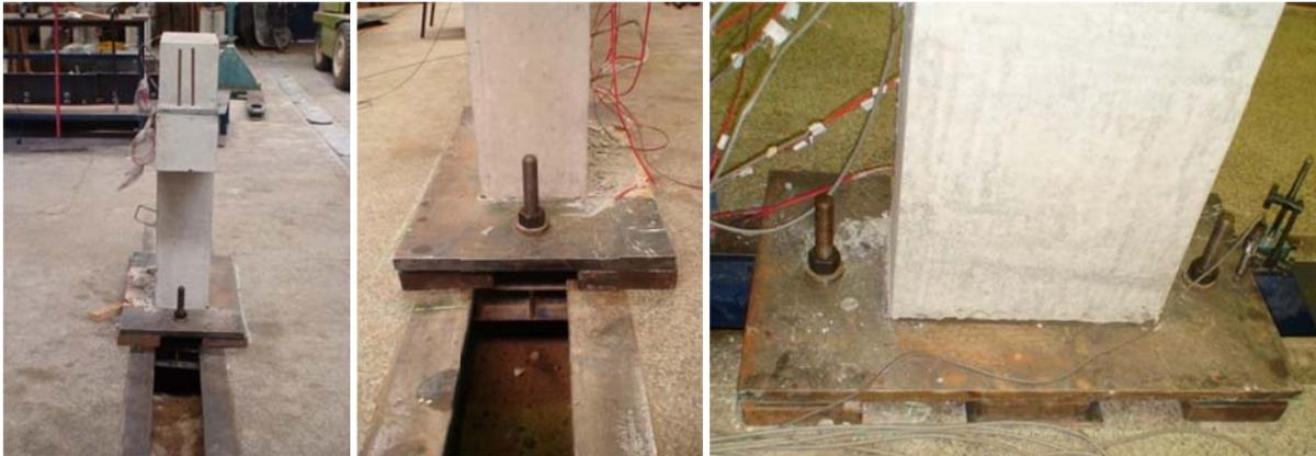
Figura 7.11 - Detalhes da fixação do pilar
