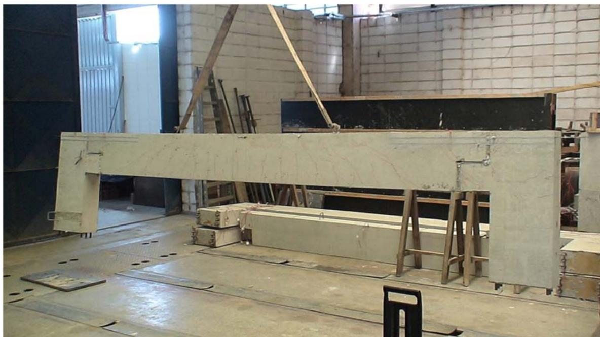
Figura 7.36 - Panorama de fissuração pós-ruptura.
