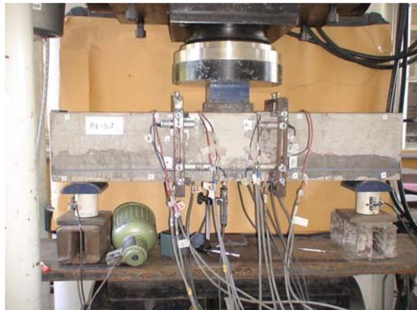
Figura 2.6 - Configuração do ensaio do modelo P1SJ.
