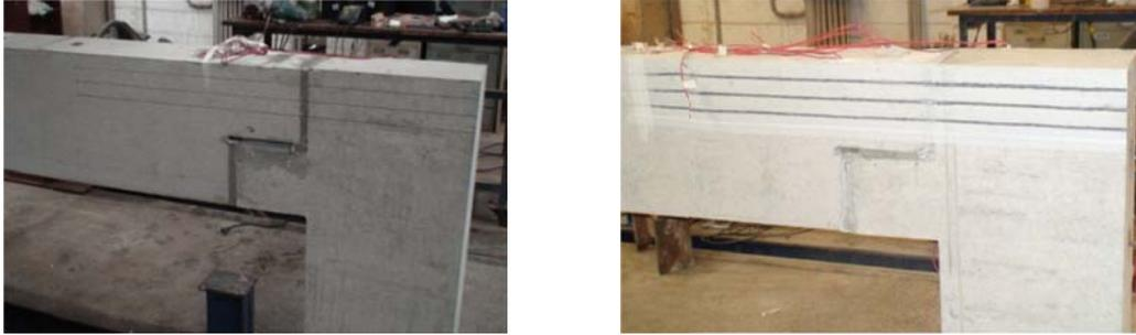
Figura 7.15 - Ligação após o grauteamento com marcação para corte dos entalhes (à esquerda) e com entalhes prontos (à direita).
