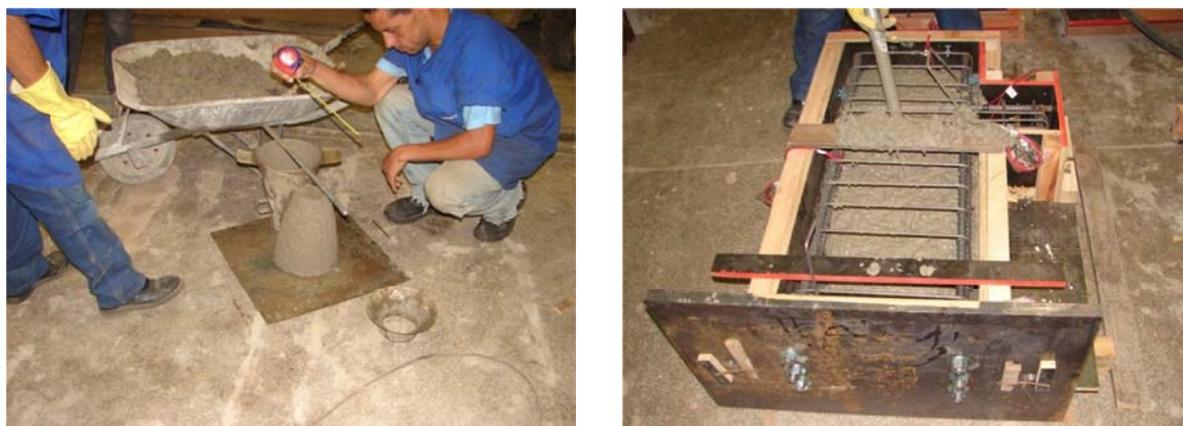
Figura 7.10 - Ensaio de consistência e adensamento do concreto.
