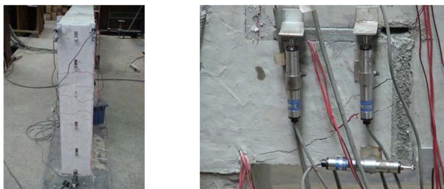
Figura 7.35 - Fissuração na lateral do pilar, à esquerda; detalhe de fissura em um dos consolos, à direita.
