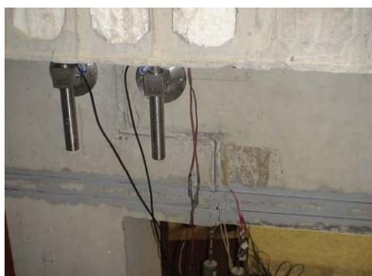
Figura 5.16 - Ligação que apresentou deformação excessiva.
