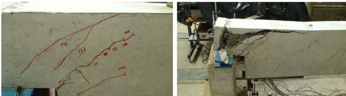
Figura 7.26 - À esquerda - Fissuração na região do dente Gerber; à direita - mesma região após ruptura.
