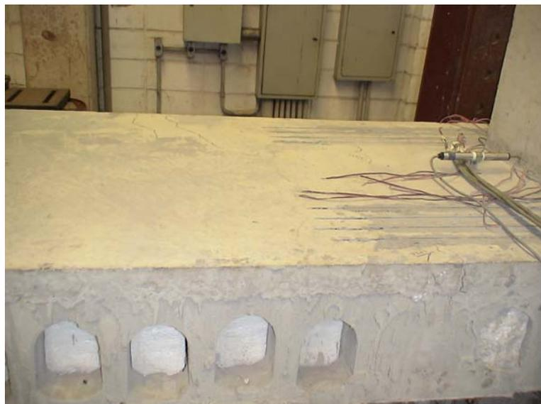
Figura 5.15 - Fissuras na capa da laje apos ensaio no modelo reforçado.
