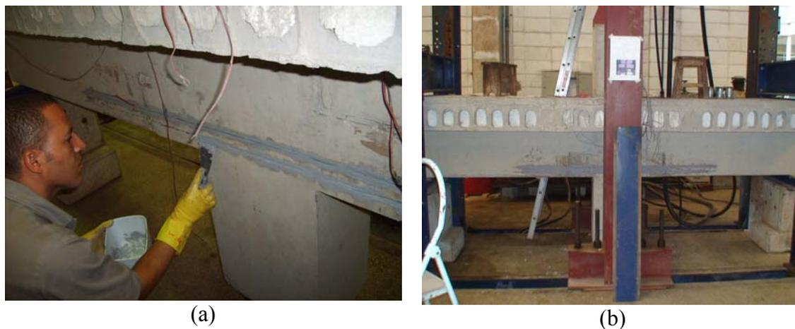
Figura 5.8 - Colagem dos laminados na lateral do modelo.
