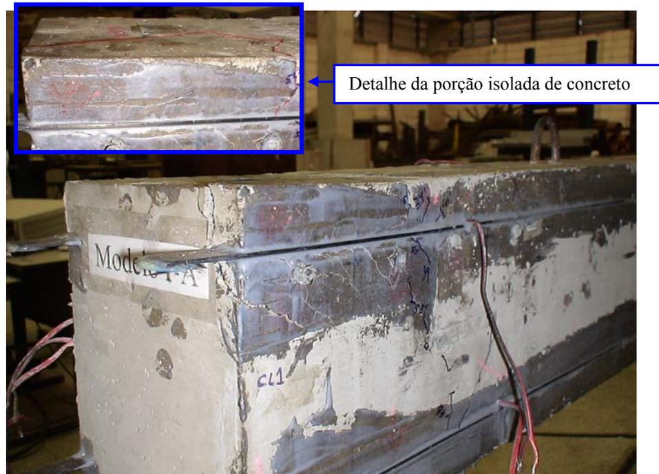
Figura 6.12 - Aspecto da ligação após a ruptura.
