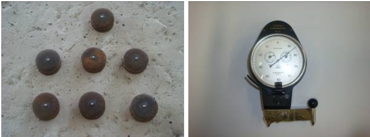
(a) (b) Figura 4. 48– Pastilhas de aço e extensômetro removível mecânico
