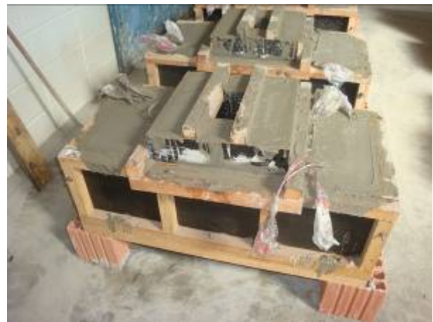
Figura 4. 26 – Blocos com cálice externo e parcialmente embutido após concretagem
