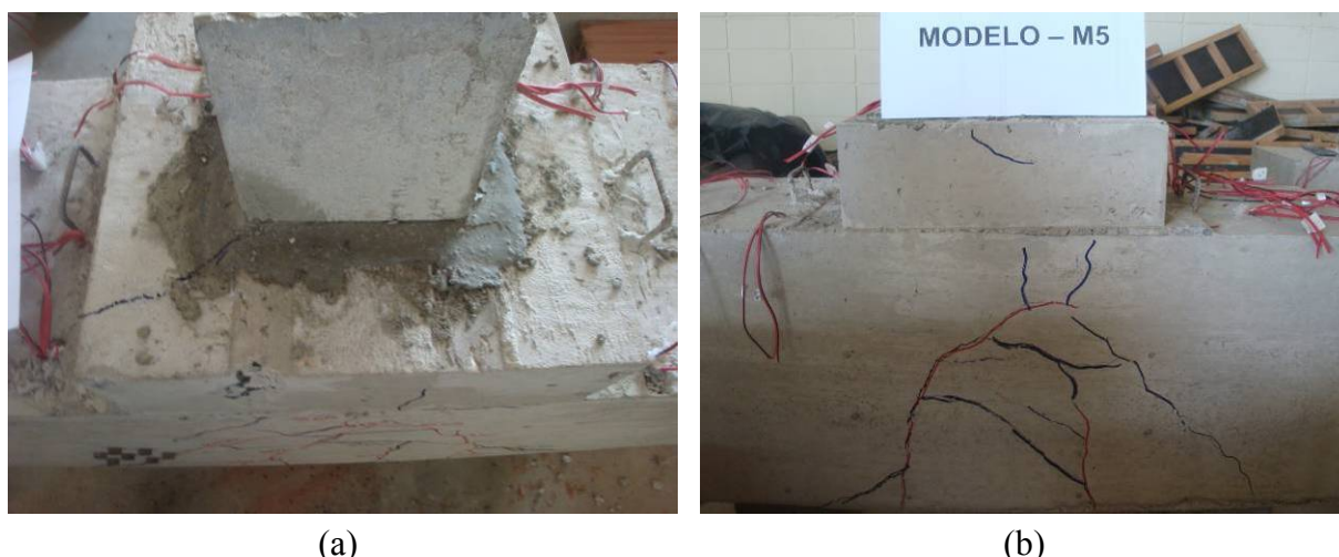
(a) (b) Figura 5. 64–Fissuras na face inferior e lateral oposta do Modelo M5
