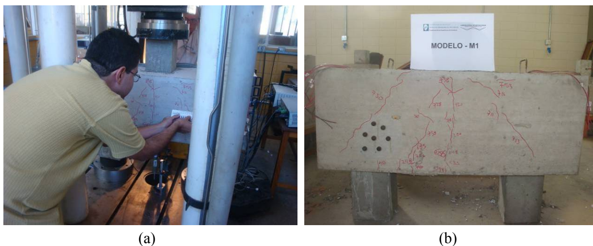
Figura 5. 10– Modelo M1 durante o ensaio e panorama de fissuração após o ensaio
