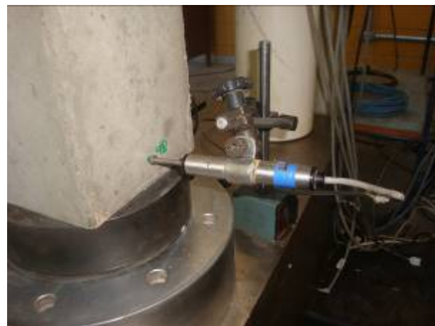
Figura 4. 52 – Transdutor de deslocamento T 5 e aparelho de apoio
