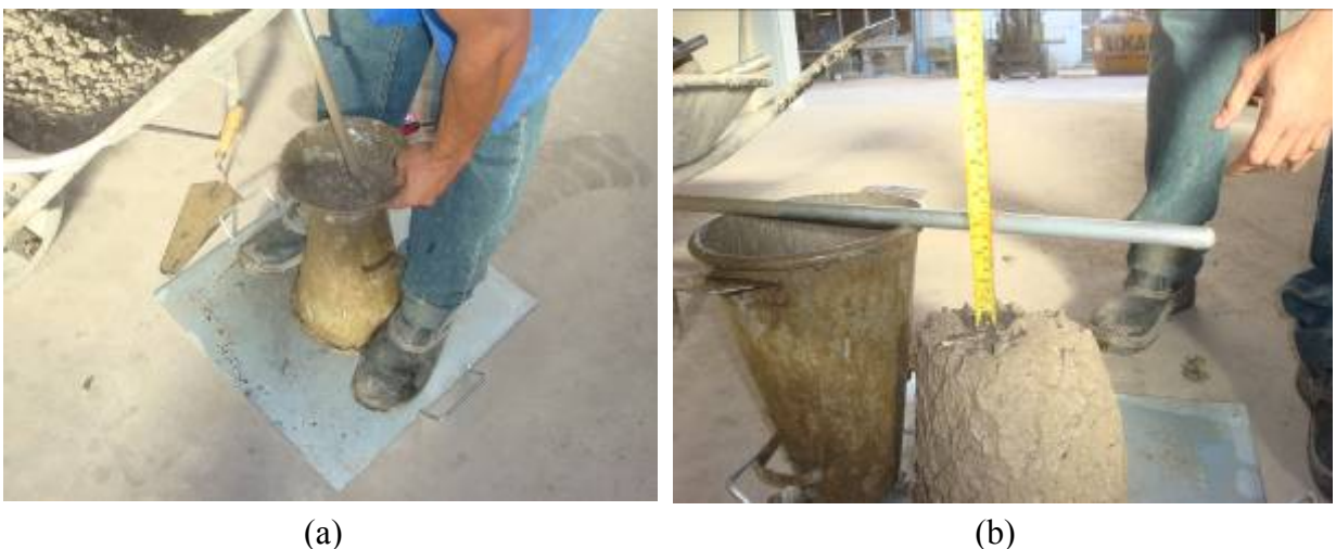
Figura 4. 23 – Realização do Slump test antes do início da concretagem
