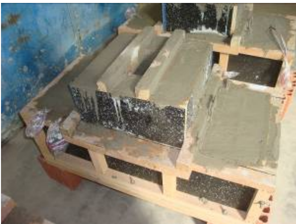
Figura 4. 26 – Blocos com cálice externo e parcialmente embutido após concretagem
