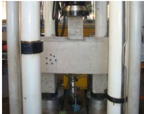
Figura 4. 50 – Transdutores de deslocamento T1 e T2
