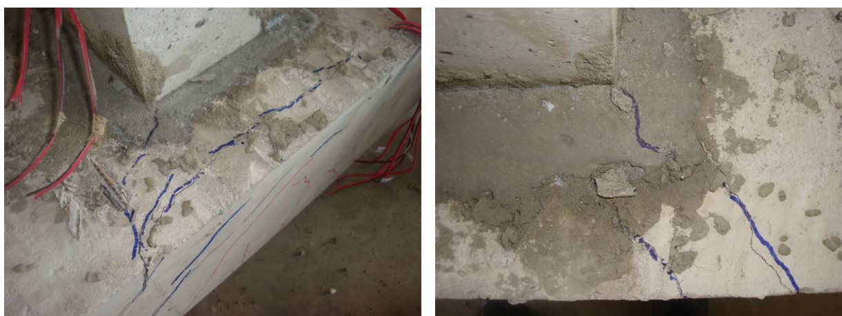
(a) (b) Figura 5. 114–Fissuras nas paredes do cálice do Modelo M13
