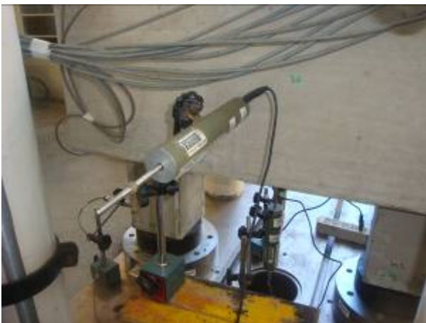
Figura 4. 51 – Transdutores de deslocamento T3 e T4
