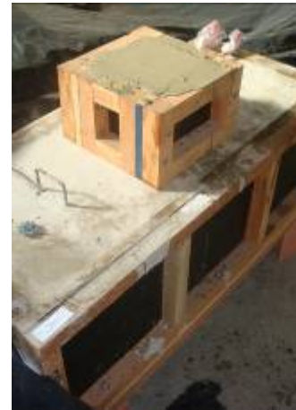
Figura 4. 29 – Armação, fôrma e concretagem do bloco de referência rugoso
