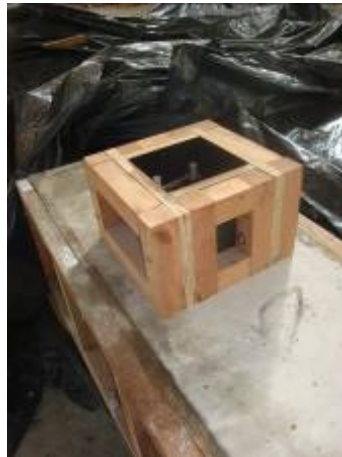
Figura 4. 29 – Armação, fôrma e concretagem do bloco de referência rugoso
