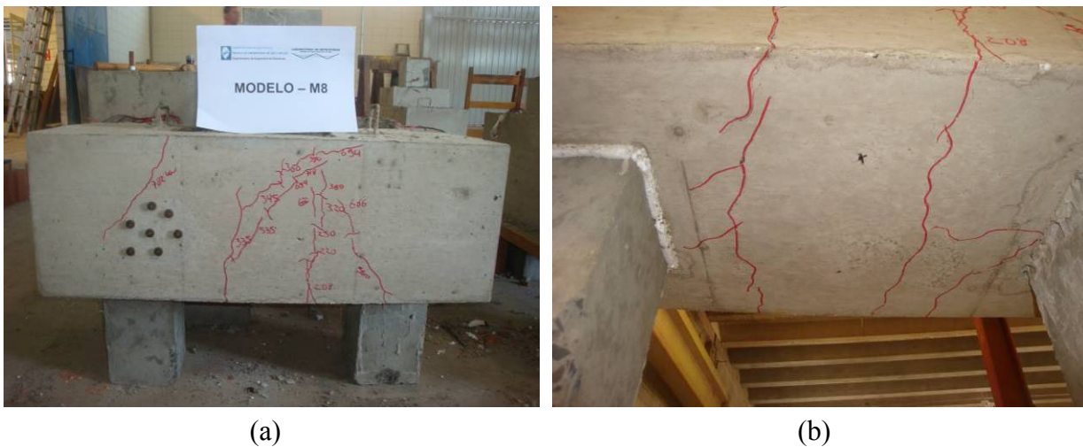
Figura 5. 16–Fissuras na face lateral e inferior do Modelo M8
