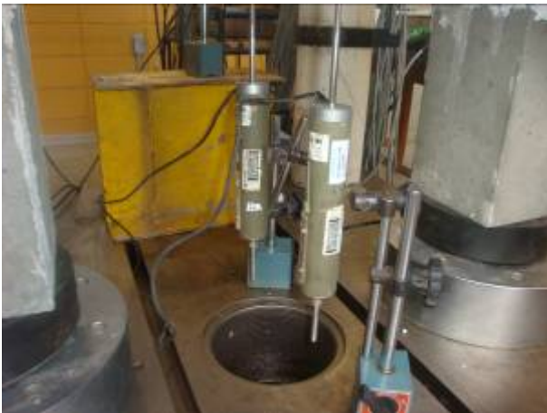
Figura 4. 50 – Transdutores de deslocamento T1 e T2
