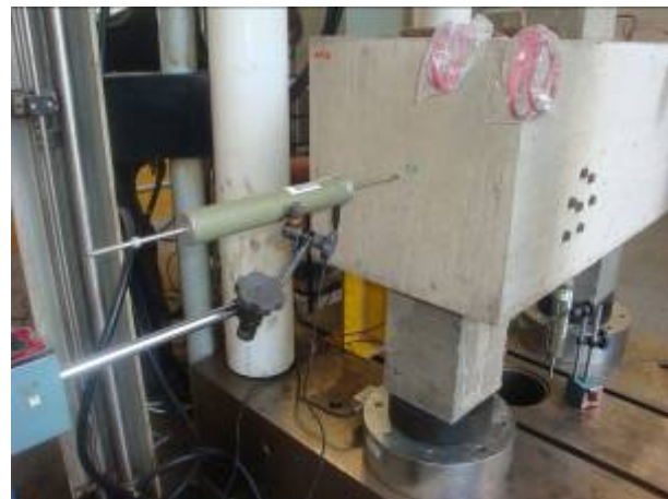
Figura 4. 51 – Transdutores de deslocamento T3 e T4
