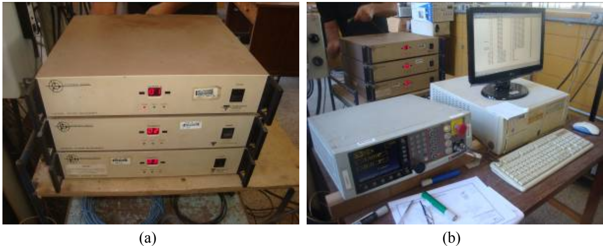
Figura 4. 40– Sistema de aquisição de dados System 5000 e Módulo controlador
