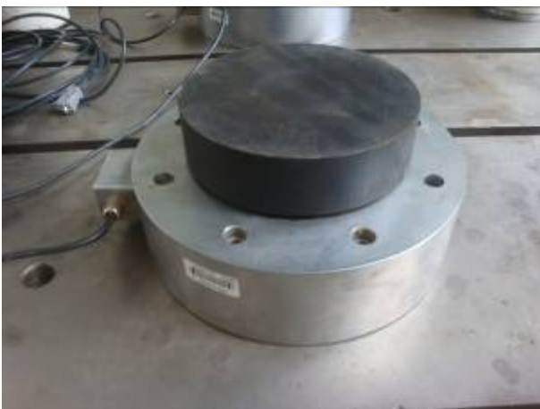
Figura 4. 52 – Transdutor de deslocamento T 5 e aparelho de apoio
