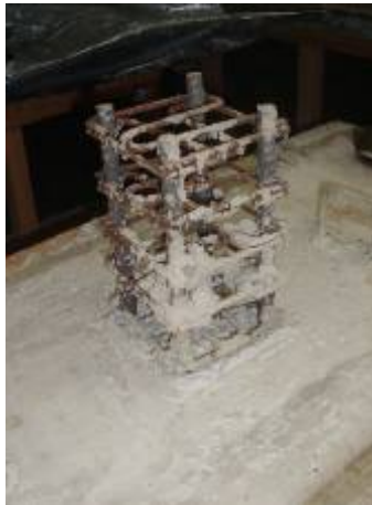
Figura 4. 29 – Armação, fôrma e concretagem do bloco de referência rugoso
