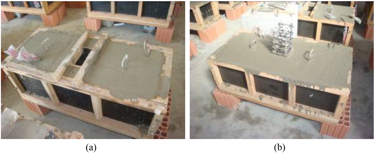
Figura 4. 27 – Blocos com cálice embutido e bloco de referência após concretagem
