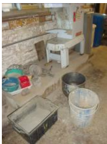
Figura 4.35 – Materiais e equipamentos utilizados na preparação do graute
