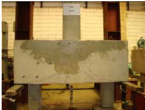
Figura 2. 10 - Bloco sobre duas estacas analisado por DELALIBERA (2009)
