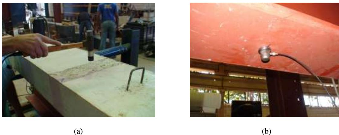
Figura 4-17 – (a) Excitação com martelo de impacto (b) Acelerômetro fixado na flange inferior da viga.
