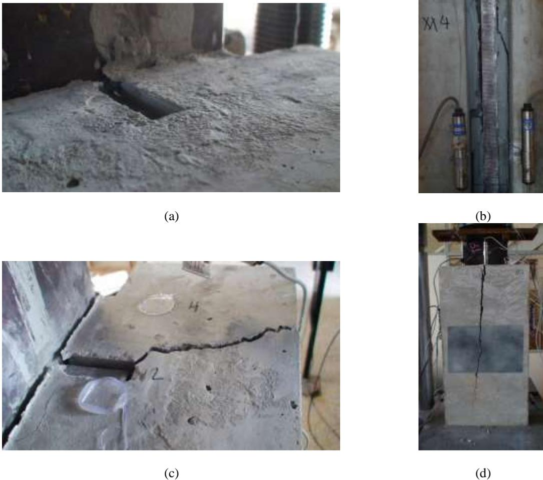
Figura 3-22 – Superfícies de ruptura. (a) Interface conector-AAD; (b) Interface flange-AAD e interface concreto-AAD; (c) Ruptura do concreto – direção da fissura; (d) Ruptura do concreto.
