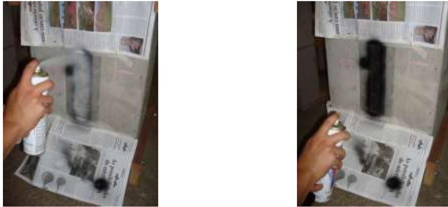
Figura 3-17 – Criação do padrão de contraste para instrumentação utilizando correlação de imagens.
