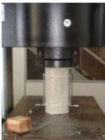
Figura 3-9 – Ensaio de compressão axial – Determinação da resistência do concreto
