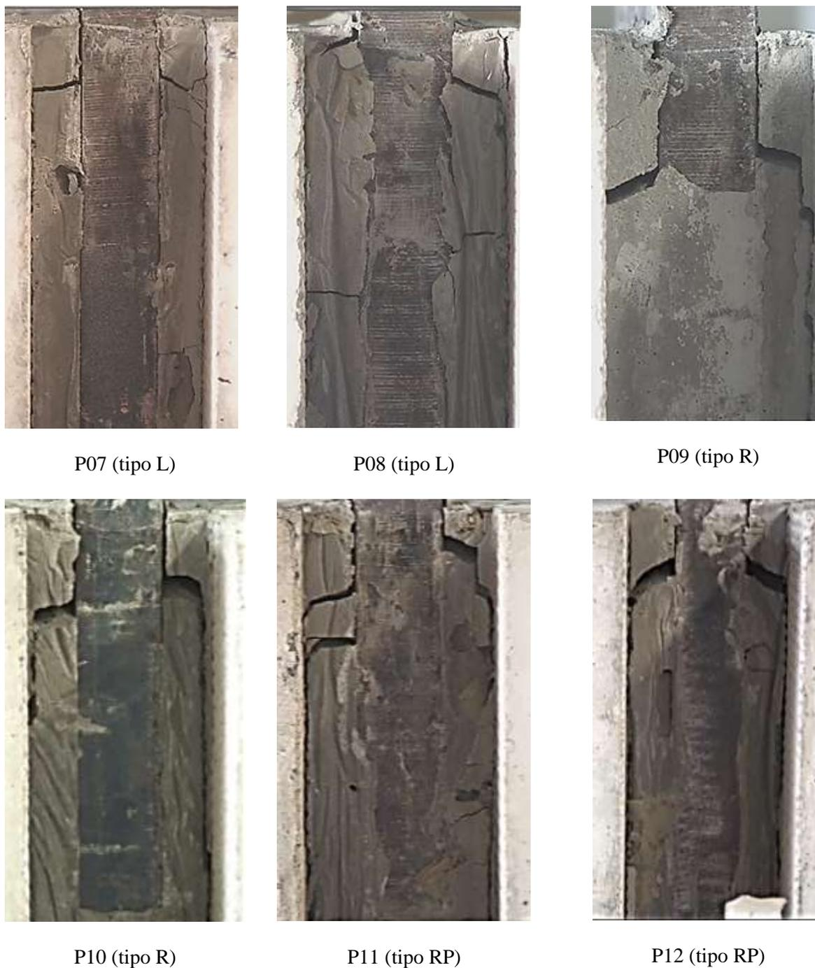
Figura 4-24 – Fissuração apresentada pela AAD correspondente ao final do ensaio – Protótipo P07 à P12.
