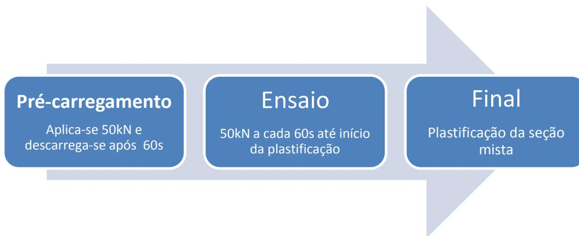
Figura 4-22 – Esquema de carregamento – Ensaio de *Viga Mista*.
