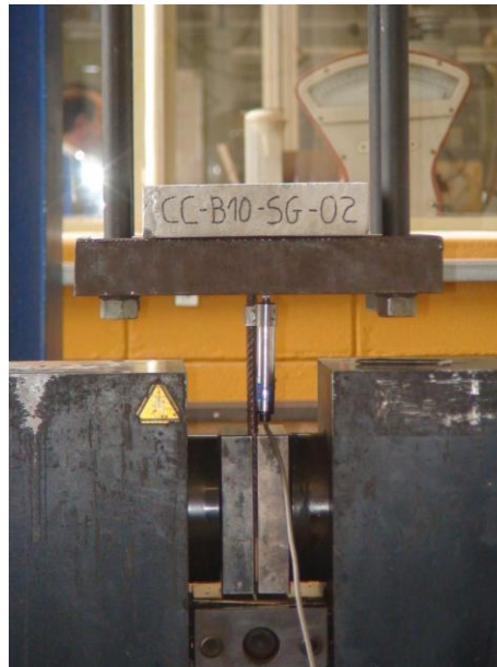
Figura 4.30 – Ensaio de arrancamento proposto modificado
