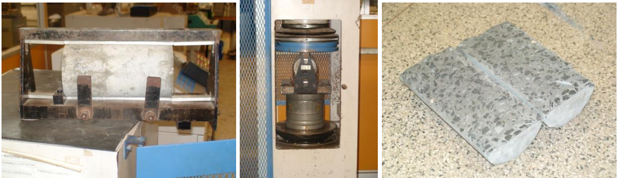
Figura 4.5 – Ensaio de Resistência à Tração do Concreto
