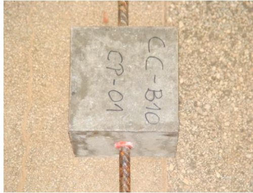
Figura 5.2 – Ruptura por arrancamento do modelo CC-B10-01
