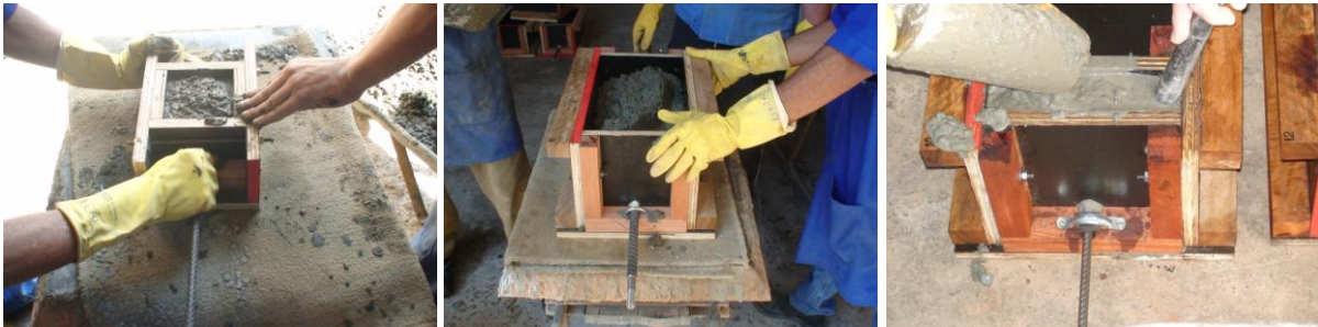
Figura 4.2 – a) e b) Adensamento em mesa vibratória; c) Adensamento por meio do vibrador de imersão
