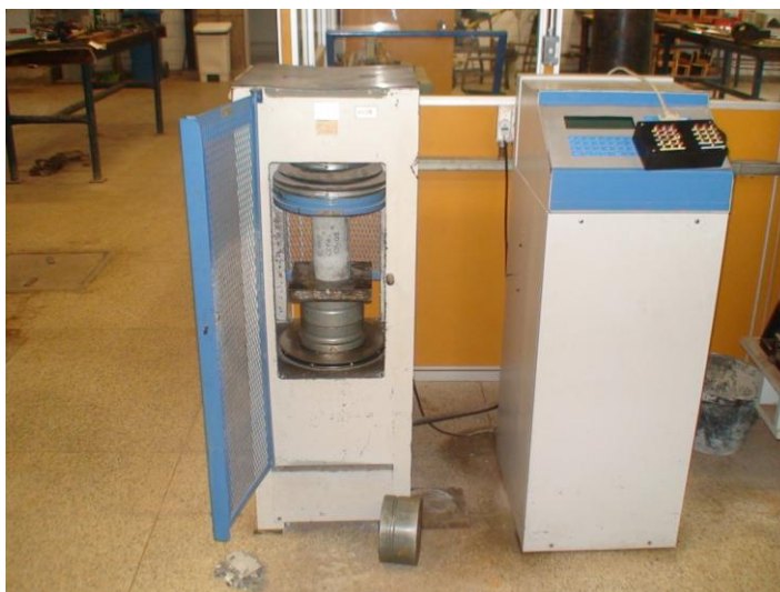
Figura 4.4 – Ensaio de Resistência à Compressão do Concreto
