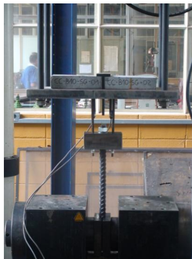
Figura 4.29 – Ensaio de arrancamento após o corte dos modelos
