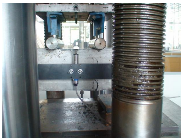
Figura 4.8 – Ensaio de Tenacidade à Flexão
