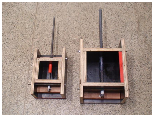
Figura 4.10 – Formas do modelo de arrancamento com barras de 10 e 16 mm (dimensões em mm)
