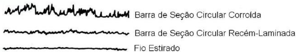
Figura 2.1 – Rugosidade superficial de barras e fios lisos (LEONHARDT & MÖNNIG, 1977)
