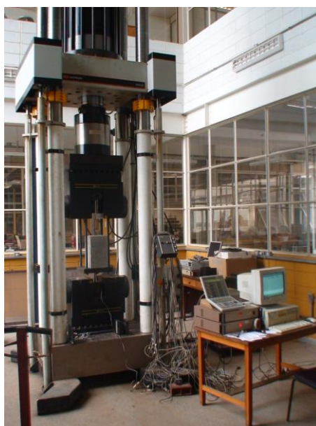
Figura 4.22 – Máquina servo-hidráulica acoplada a sistema de aquisição de dados computadorizado
