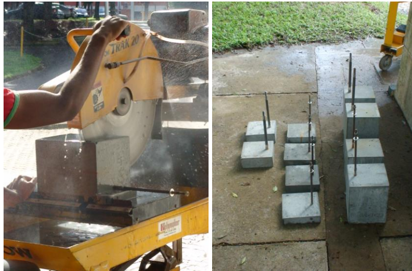
Figura 4.28 – Corte dos modelos
