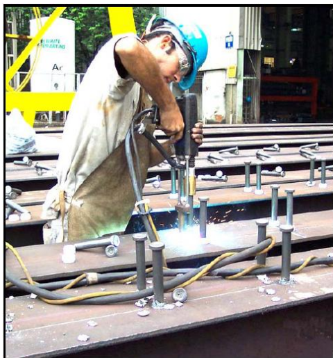
Figura 2.34 – Soldagem de conectores do tipo pino com cabeça Fonte: Kotinda (2006)
