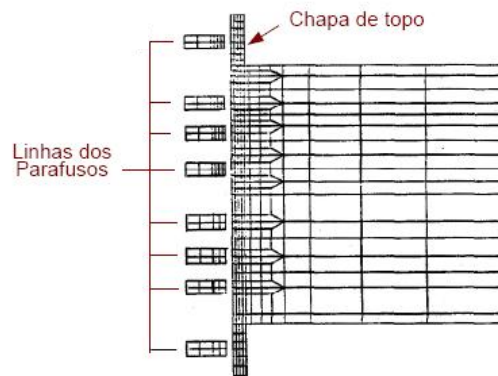
Figura 3.3 – Geometria e malha de elementos finitos da análise numérica de KRISHNAMURTHY (1975c) (MAGGI, 2000)
