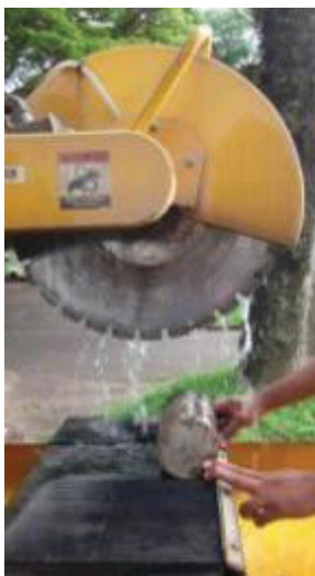
Figura 75 - Corte em testemunho para retirada da camada asfáltica.
