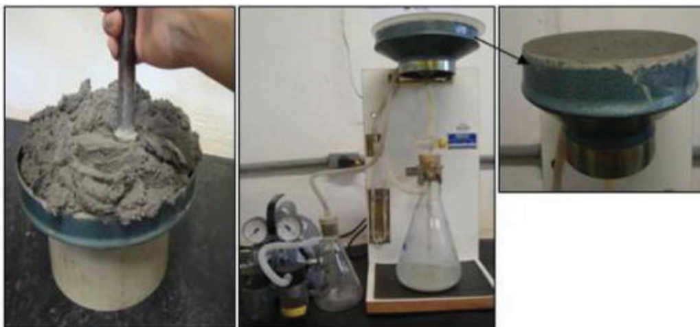
Figura 33 - Ensaio de retenção de água. Fonte: DAS CHAGAS, BEZERRA & BAUER (2009).
