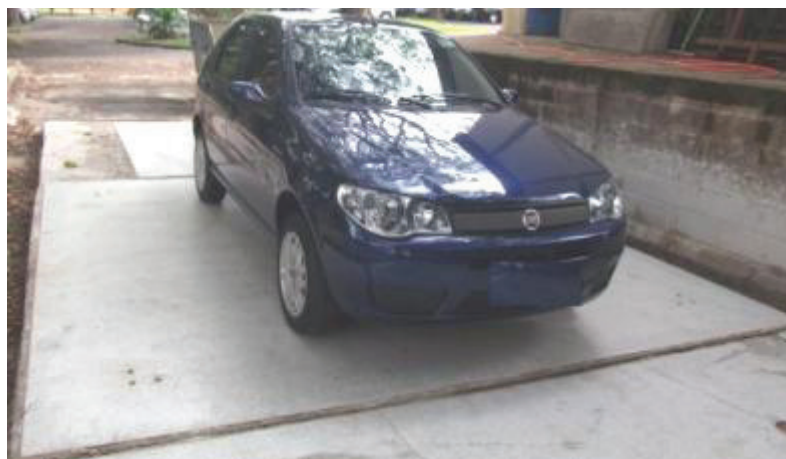
Figura 70 - Quadro II submetido a carregamento.
