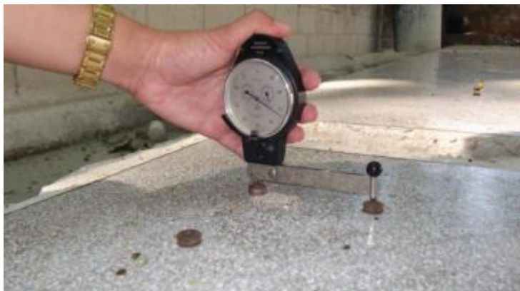
Figura 56 - Leitura de deformação com Tensotast.
