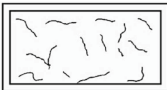
Figura 18 - Fissuras por retração. Fonte: SOUZA & RIPPER (1998).
