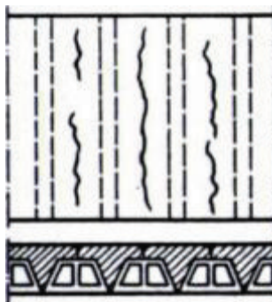
Figura 19 - Fissuração por retração com direção preferencial. Fonte: MONTTOYA et al. (2001).
