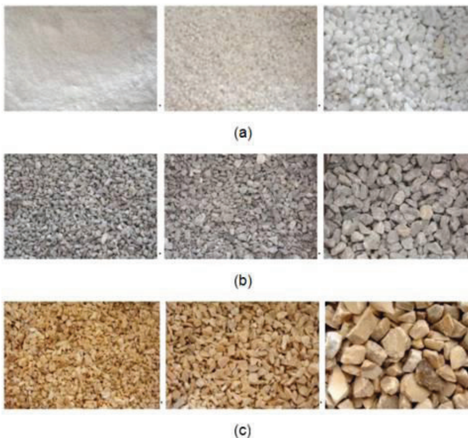
Figura 5 - Agregados para granilite. (a) granitinas Branco Nacional; (b) granitinas Cinza Paraná; (c) granitinas Amarelo Dourado. Fonte: MINASIT (2011).
