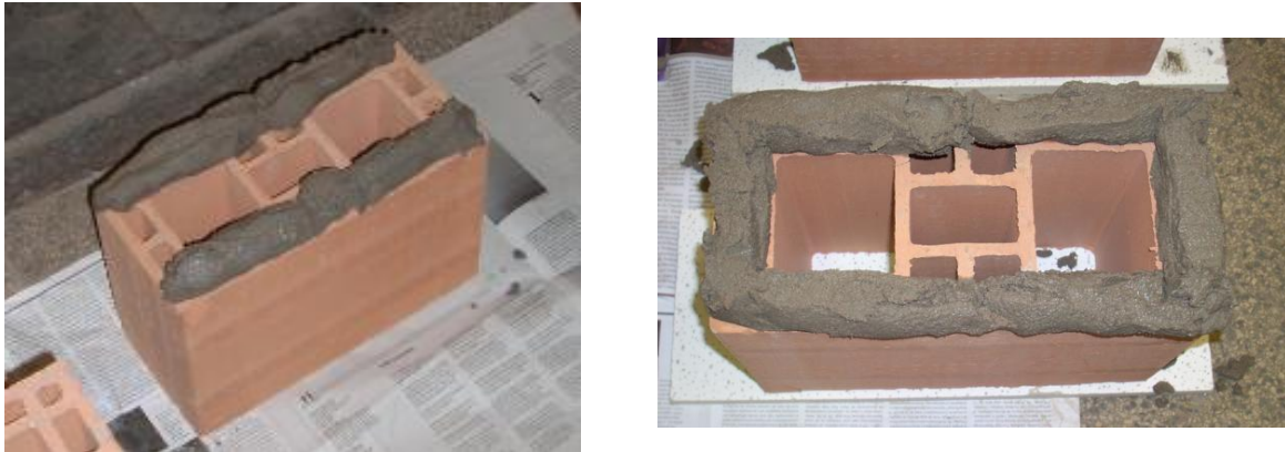
Figura A.1 – Assentamento dos prismas: (a) prisma oco e (b) prisma grauteado
