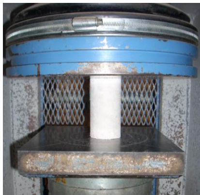
Figura 3.24 – Ensaio do corpo de prova de argamassa
