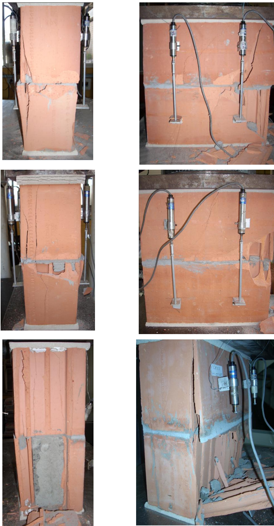
Figura 4.1 – Modo de ruptura dos prismas das 1ª, 2ª e 3ª séries
