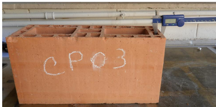
(b) Espessura das paredes externas
