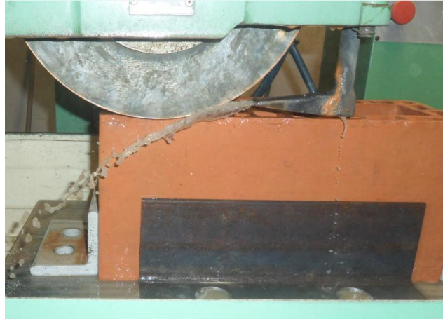
Figura 3.20 – Regularização da superfície do bloco através de uma retífica
