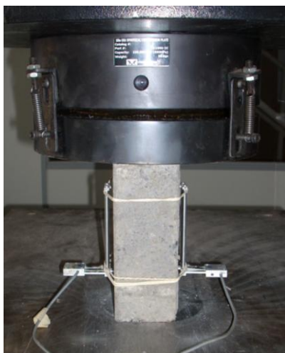
Figura 3.30 – Ensaio de resistência à compressão de corpos de prova prismáticos de graute
