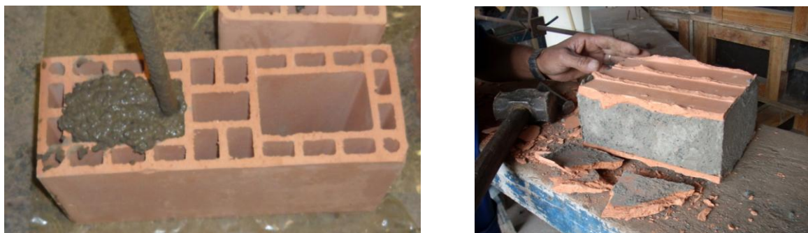
Figura 3.29 – Moldagem e extração dos corpos de prova de graute prismático
