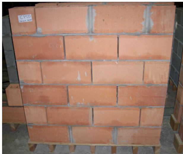
Figura 3.40 – Detalhe com as juntas verticais que foram preenchidas
