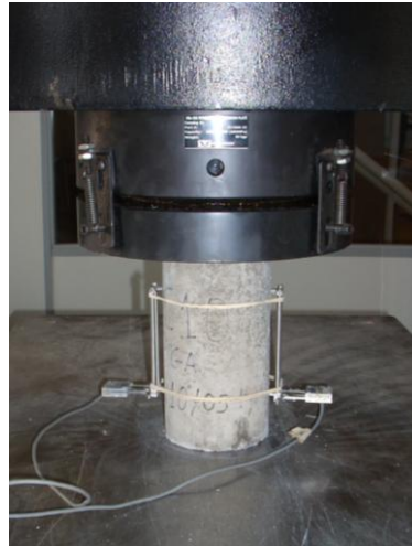
Figura 3.28 – Instrumentação do corpo de prova de graute no ensaio de resistência à compressão
