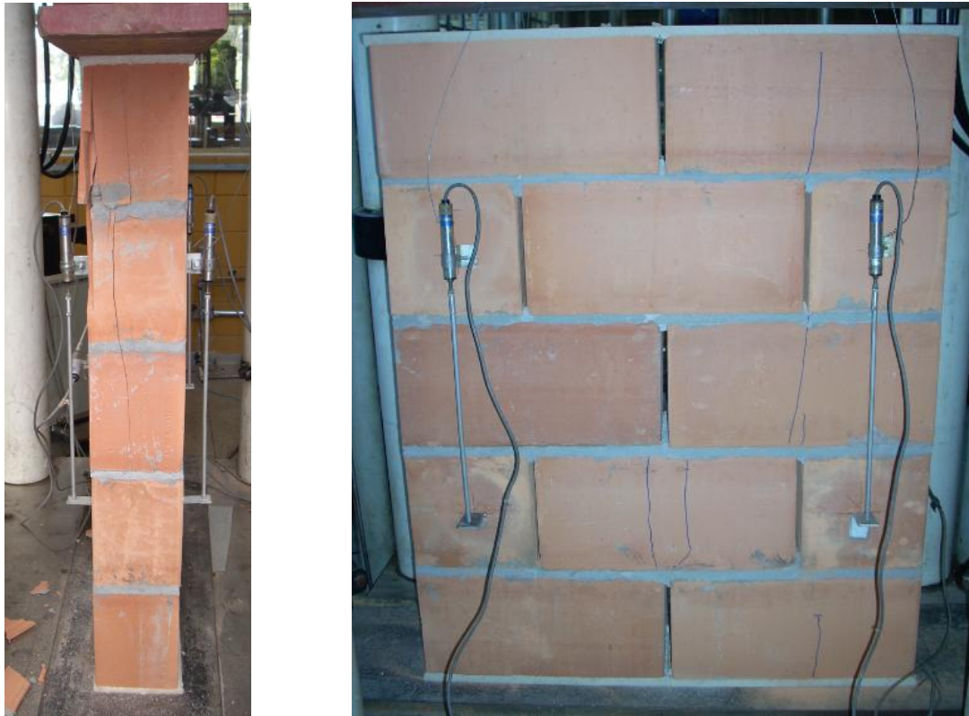
Figura 4.8 – Modo de ruptura das pequenas paredes da 2ª série
