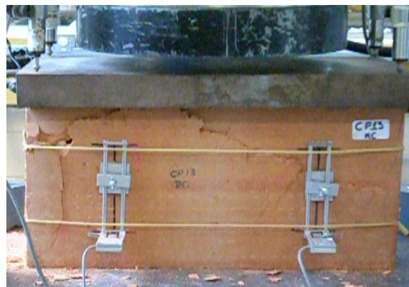
Figura 3.21 – Ruptura típica do bloco cerâmico submetido ao ensaio de resistência à compressão
