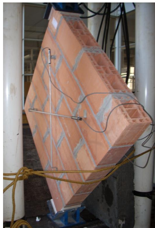
Figura 3.43 – Esquema de instrumentação para o ensaio de resistência ao cisalhamento
