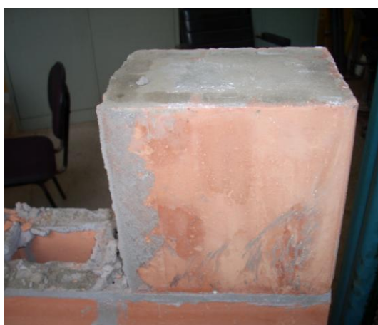
Figura 3.39 – Detalhe do grauteamento do bloco em uma parede ensaiada
