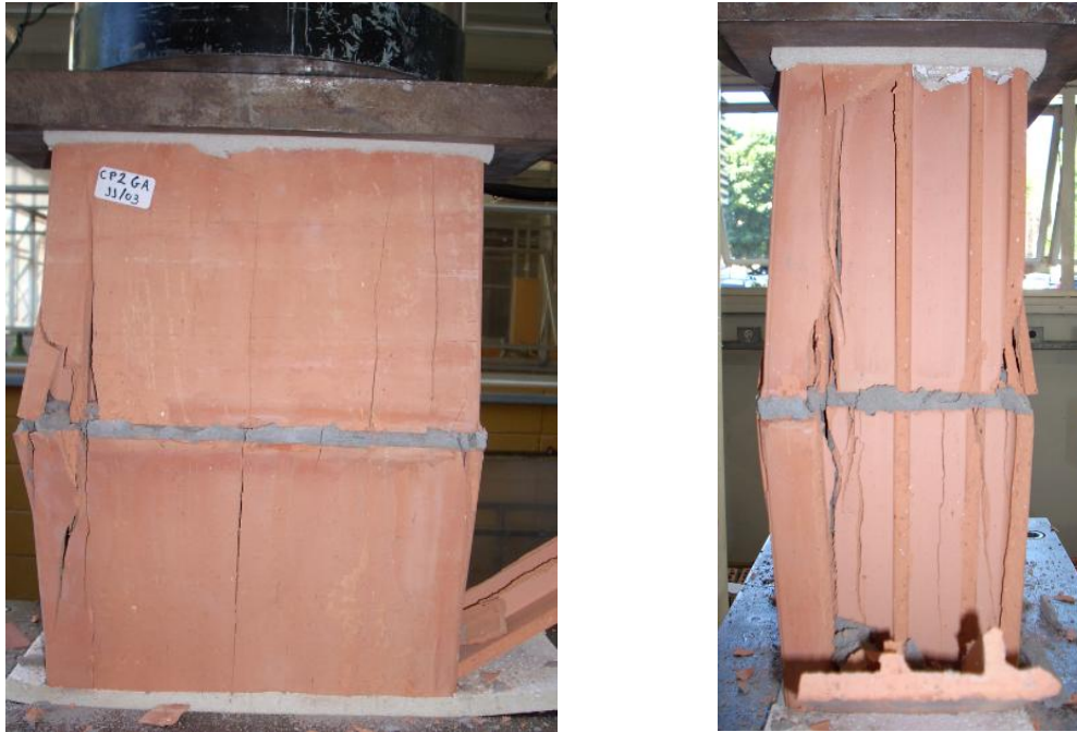
Figura A.8 – Ruptura típica dos prismas grauteados
