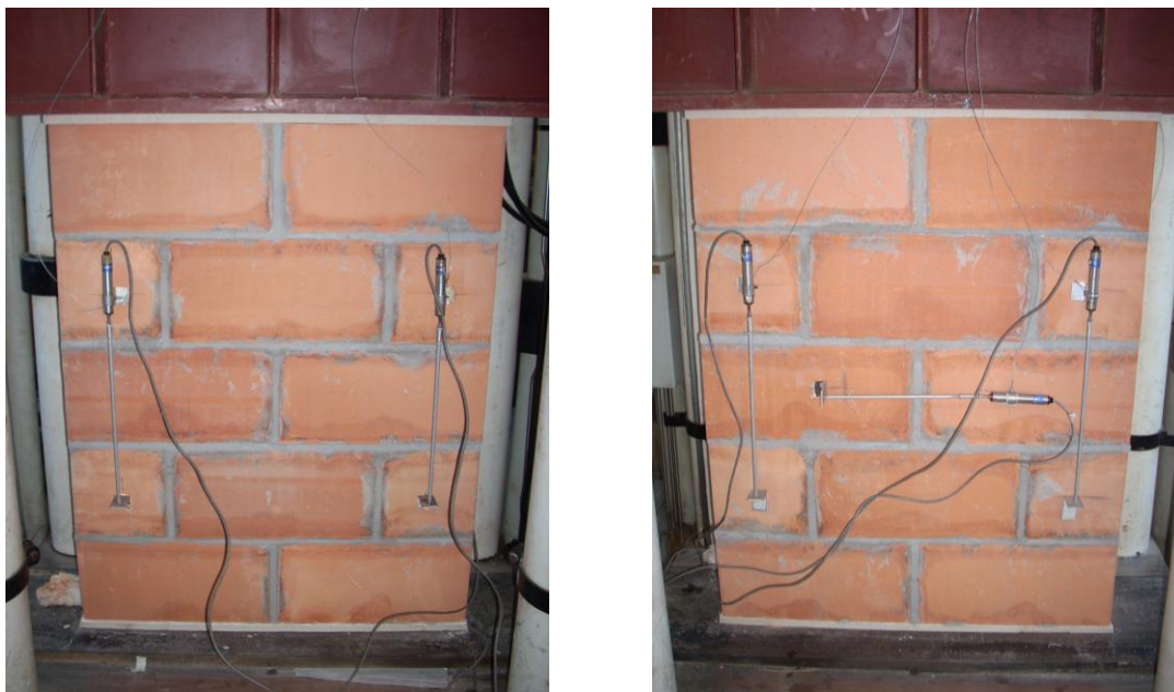
Figura 3.42 – Esquema de instrumentação para o ensaio de resistência à compressão
