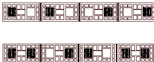
Figura 2.14 – Esquema da área grauteada da primeira e segunda etapa Fonte: Garcia (2000)
