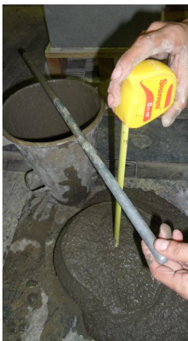
Figura 3.27 – Ensaio de consistência do graute – NBR NM 67 (ABNT, 1998)
