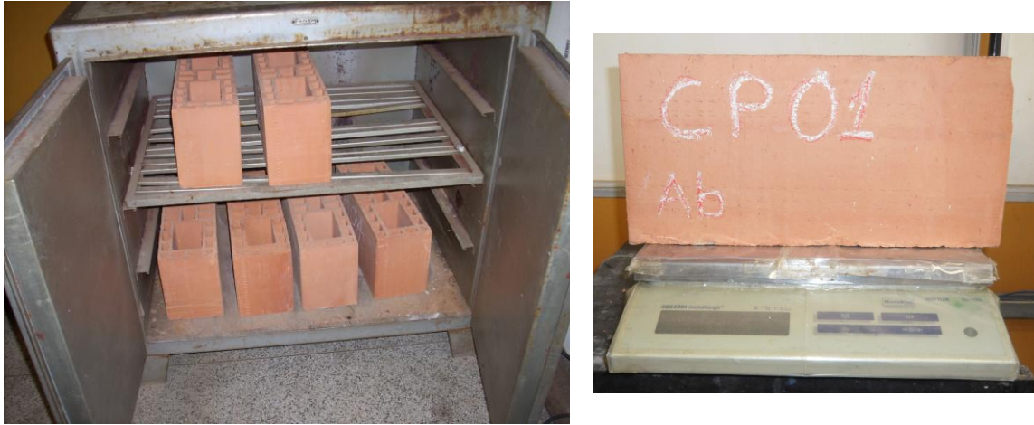
Figura 3.16 – Bloco seco em estufa e determinação de sua massa seca
