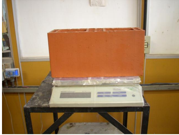
Figura 3.15 – Determinação da massa saturada ( m_u ) do bloco
