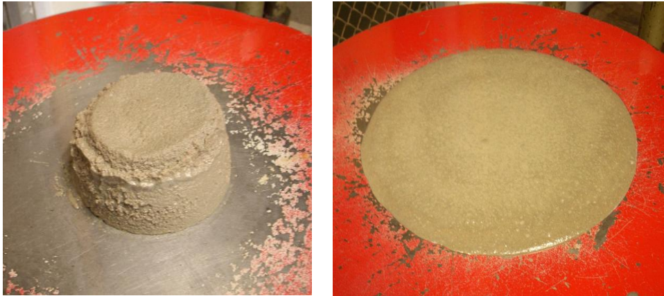
Figura 3.25 – Ensaio de determinação do índice de consistência da argamassa
