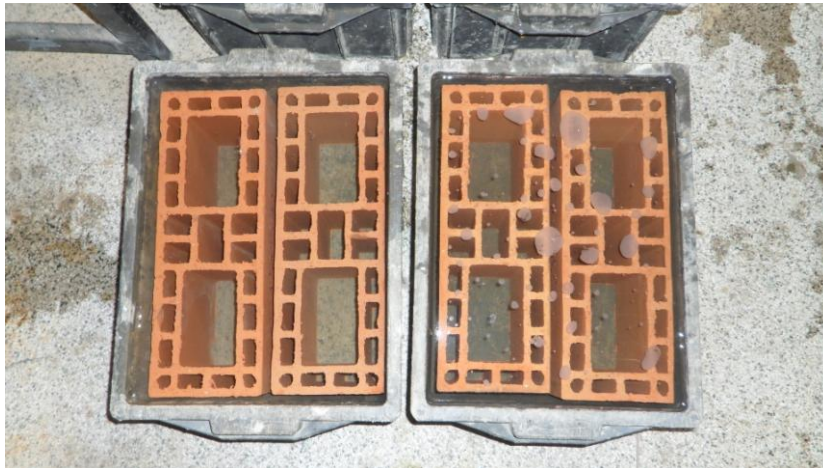
Figura 3.17 – Bloco submerso em água para determinação da massa úmida ( m_u )
