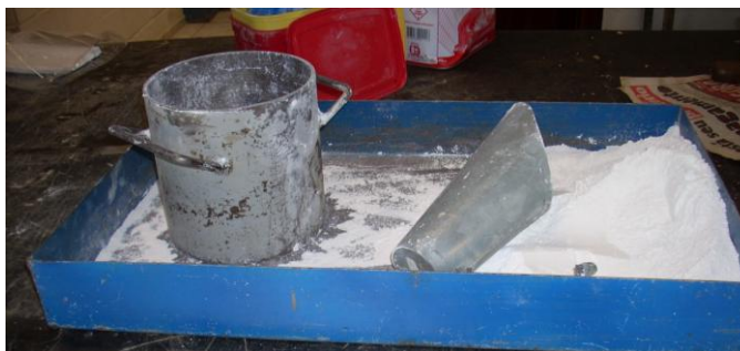
Figura 3.32 – Determinação da massa unitária no estado compactado seco
