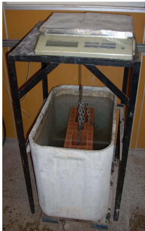
Figura 3.14 – Determinação da massa aparente ( m_a ) do bloco
