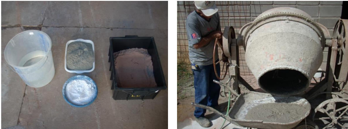
Figura 3.23 – Procedimento de preparo da argamassa
