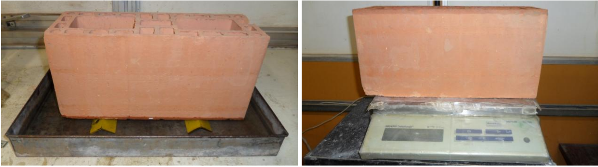
(a) Bloco submerso em água
