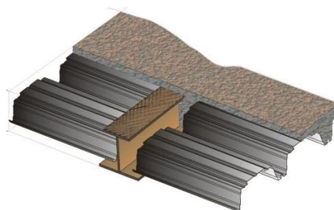
**Figura 2.16 – Esquema geral de um sistema de piso misto de pequena altura (De Nardin, 2007)**
