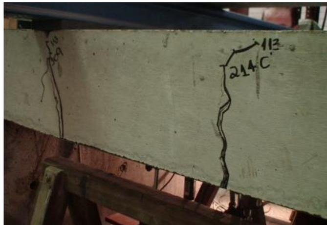
**Figura 3.52 - Fissura formada durante o carregamento cíclico do modelo 5.**
