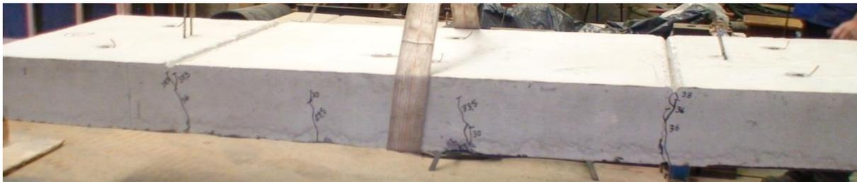
Figura 3.43 - Quadro de fissuração do modelo 2 ao final do ensaio
