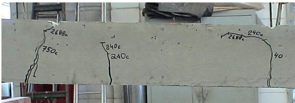
Figura 3.37 - Modelo 6 – Quadro de fissuração na ruptura do modelo – panorama completo.
