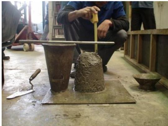
**Figura 3.4 – Ensaio de *slump* antes da concretagem dos modelos de laje**
