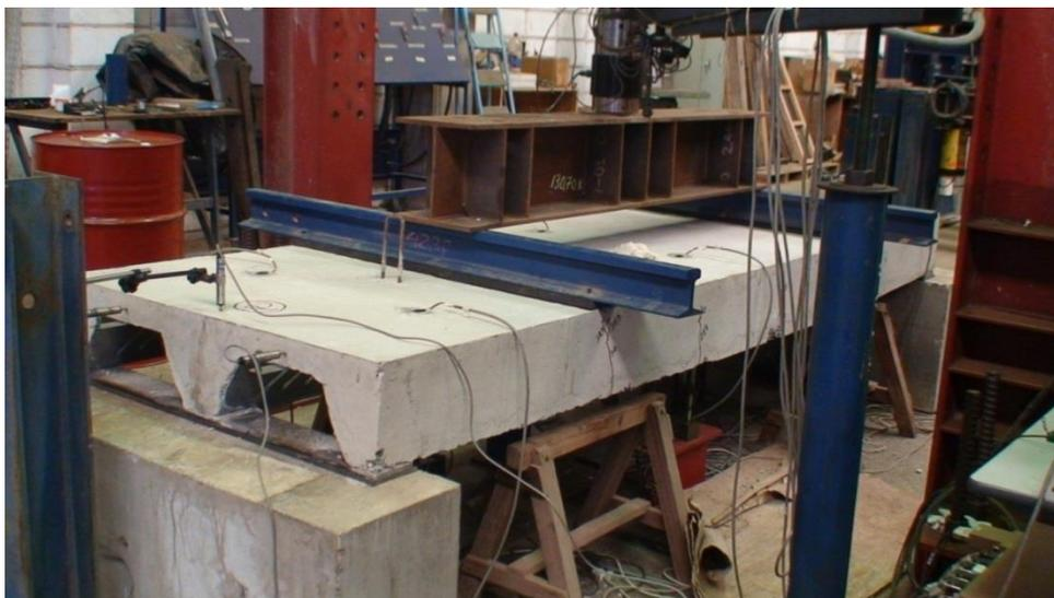
Figura 3.17 - Ensaio cíclico da laje mista modelo 1
