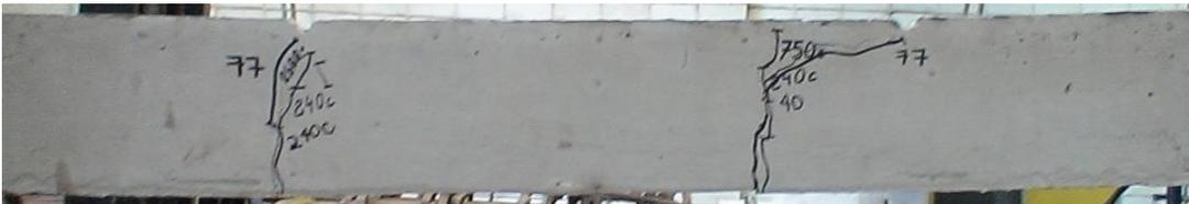
b) Quadro de fissuração na ruptura do modelo
