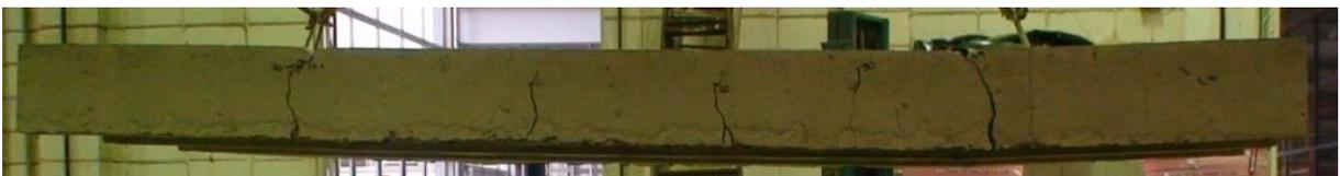
Figura 3.39 - Quadro de fissuração do modelo 1 ao final do ensaio
