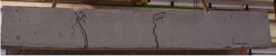
**Figura 3.54- Quadro de fissuração ao final do ensaio – Modelo 5**
