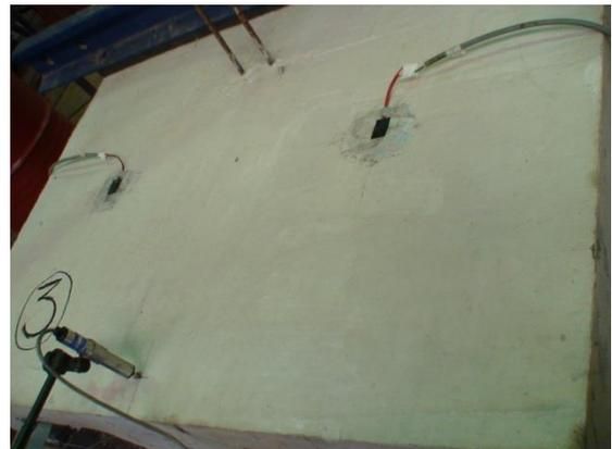
b) Extensômetro no concreto
