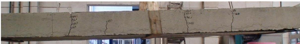
Figura 3.47 – Quadro de fissuração ao final do ensaio - modelo 3
