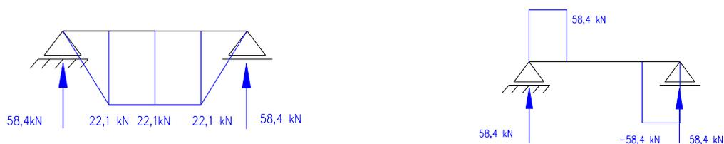
c) Diagrama de momento fletor – Modelo 5    d) Diagrama de esforço cortante – Modelo 5
