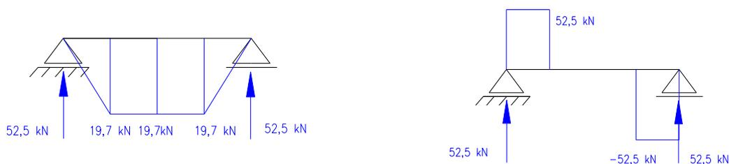
a) Diagrama de momento fletor – Modelo 4    b) Diagrama de esforço cortante – Modelo 4
