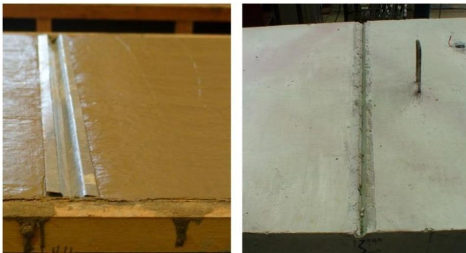
**Figura 3.12 - Indutor de trinca na laje mista**
