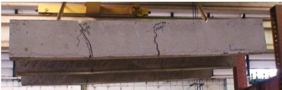
**a) Quadro de fissuração na ruptura do modelo 5**
