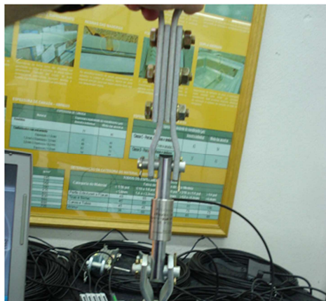
Figura 3.26 - Célula de carga adaptada para o suporte do cabo. Fonte: Grupo Kepler Weber (2009)
