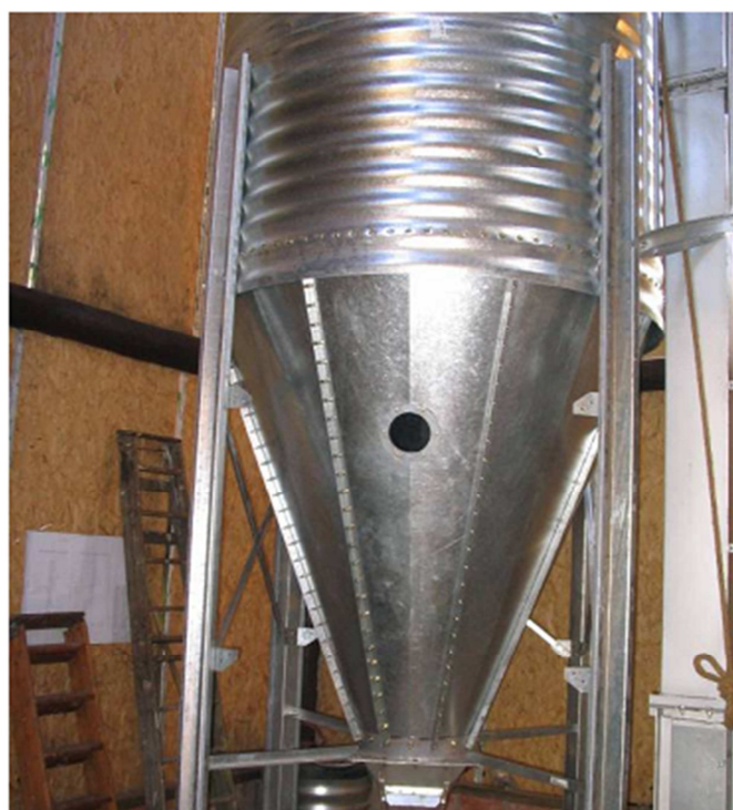
Figura 3.12 - Visão geral do silo de armazenamento
