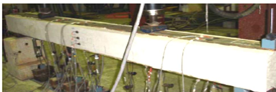
Figura 2. 7 - Vigas parcialmente revestidas ensaiadas em DE NARDIN & EL DEBS (2009)
