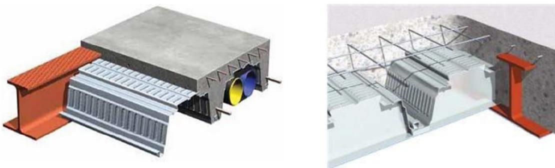
Figura 2. 6 - Sistema de Pisos Mistos de Pequena Altura, RAMOS (2010)
