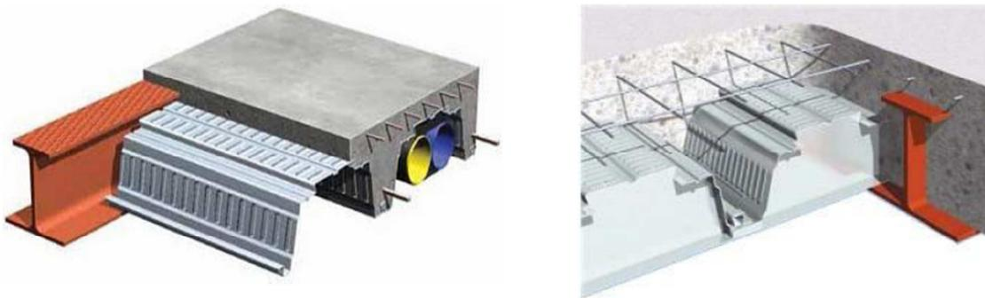
Figura 1. 1 - Sistema de pisos mistos de baixa altura, RAMOS (2010)
