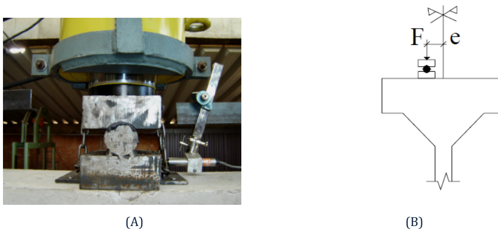
FIGURA 4.9 – DETALHE DA ARTICULAÇÃO SUPERIOR (A) E ESQUEMA DE CARREGAMENTO (B), (DANTAS, 2006)
