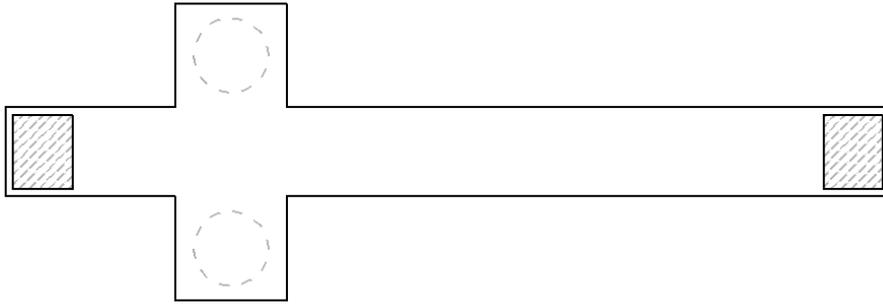
Figura 41 – Exemplo de força indireta com armadura de suspensão – Vista em planta
