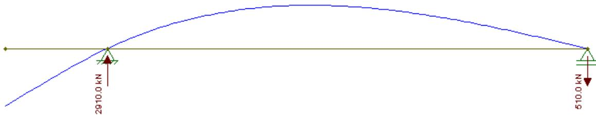
Figura 50 - Deslocamentos e reações de apoio da viga de equilíbrio – Exemplo completo
