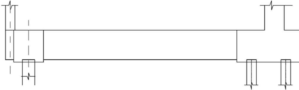
Figura 97 – Vista lateral da viga de equilíbrio dentro do bloco – Exemplo 3
