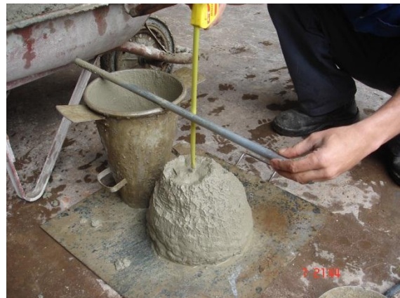
Ensaio de abatimento do tronco de cone.
