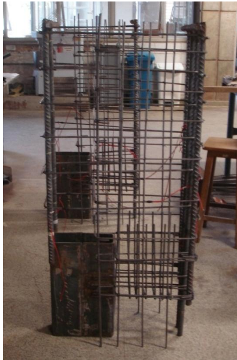
Figura 3.15 – Armadura da viga pré-moldada.
