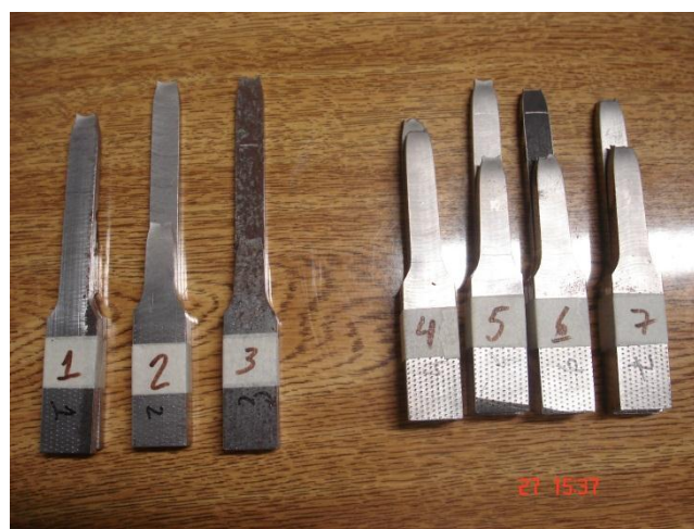
Figura 3.26 – Corpos de prova após ensaio de caracterização do aço dos perfis metálicos.
