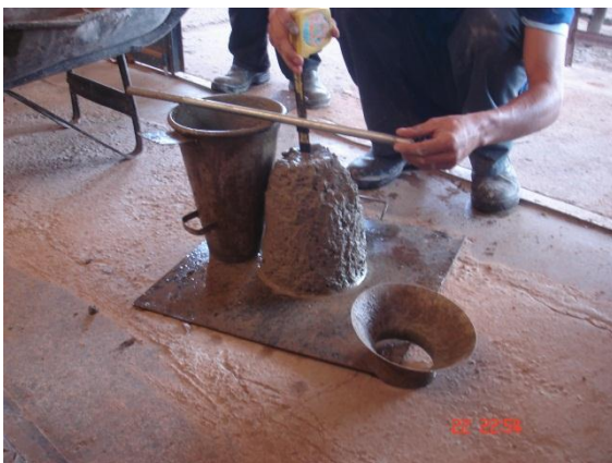
Ensaio de abatimento do tronco de cone.
