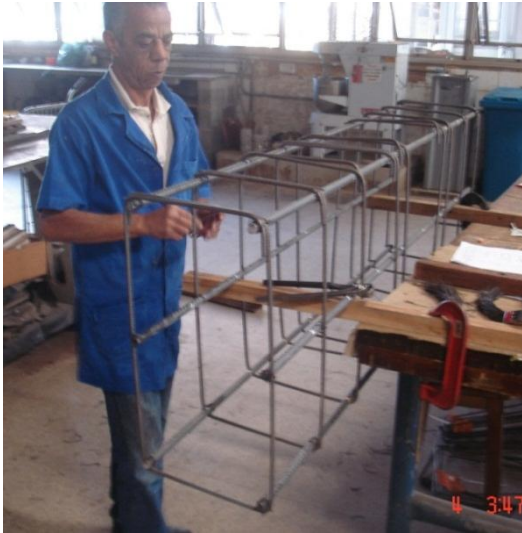
Figura 3.16 – Montagem da armadura do pilar pré-moldado.
