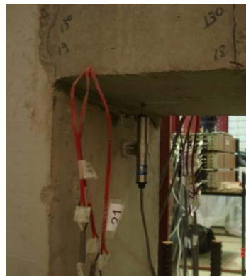
Transdutor abaixo da viga
