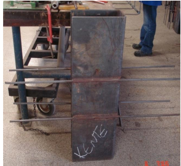
Figura 3.16 – Montagem da armadura do pilar pré-moldado.
