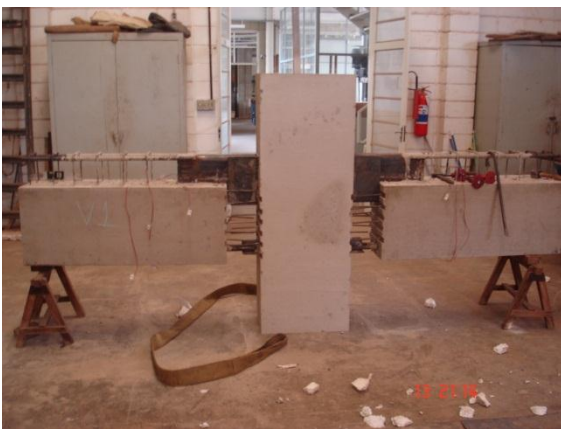
Vigas posicionadas e escoradas.
