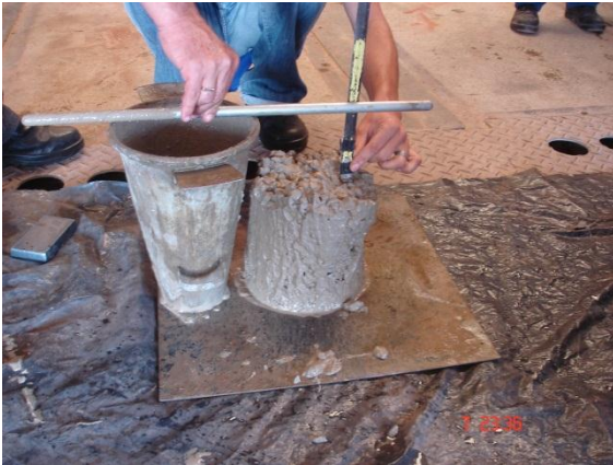
Ensaio de abatimento do tronco de cone.
