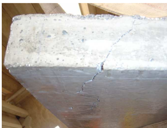
Figura 5.17 – Ruína do modelo L 2 A por ação da força cortante à direita.
