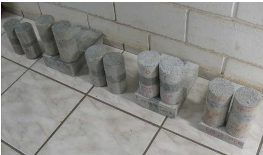
Figura An.1 – Corpos de prova de Concreto Leve com EPS para ensaios de carbonatação.
