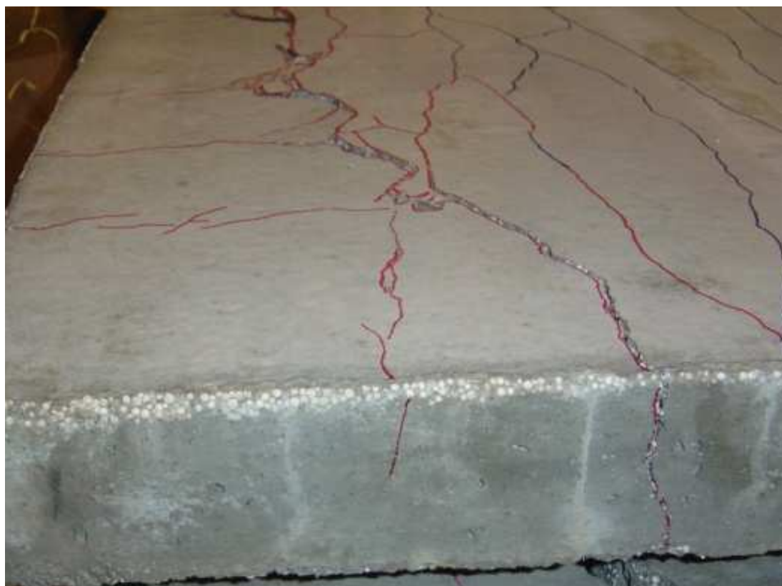
Figura 5.26 – Detalhe da ruína do modelo L 3 A por ação do momento fletor.
