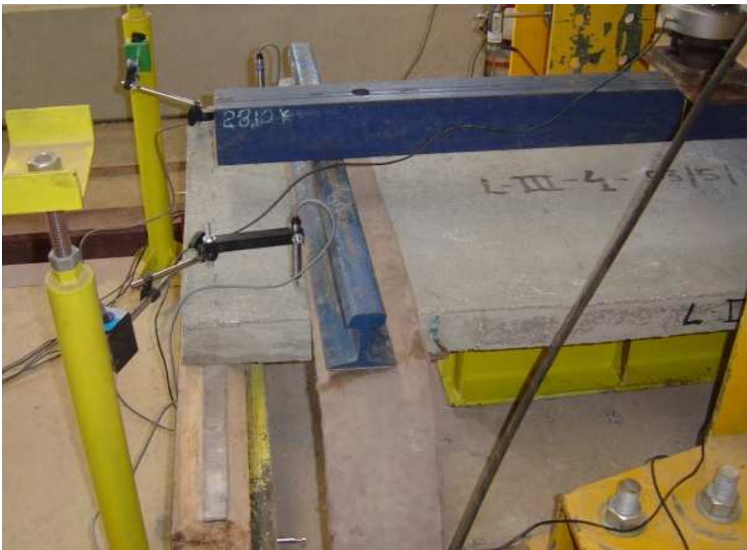
Figura 5.19 – Ruína do modelo de laje L 2 B por ação do momento à esquerda do trecho central.
