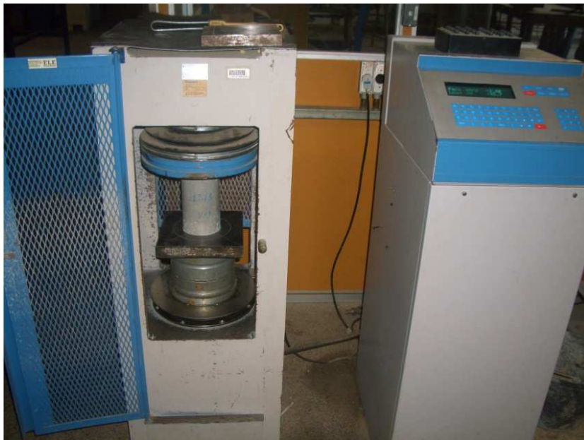
Figura 3.5 – Ensaio à compressão de corpo de prova cilíndrico.
