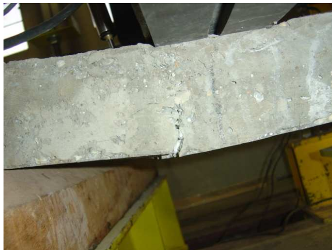
Figura Ap.2 – Detalhe da ruína do modelo L 3 C PU por momento fletor e força cortante.
