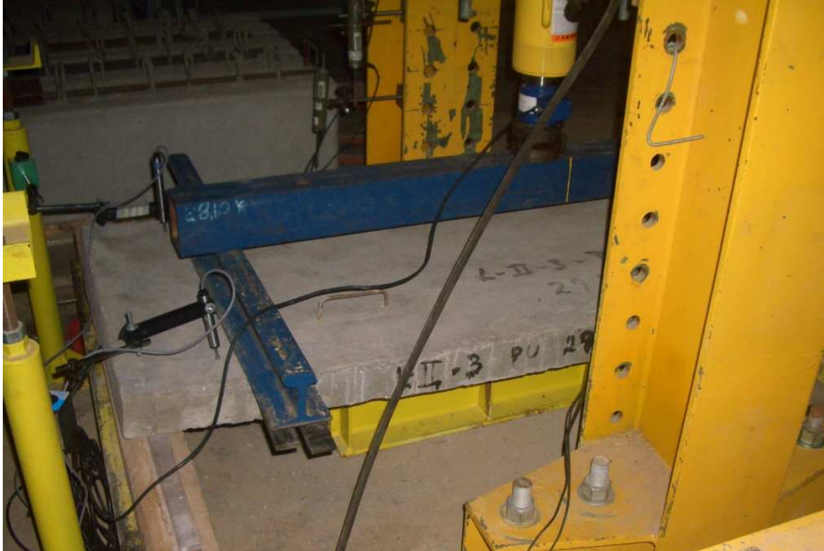
Figura 4.15 – Ensaio de cisalhamento de laje unidirecional.
