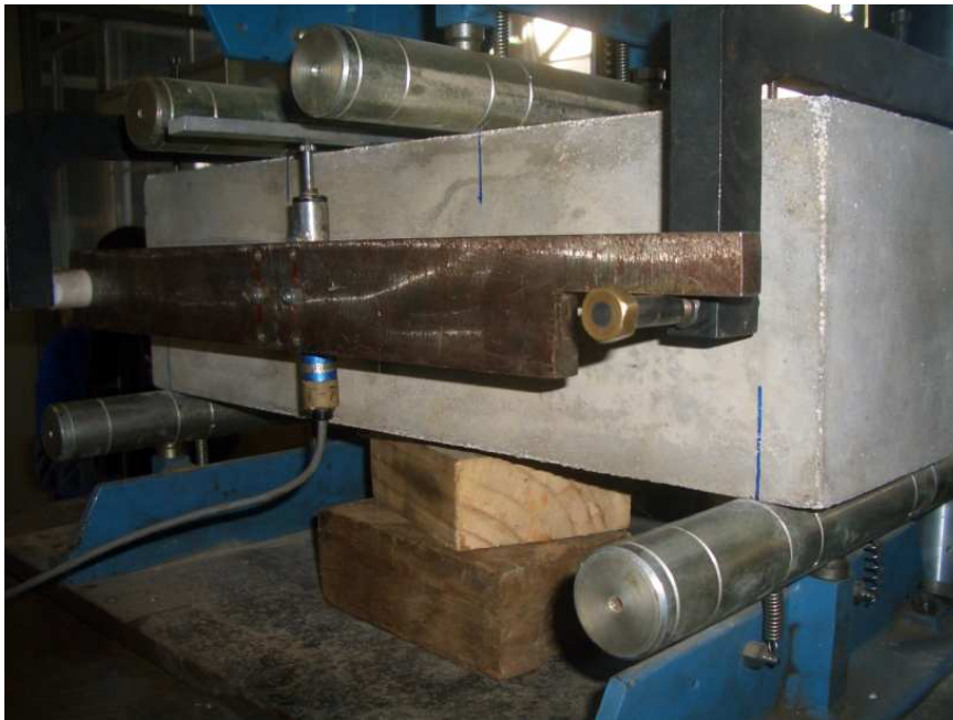
Figura 3.13 – Determinação da tenacidade no ensaio de tração na flexão.
