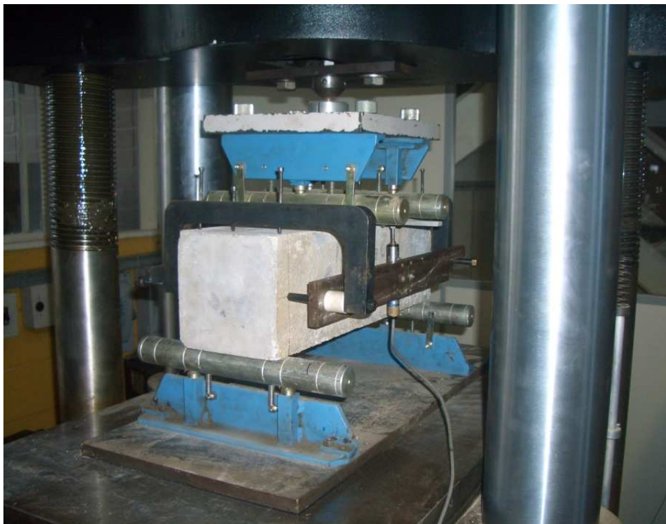
Figura 3.11 – Ensaio de tração na flexão de corpo de prova prismático.
