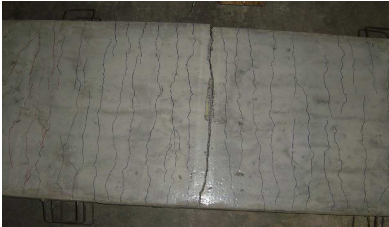
Figura 5.12 – Ruína do modelo L 1 B por ação do momento fletor no centro.
