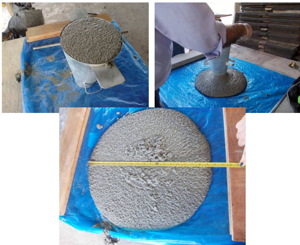
Figura 3.4 – Ensaio de espalhamento do Concreto Leve com EPS.
