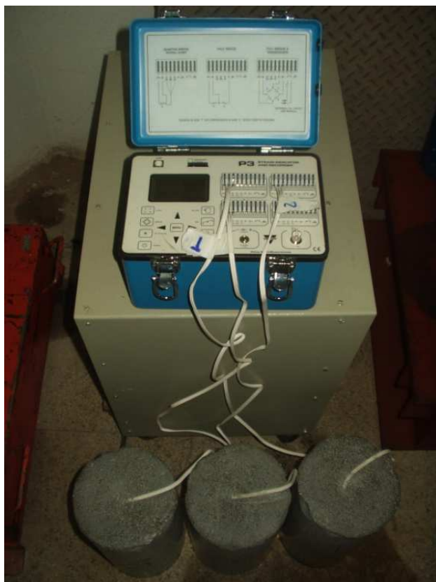
Figura 3.14 – Leitura da retração em três corpos de prova.
