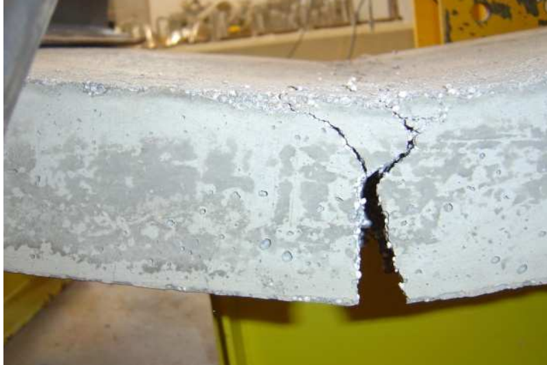
Figura 5.20 – Detalhe da ruína por ação do momento fletor do modelo L 2 B.
