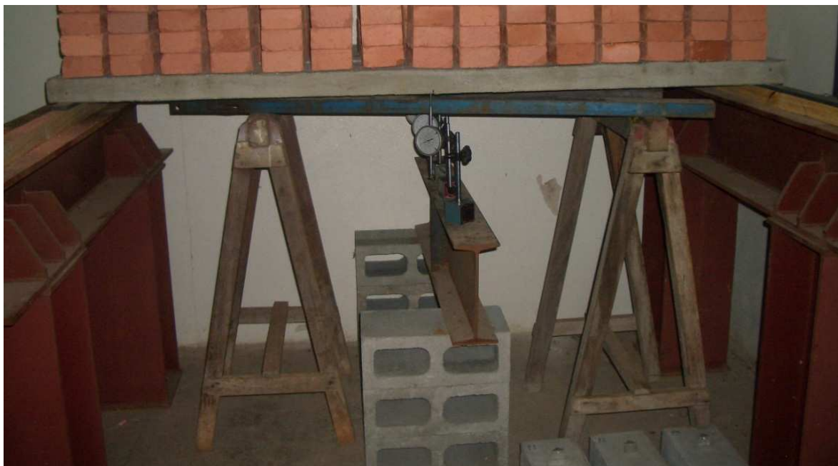
Figura 3.15 – Ensaio de deslocamentos ao longo do tempo para carregamento estático constante.
