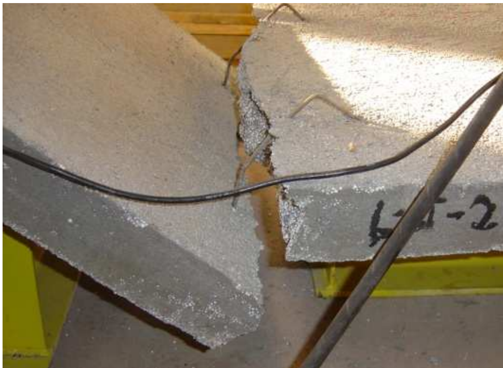
Figura 5.27 – Ruína do modelo L 3 B por ação do momento fletor, próximo ao apoio esquerdo.
