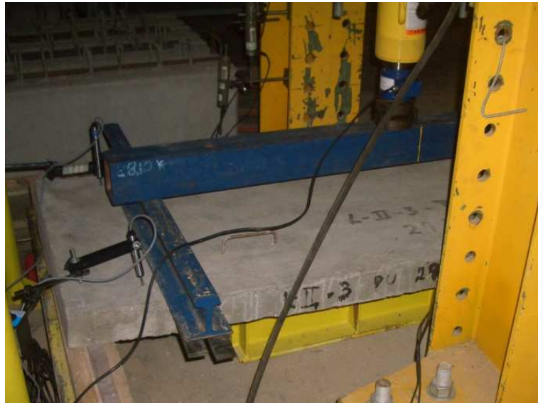
Figura Ap.1 – Ruína do modelo L 3 C PU próxima ao apoio esquerdo.
