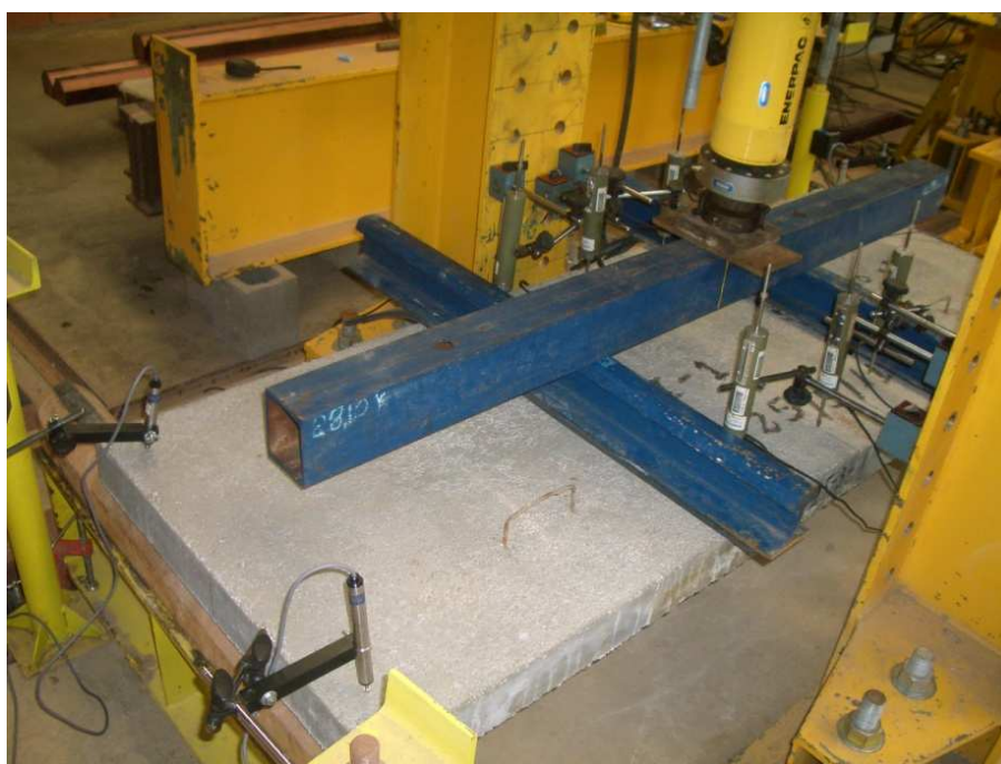
Figura 4.12 – Ensaio de flexão de laje unidirecional.
