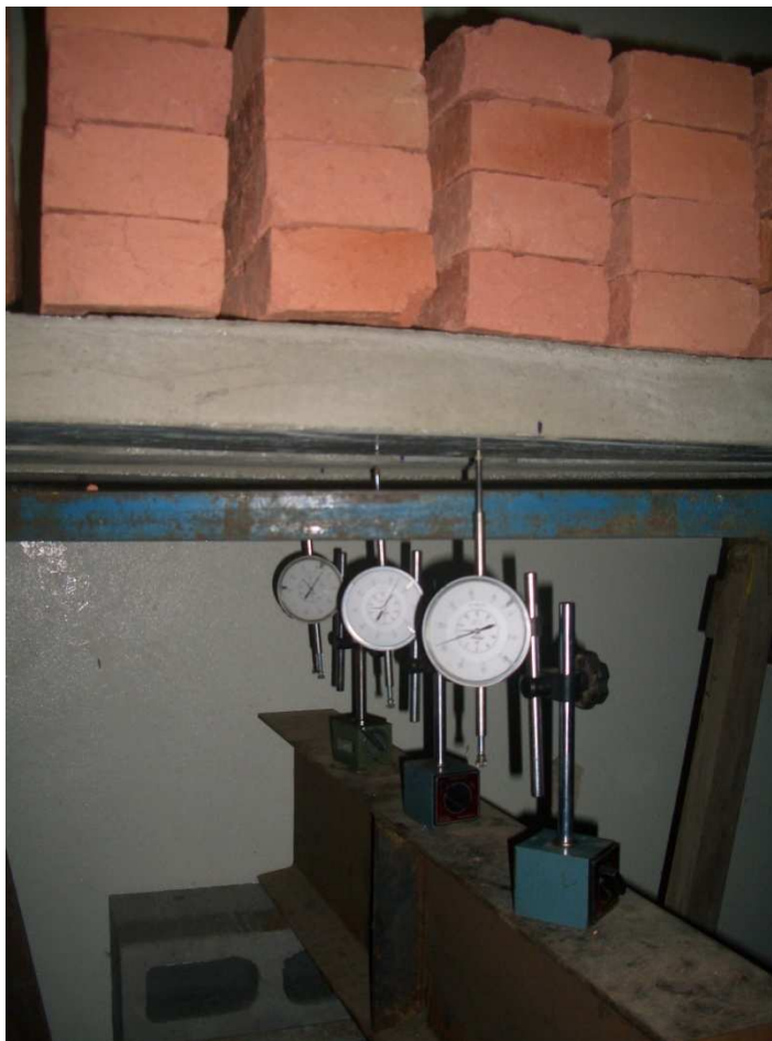
Figura 3.16 – Defletômetros para medir deslocamentos das vigotas ao longo do tempo.
