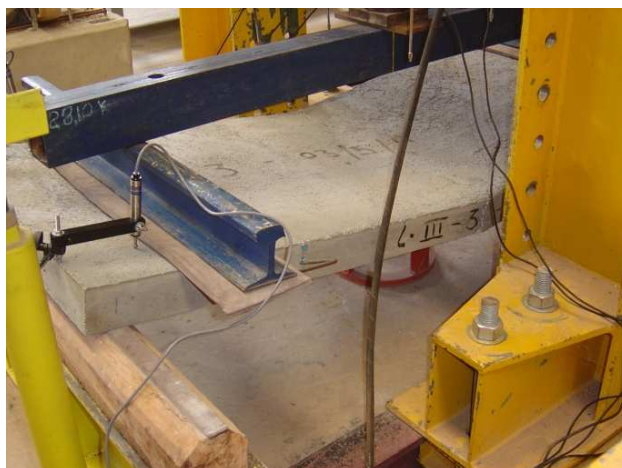
Figura 5.15 – Ruína do modelo de laje L 2 A por ação do momento fletor próximo ao centro.
