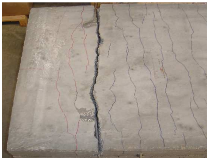
Figura 5.10 – Enfraquecimento da seção do modelo L 1 A pela alça.
