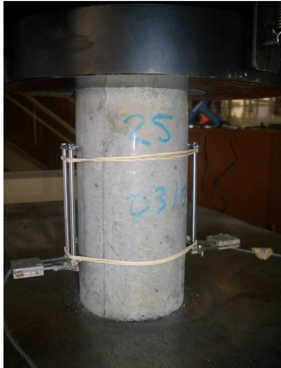
Figura 3.8 – Determinação do módulo de elasticidade em corpo de prova cilíndrico.
