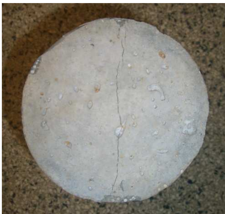
Figura 3.10 – Ruptura de corpo de prova por compressão diametral.
