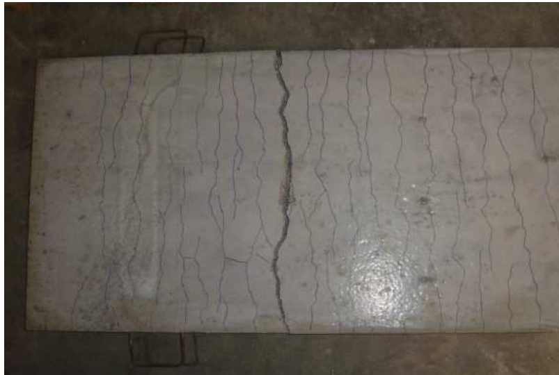
Figura 5.21 – Fissuras de momento fletor na região central do modelo L 2 B.
