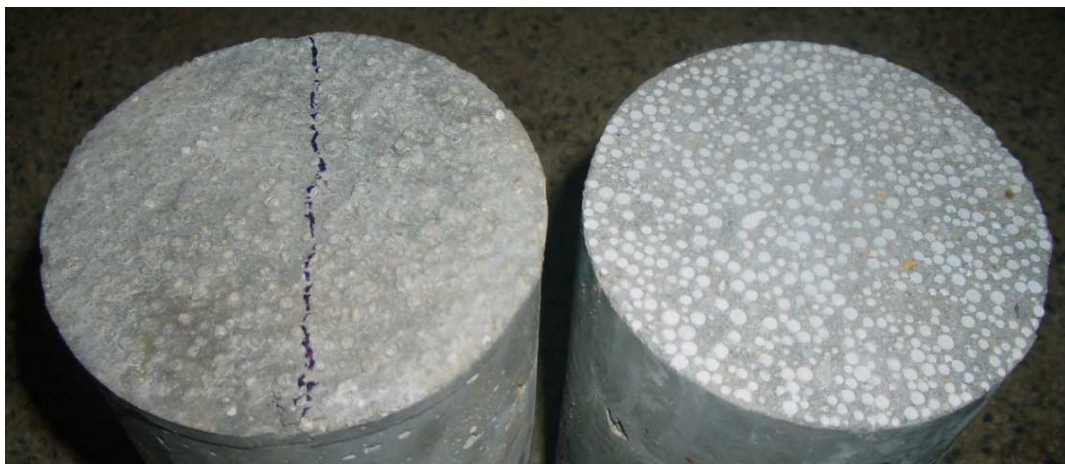
Figura 3.7 – Corpos de prova com superfície não retificada (esquerda) e retificada (direita).
