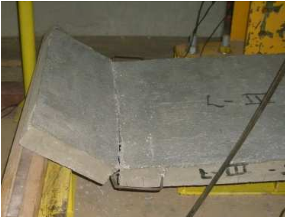
Figura 5.8 – Ruína do modelo L 1 A por ação do momento fletor na alça esquerda.
