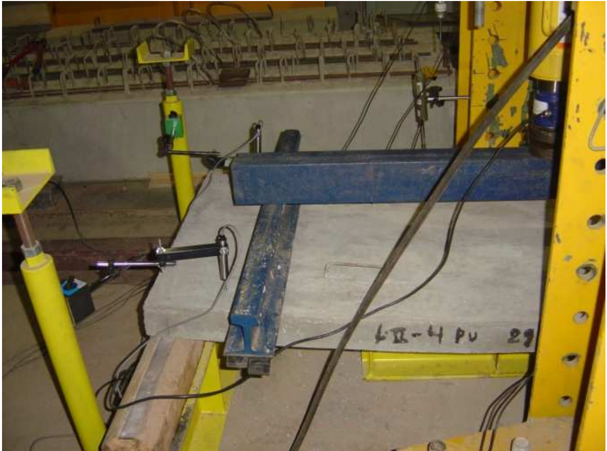
Figura Ap.5 – Ruína do modelo L 3 D PU por ação do momento fletor à esquerda.
