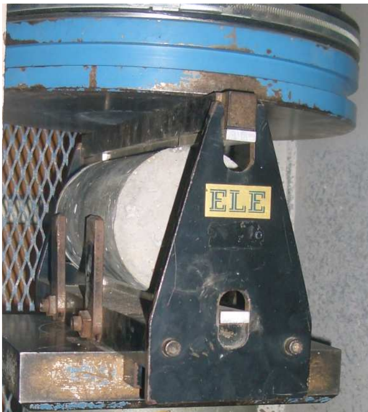
Figura 3.9 – Ensaio de tração na compressão diametral de corpo de prova cilíndrico.
