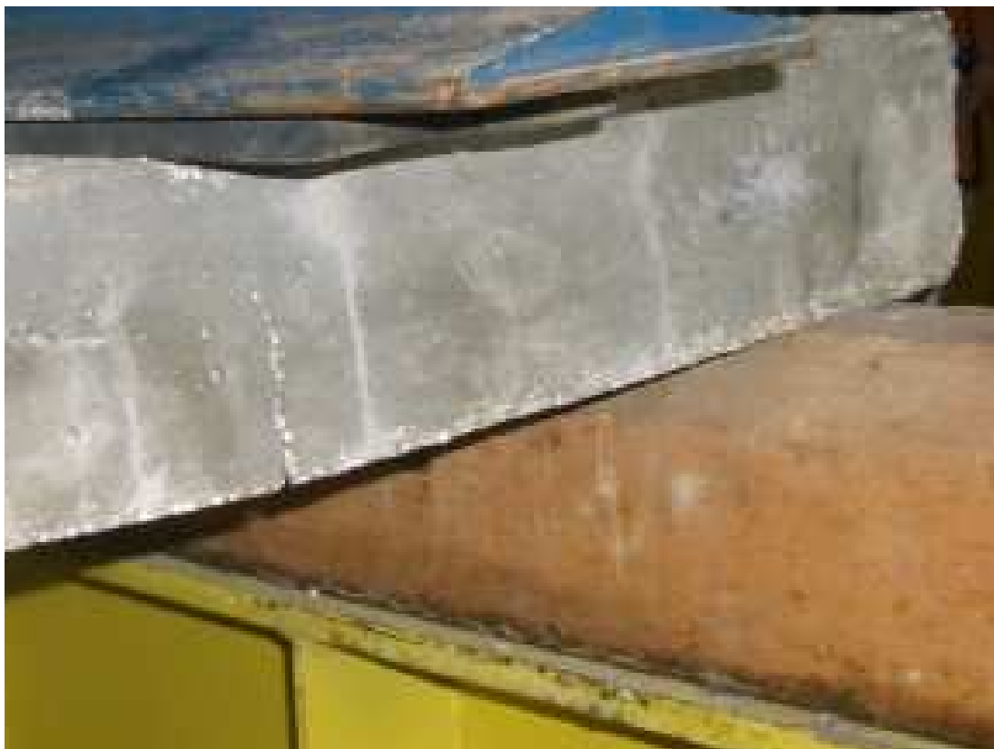
Figura 5.25 – Ruína do modelo L 3 A por ação do momento fletor, na face oposta.
