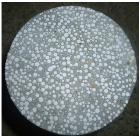
Figura 3.1 – Composição do concreto leve estrutural com pérolas de EPS.
