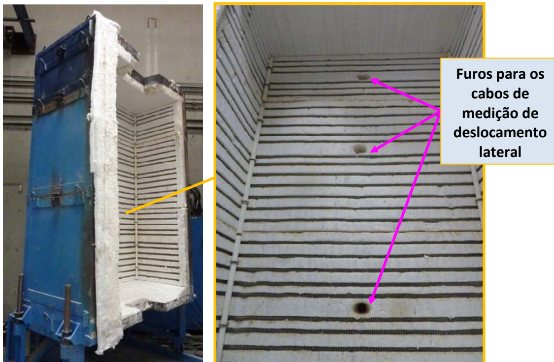
Figura 4.14 – Furos para passagem dos fios resistentes ao fogo utilizados para realizar a medição de deslocamento lateral
