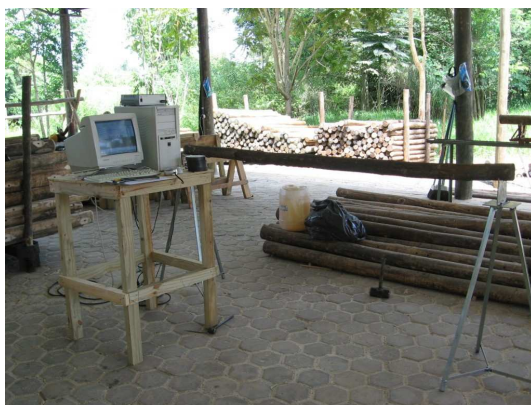
Figura 2.39 – Ensaio de vibração transversal em toras de pequeno diâmetro.
