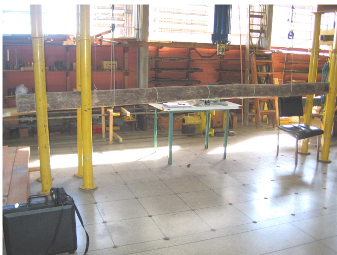
Figura 7.2 – Ensaio de vibração transversal na segunda amostra.
