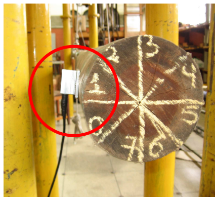
Figura 4.5 – Acelerômetro fixado em uma das toras.
