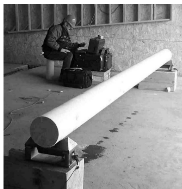
Figura 2.38 – Teste de vibração transversal com toras torneadas.
