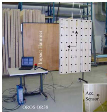
Figura 2.31 – Ensaio de vibração transversal em placa laminada.
