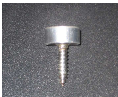
Figura 4.11 – Pino de impacto com cabeça de alumínio empregado nos ensaios com as toras mais curtas.
