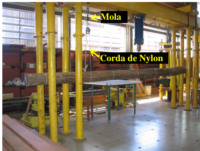
Figura 4.4 – Suspensão das toras com cordas de Nylon.
