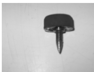
Figura 4.6 – Pino de impacto com a cabeça revestida de borracha.
