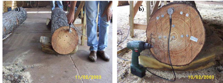
Figura 2.21 – Ensaio de ondas de tensão em toras de Pinus taeda .
