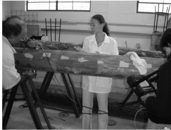
Figura 2.19 – Medição da velocidade de propagação da onda ultrassônica na direção radial de postes de madeira.
