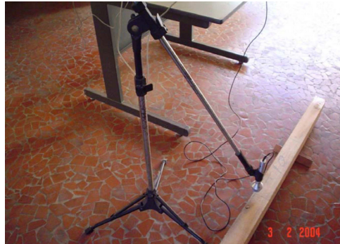
Figura 2.27 – Ensaio de vibração transversal em vigas de Angelim Araroba.
