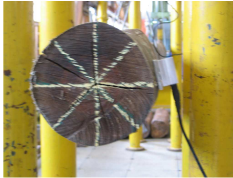
Figura 4.24 – Desalinhamento do acelerômetro na tora 6 devido à irregularidade na superfície.
