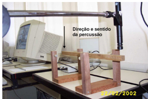
Figura 2.24 – Ensaio de vibração transversal realizado por Ballarin et al (2002).
