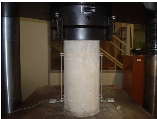
Figura 7-2 - Ensaio de compressão axial para determinação do módulo de elasticidade.
