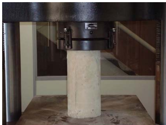
Figura 7-1 - Ensaio de compressão axial para determinação da resistência à compressão.
