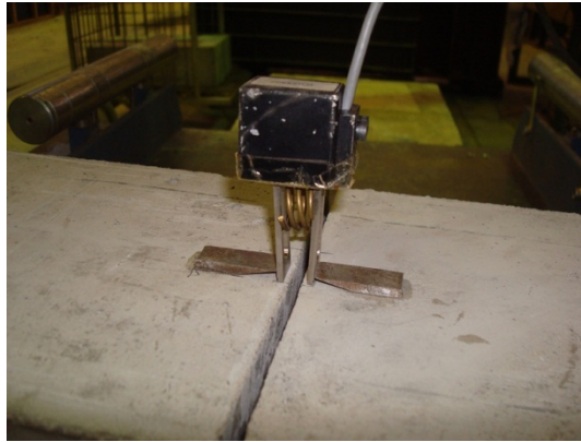
Figura 7-6 - Detalhe da instalação do clip gauge.
