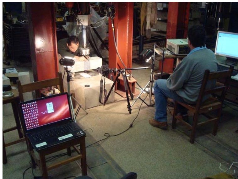
Figura 7-7 - Esquema geral para o ensaio de flexão em três pontos com aquisição de imagens.
