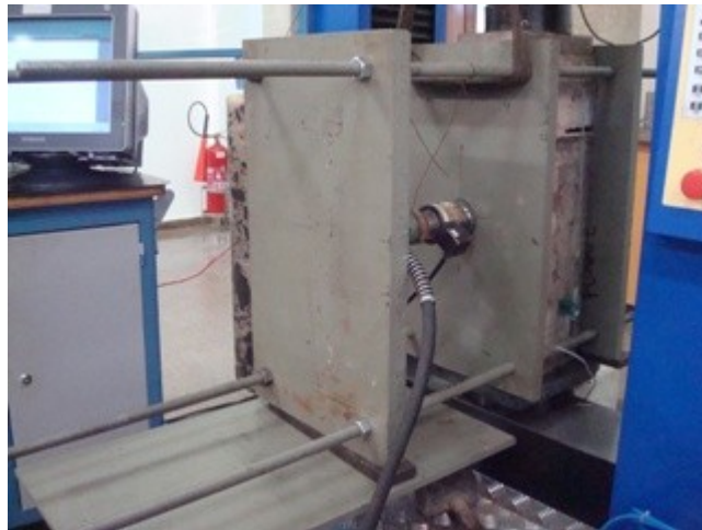
Figura 4.13 – Instrumentação usada nos ensaios de cisalhamento direto.
