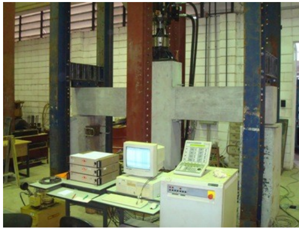
Figura 4.27 – Esquema de ensaios cíclicos em modelos cruciformes.
