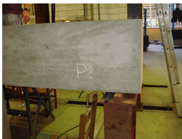
(b) Apoio do modelo no ensaio dinâmico
