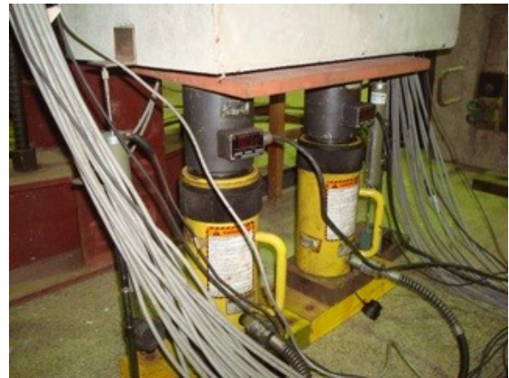
(b) Macacos hidráulicos e células de carga
