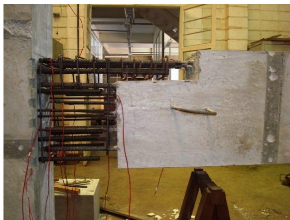
(c) Instalação dos estribos na região da ligação
