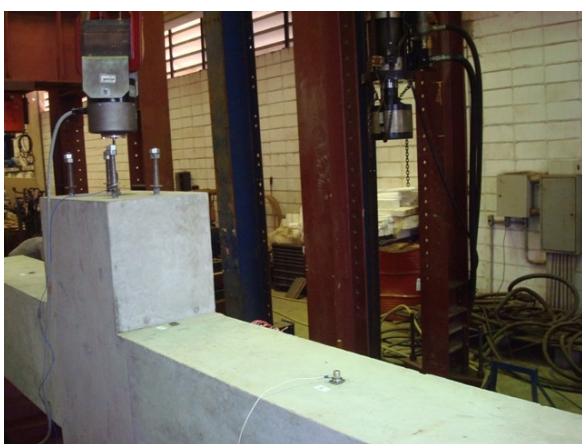
(a) Modelo montado fora do pórtico de reação
