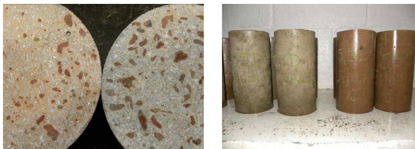
Figura 67: Diferença na coloração dos concretos lateríticos controle (coloração avermelhada) e dopado (coloração esverdeada).
