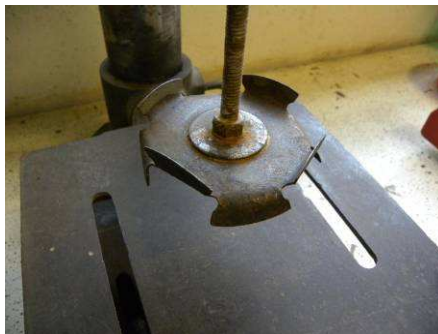
Figura 40: Disco giratório usado no preparo da solução de água e sílica ativa.
