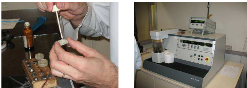
Figura 50: Colagem com tinta prata e recobrimento com ouro
