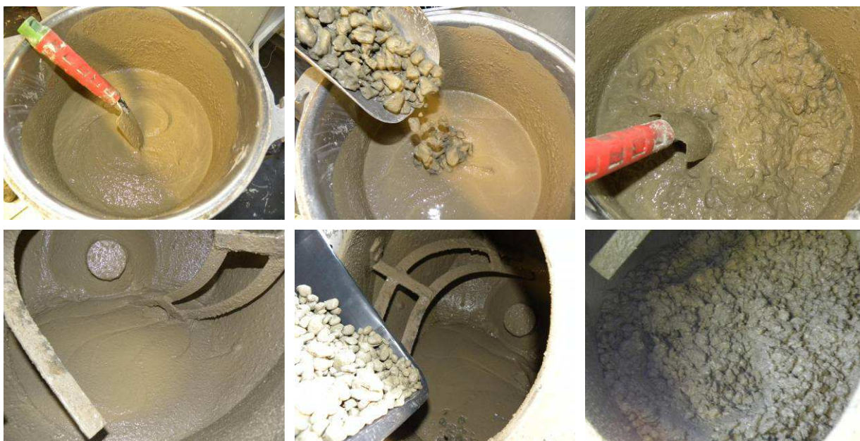
Figura 66: Etapas da confecção dos concretos dopados elaborados com laterita (linha superior) e com seixo rolado (linha inferior): aglomerantes, agregados miúdos e água homogeneizados (à esq.), lançamento do agregado dopado (centro) e mistura final (à dir.).
