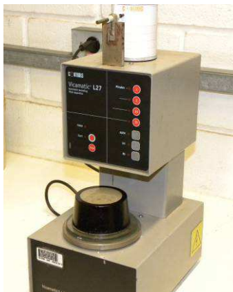
Figura 38: Ensaio de tempo de pega realizado nas caldas de impregnação
