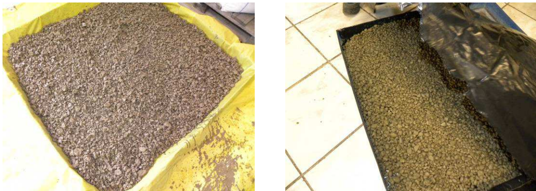
Figura 42: Agregados dopados com calda de alto desempenho e cobertos com saco plástico: laterita (à esquerda) e seixo rolado (à direita).
