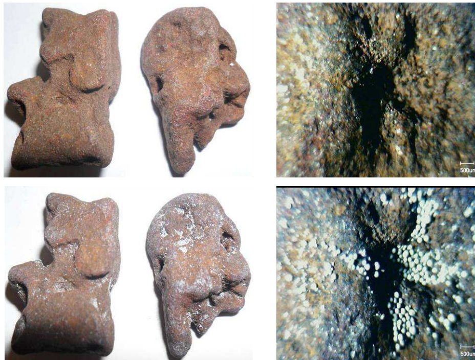
Figura 76: Comparação de partículas de laterita sem (linha superior) e com (linha inferior) impregnação de solução de água e sílica ativa.
