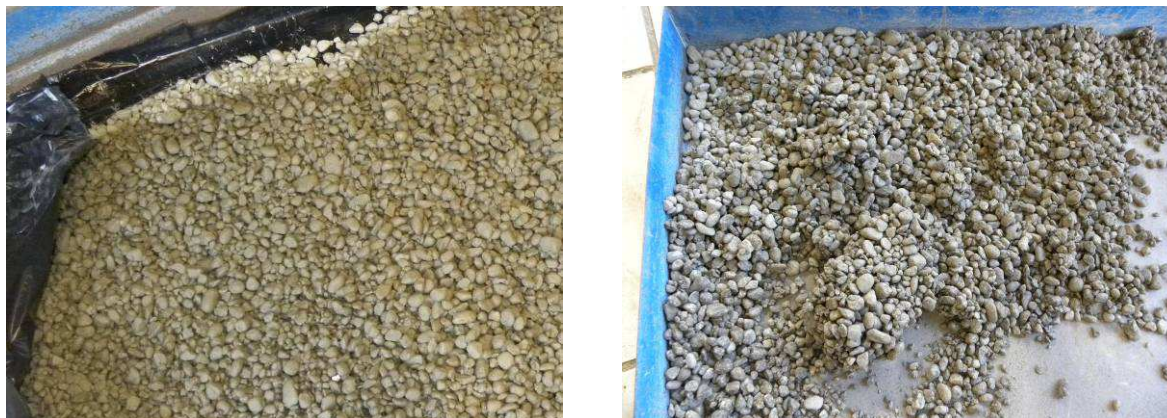
Figura 45: Seixo com impregnação em início de pega (à esquerda) e após 24 horas de impregnação (à direita).
