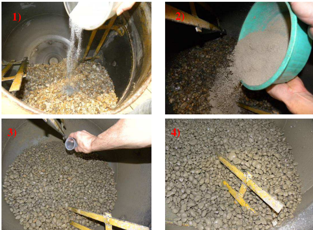
Figura 44: Etapas conjuntas dos procedimentos de mistura dos materiais da calda de alto desempenho e dopagem dos agregados graúdos.
