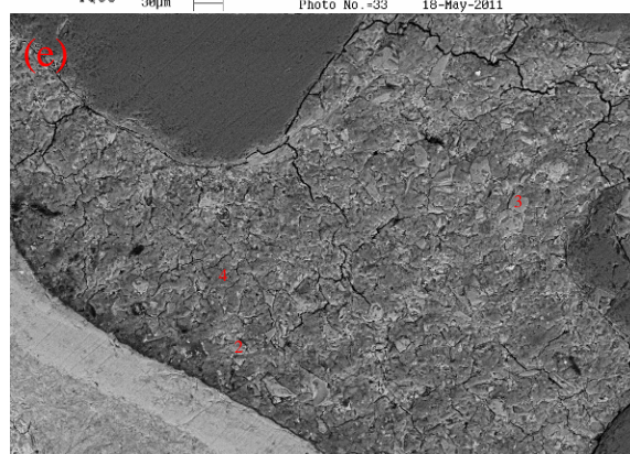
Figura 91: Micrografias (100x até 500x) para amostra polida de LD-Comp2. (a), (b) e (c): ZT abaixo do agregado; (d), (e) e (f): ZT acima do agregado.
