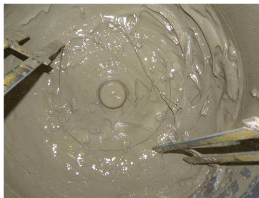
Figura 60: Fluidez da calda de alto desempenho após lançamento atrasado do aditivo superplastificante.
