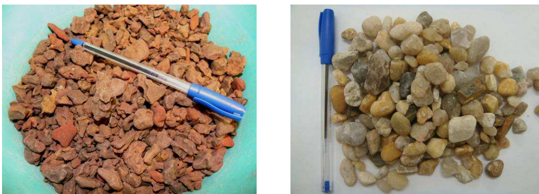
Figura 53: Forma, textura superficial e coloração da laterita (à esq.) e do seixo rolado (à dir.).
