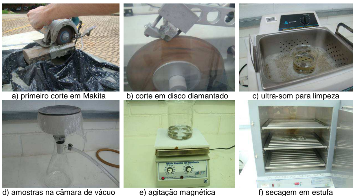
Figura 47: Etapas de preparação das amostras de concreto
