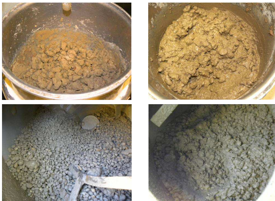
Figura 65: Etapas principais da confecção dos concretos controles com laterita (linha superior) e com seixo rolado (linha inferior): agregado graúdo, aglomerantes e água homogeneizados (à esq.) e mistura final (à dir.).
