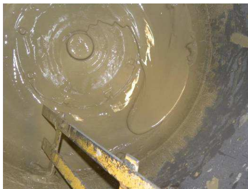
Figura 39: Calda de alto desempenho preparada em misturador mecânico.
