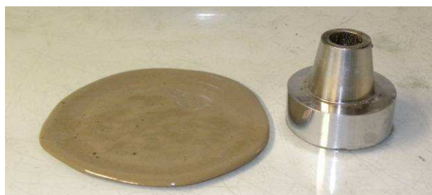
Figura 37: Ensaio de miniabatimento: espalhamento da pasta
