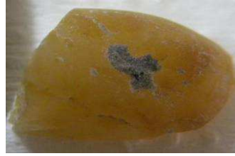
Figura 140: Permanência da camada de impregnação no agregado.
