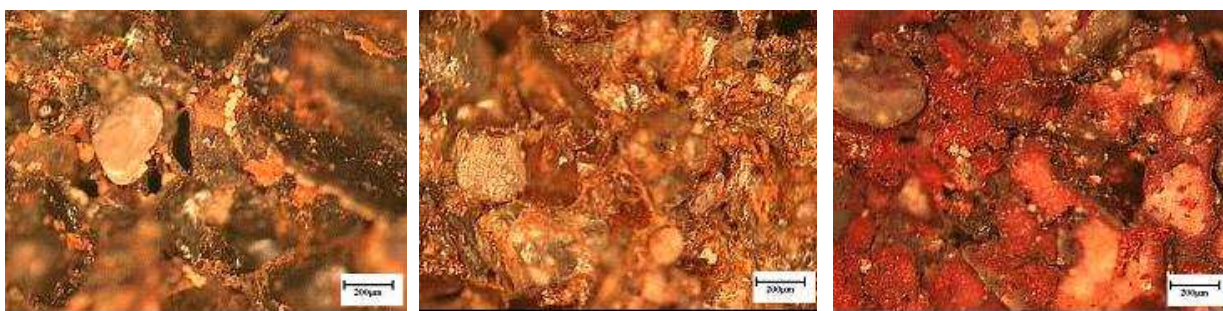
Figura 13: Amostras de lateritas em microscópio ótico (aumento de 50 vezes). Fonte: Futida (2005).
