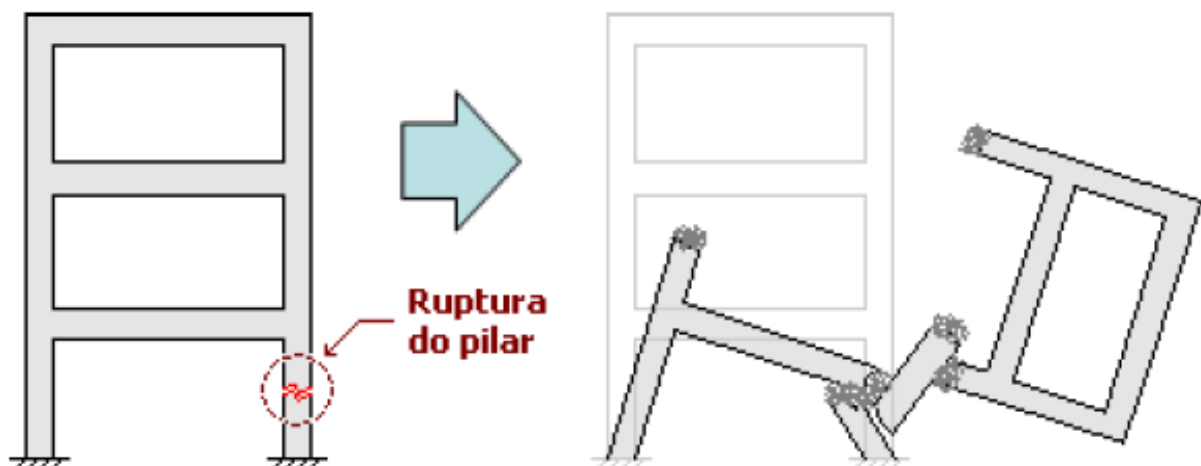
Figura 2.18 – Ruína de uma estrutura em decorrência da ruptura de um pilar (KIMURA, 2010).
