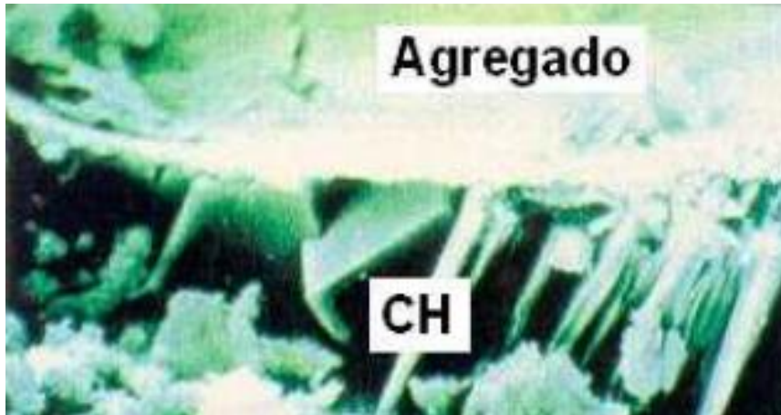
Figura 2.5 – Microscopia eletrônica da zona de transição (Adaptado de DAL MOLIN, 1995).
