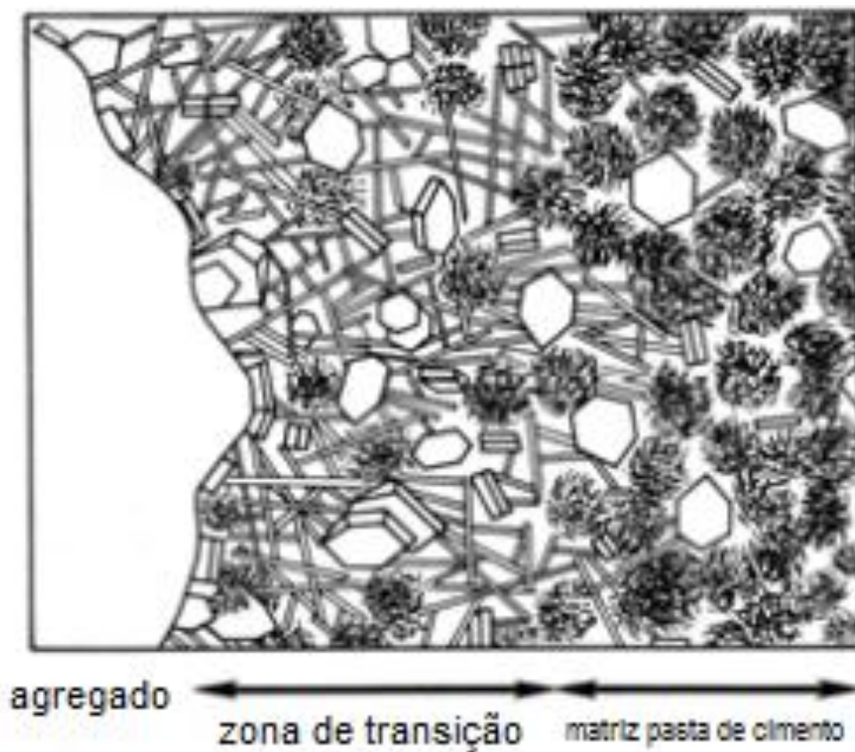
Figura 2.2 – Fases Constituintes do concreto no estado endurecido (Adaptado de MEHTA; MONTEIRO, 2008).
