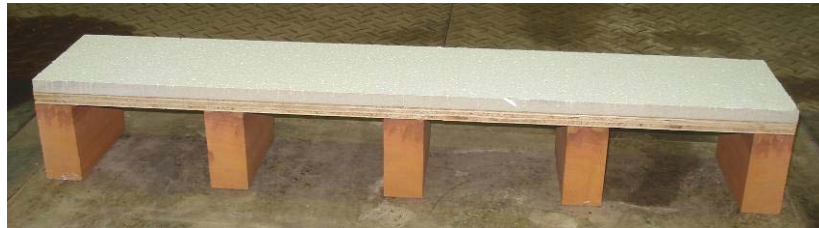
Figura 3.15 – Base de madeira para o sustento das mini-paredes e forro pacote para o capeamento das mesmas
