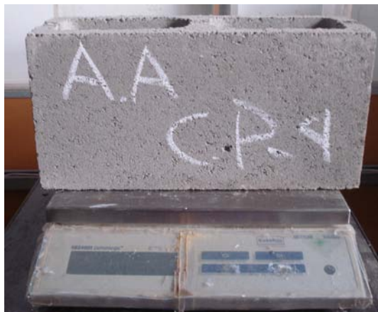
Figura 3.7 – Determinação da massa do bloco seco ao ar ( m_3 )
