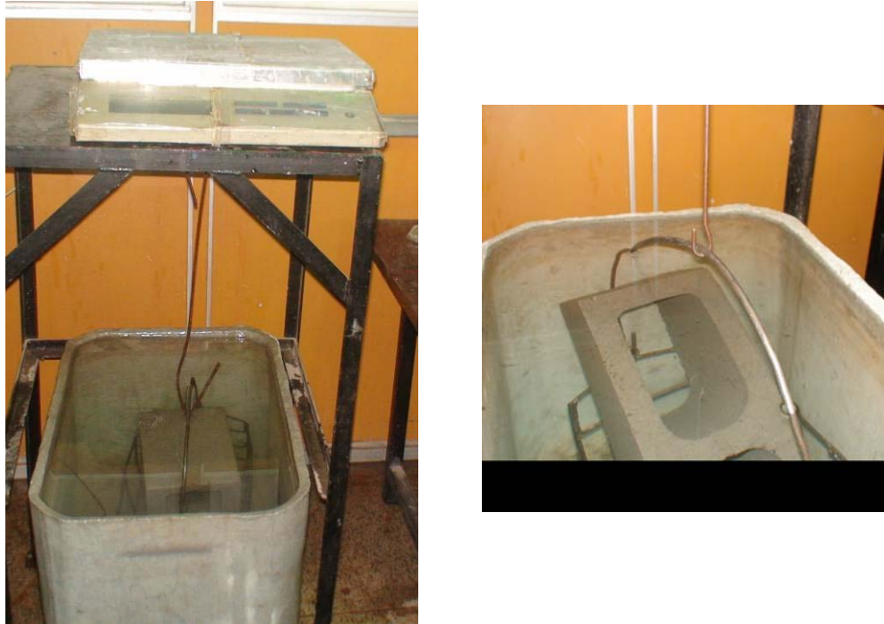
Figura 3.10 – Blocos emergidos em água na balança hidrostática para determinar sua massa aparente ( m_4 )
