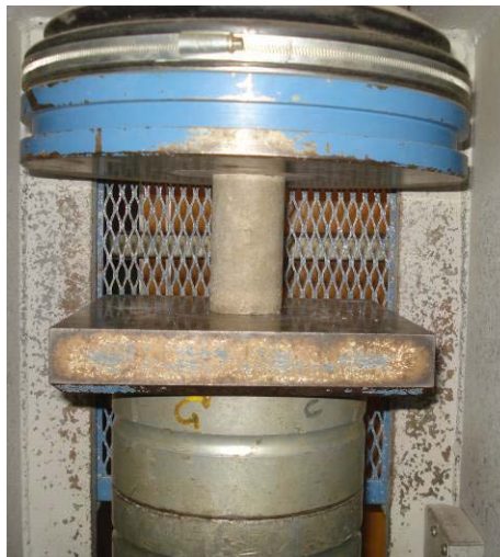
Figura 3.20 – Ensaio à compressão da argamassa
