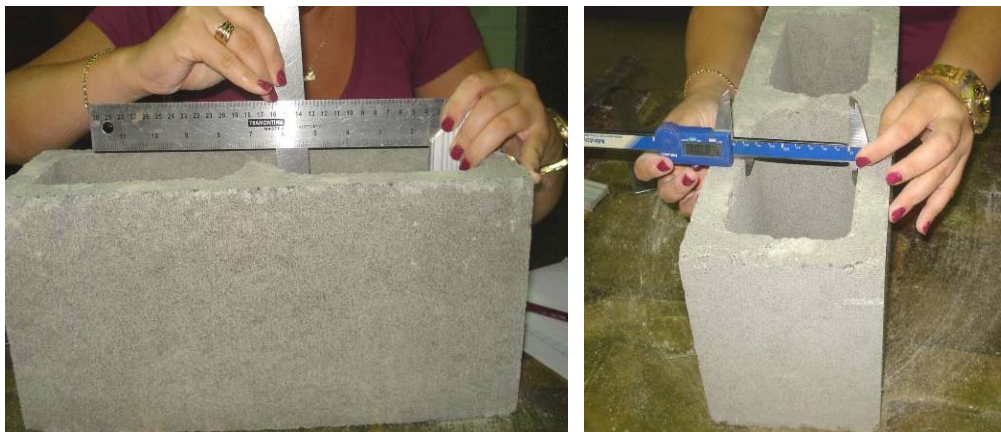
Figura 3.6 – Medição das dimensões dos furos dos blocos
