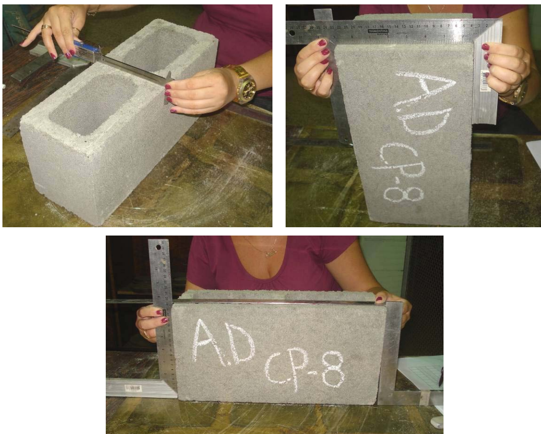
Figura 3.4 – Medição da largura, altura e comprimento dos blocos
