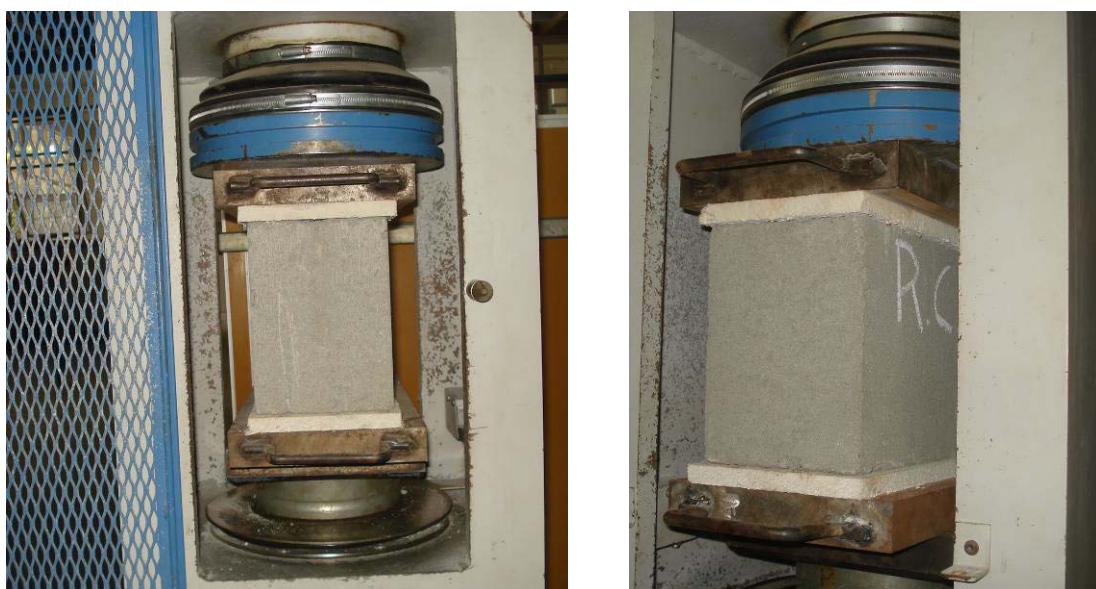
Figura 3.22 – Ensaio à compressão dos blocos de concreto na prensa.
