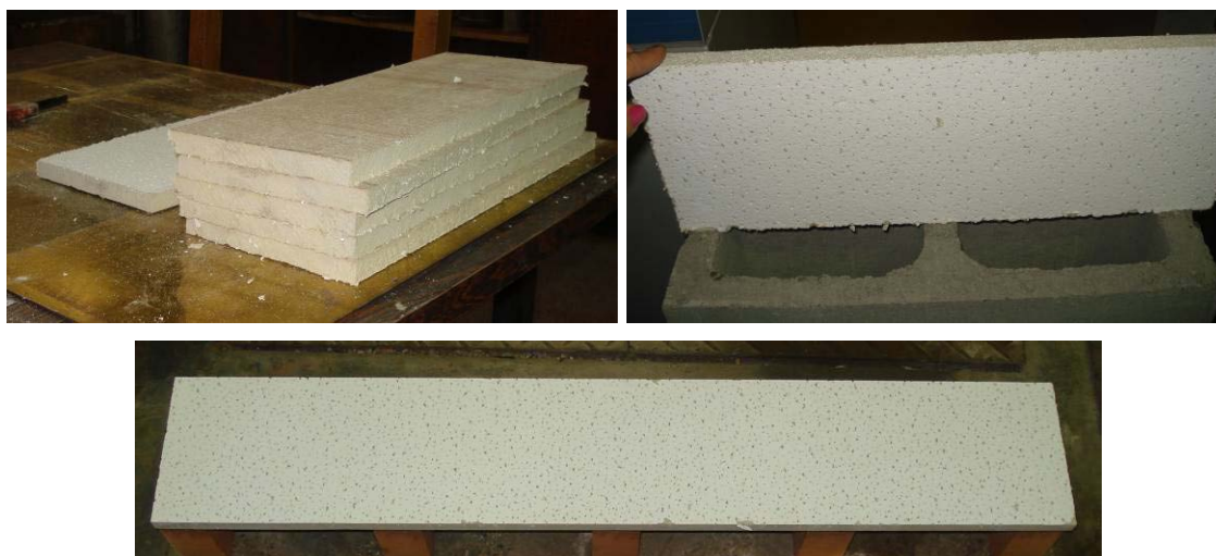
Figura 3.19 – Forro pacote utilizado como material de capeamento nos corpos-de-prova
