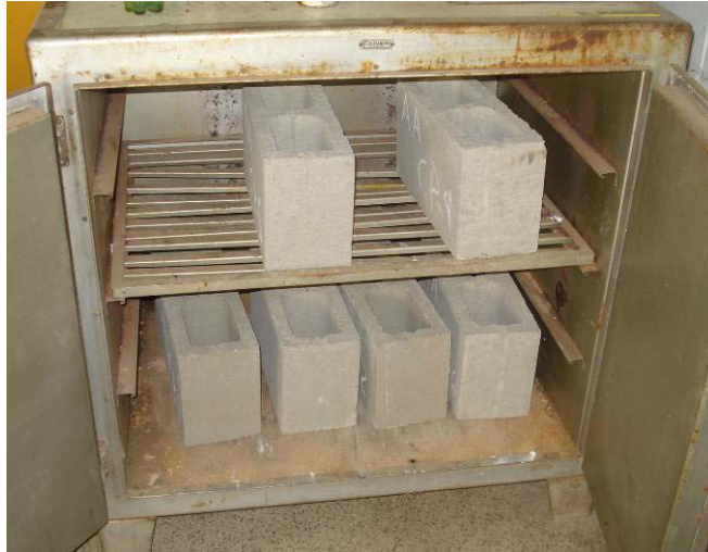
Figura 3.8 – Blocos colocados na estufa para a determinação da massa seca ( m_1 )
