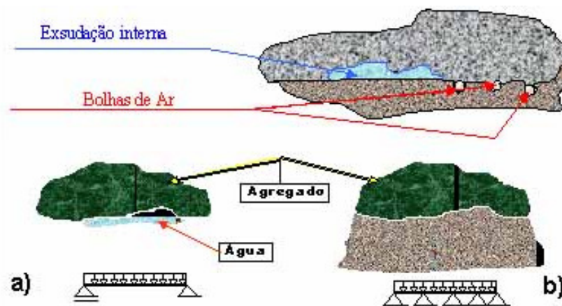
Figura 10 – Idealização do comportamento de agregados com diferentes interfaces devido à exsudação interna. Fonte: Liborio (2003).
