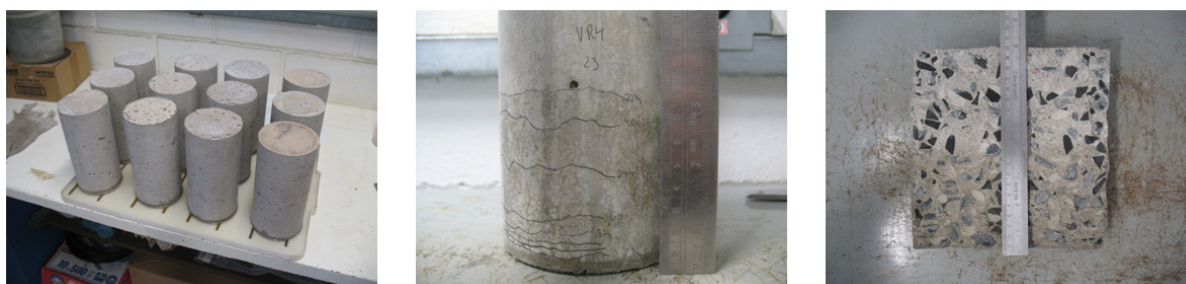
Figura 24 – Ensaio de Absorção por capilaridade: corpos de prova sobre lâmina de água de 5 mm (esquerda); marcação externa do nível da água capilar (centro); corpo de prova rompido diametralmente para avaliação interna de umidade (direita).
