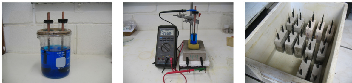
Figura 31 – Medida de potencial de corrosão: eletrodos padrão em solução de sulfato de cobre saturada (esquerda); medição do potencial de corrosão com sistema todo conectado (centro); fase de imersão parcial dos corpos de prova em solução de NaCl a 3,5 % (direita).
