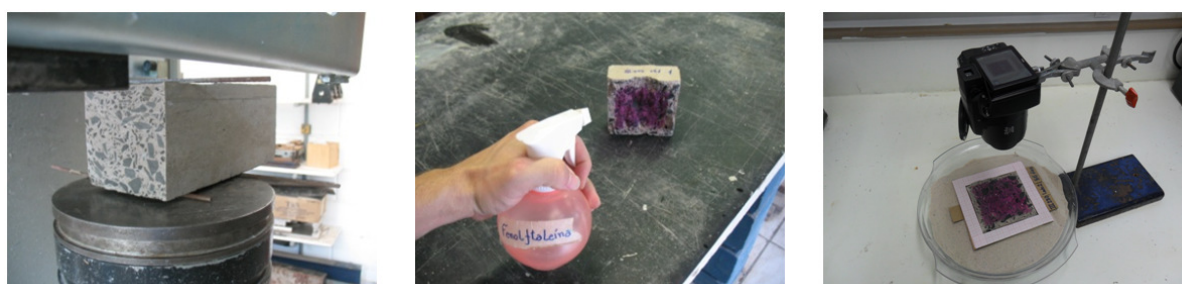
Figura 27 – Determinação da profundidade de carbonatação: extração de fatia (esquerda); aspersão de fenolftaleína (centro); montagem do sistema de fotografia (direita).
