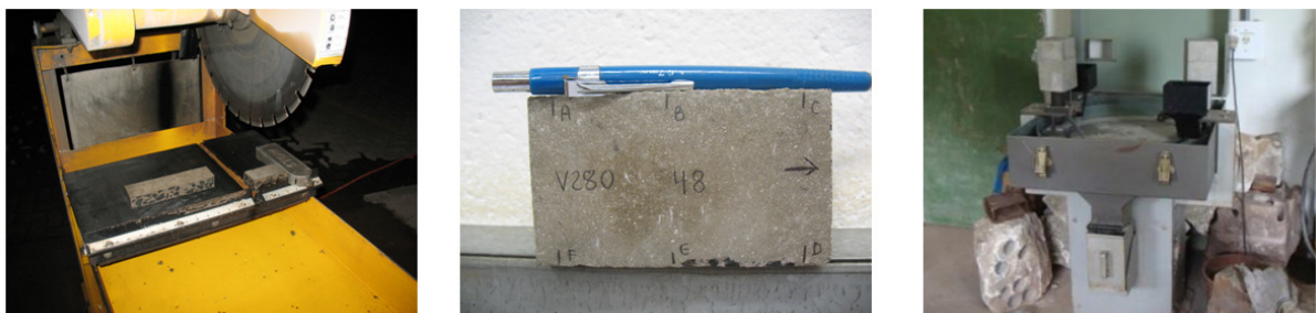
Figura 25 – Ensaio de abrasão: corte dos corpos de prova a partir de uma placa (esquerda); corpo de prova com marcação de pontos de medida de espessura (centro); máquina de abrasão (direita).
