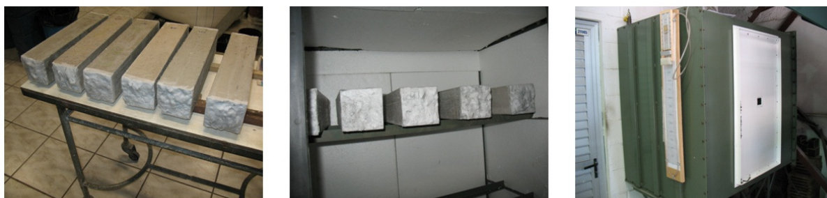
Figura 26 – Ensaio de carbonatação acelerada: corpos de prova prismáticos com topos selados com parafina (esquerda); corpos de prova dispostos no interior da câmara (centro); aspecto geral da câmara, com porta, termômetro e manômetro externo (direita).
