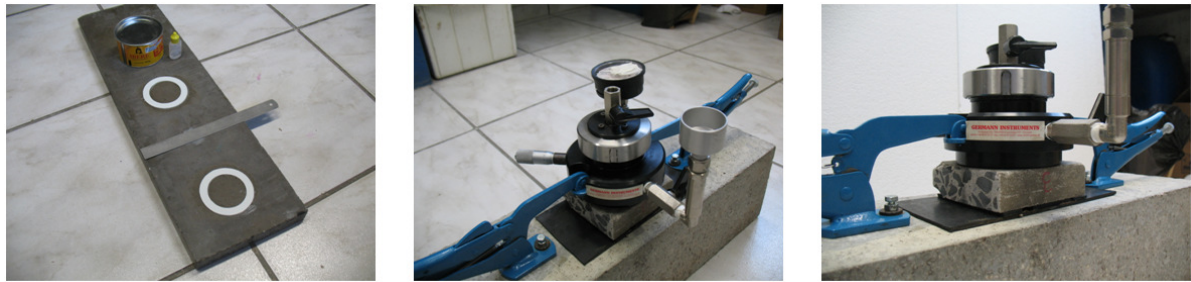
Figura 32 – Ensaio rápido de permeabilidade: placa de concreto com anéis de PVC fixados (esquerda); aparato montado sobre amostra de concreto, mostrando registros superior e lateral com funil, manômetro e micrômetro lateral (centro); vista lateral mostrando aparato comprimido contra o corpo de prova por meio de presilhas (direita).
