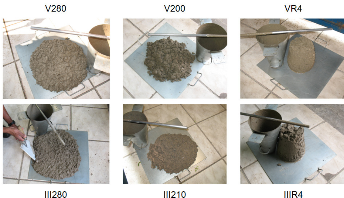
Figura 42 – Aspecto dos concretos no estado fresco após ensaio de abatimento.
