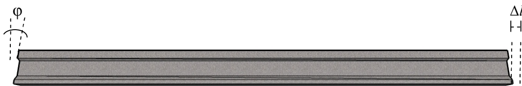
FIGURA 2.8 – Ilustração da rotação ( \phi ) e deslocamento axial ( \Delta l ) que aparecem nos extremos da viga.
