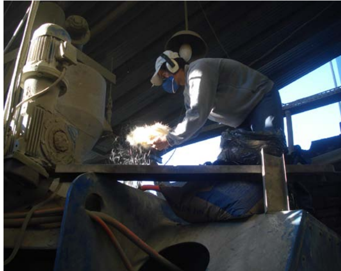
Figura 3.20: Colocação das fibras de sisal e o cimento no misturador
