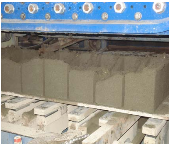
Figura 3.24: Blocos com fibras defeituosos
