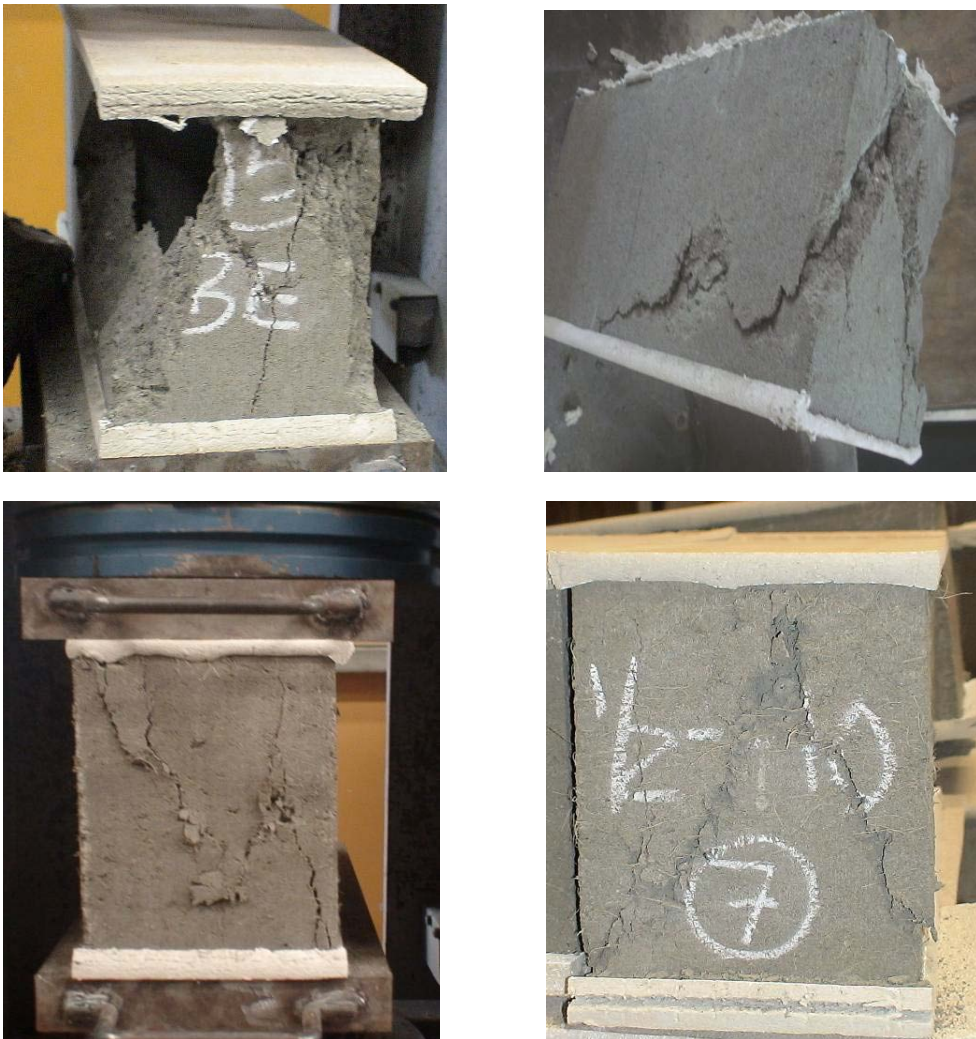
Figura 4.5: Ruptura típica dos blocos sob compressão
