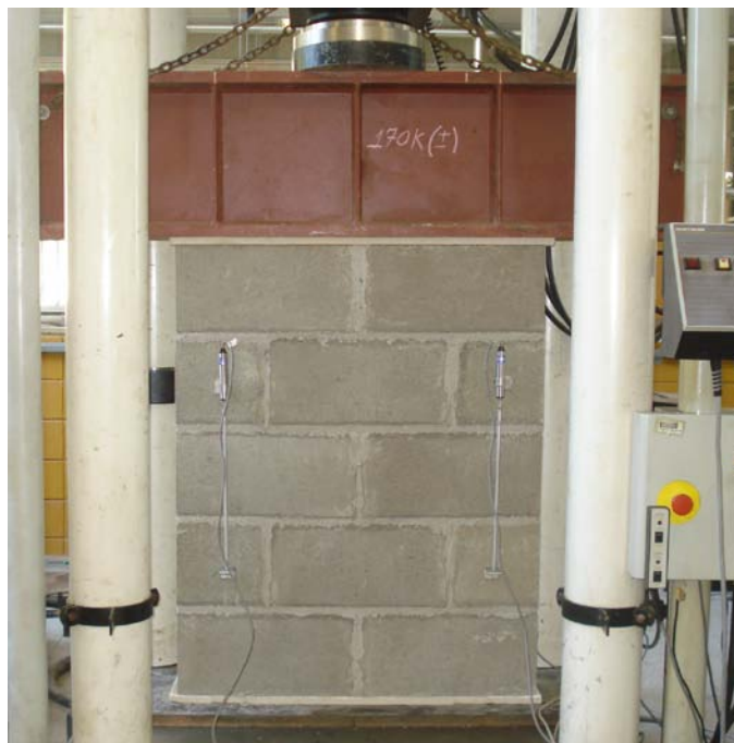
Figura 3.16: Ensaio de resistência à compressão das mini-paredes
