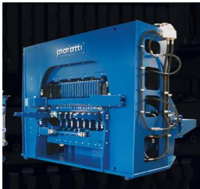
Figura 3.21: Vibro-prensa Piorotti- BLOCOPAC 1300 usada para a fabricação dos blocos ( http://www.piorotti.com.br )
