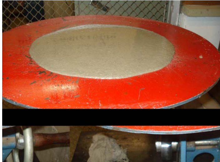
Figura 3.12: Ensaio de consistência da argamassa
