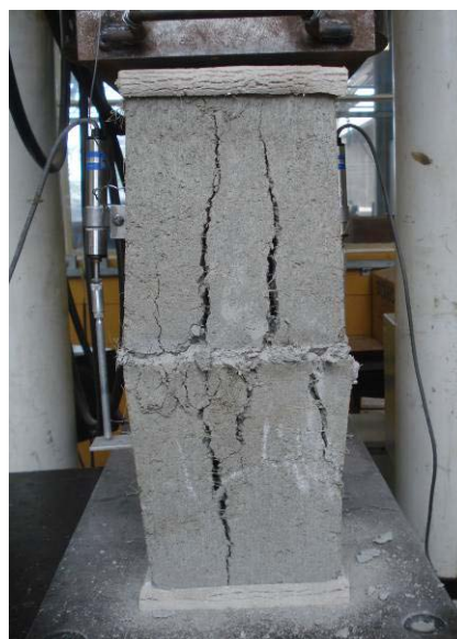
Ruptura frágil dos prismas sem fibras Ruptura dúctil dos prismas com fibras
