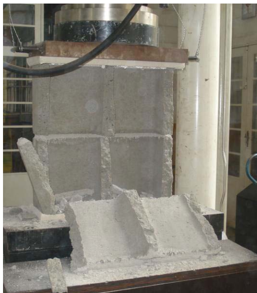
Ruptura frágil dos prismas sem fibras Ruptura dúctil dos prismas com fibras
