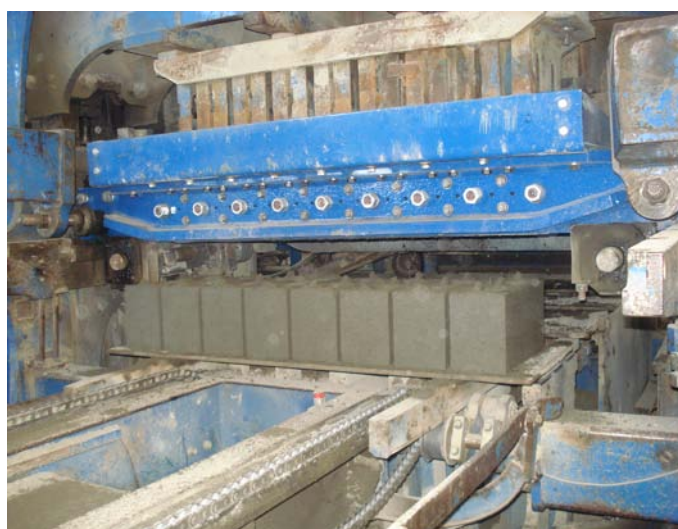
Figura 3.23: Desmoldagem dos blocos
