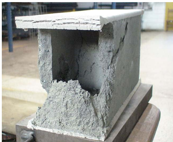
Figura 4.3: Ruptura frágil dos blocos sem adição de fibras
