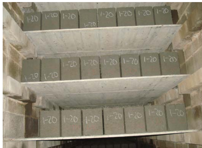
Figura 3.26: Blocos colocados no interior da câmara de cura
