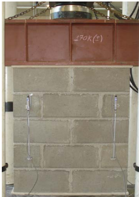
Figura 2.10: Mini-paredes de blocos de concreto ensaiado à compressão axial
