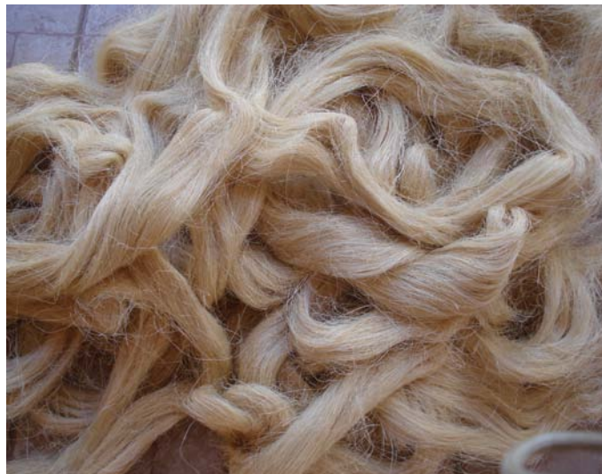
Figura 3.3: Fibra de sisal Tipo 3 com tratamento à base de óleo mineral
