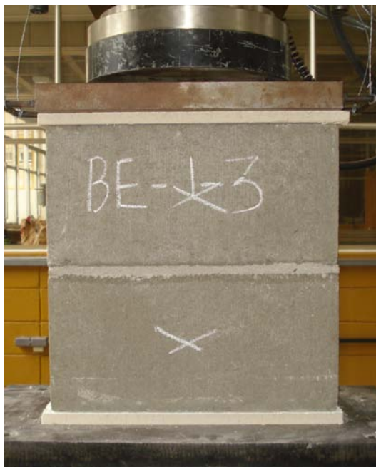
Figura 3.15: Ensaio de resistência à compressão dos prismas
