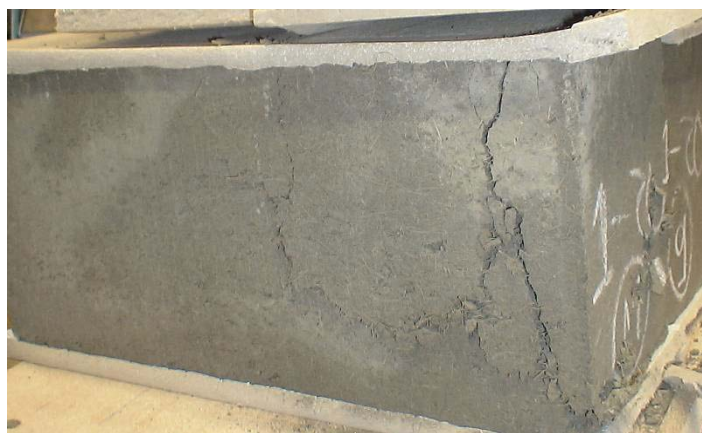
Figura 4.4: Ruptura dúctil dos blocos com adição de fibras
