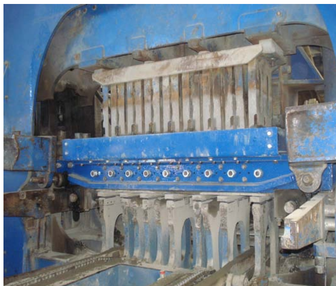
Figura 3.22: Descida dos contra-moldes ou pente com acionamento de vibração
