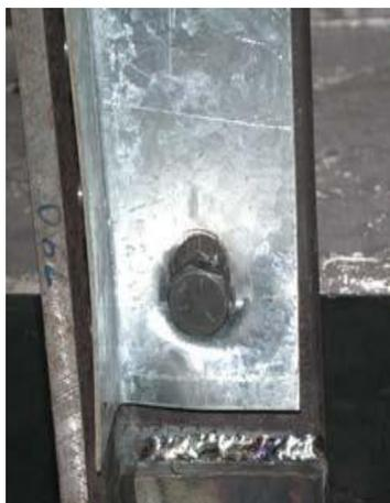
Figura 2.13 – Esmagamento da parede do furo em cantoneira
