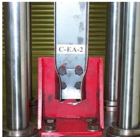
Figura 2.30 – Ruptura da seção líquida em perfil U
