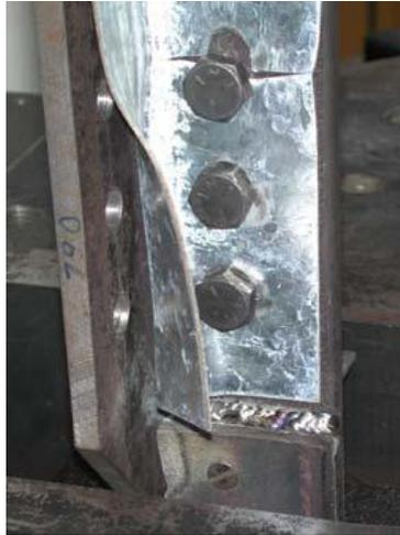
Figura 2.14 – Ruptura da seção líquida em cantoneira
