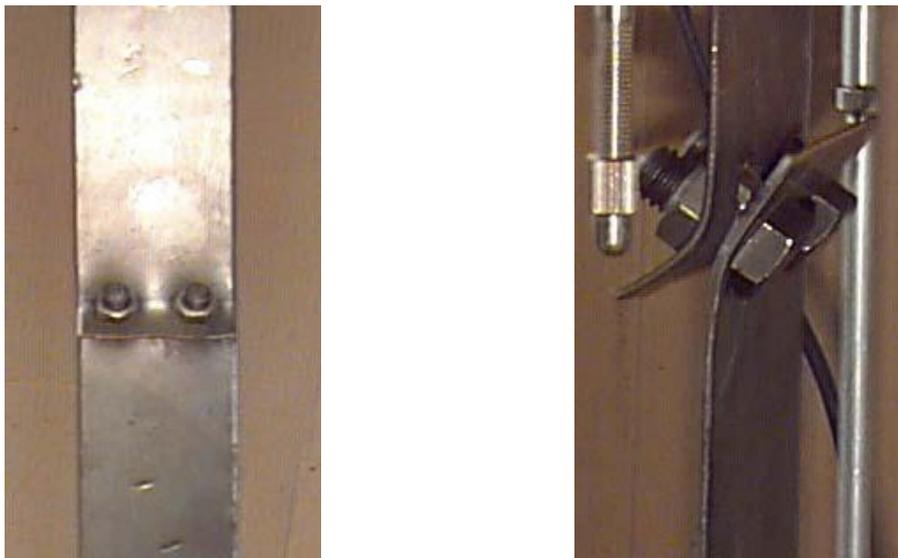
Figura 2.2 – Flexão excessiva da borda das chapas nas extremidades da ligação
