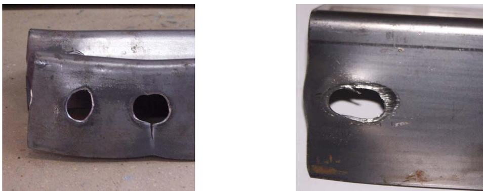
Figura 2.17 – ruptura da seção líquida e início de esmagamento em cantoneira
