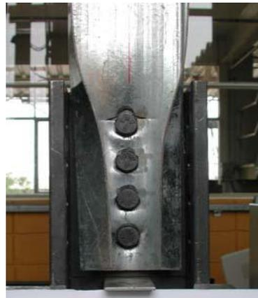
Figura 2.25 – Esmagamento da parede do furo e ruptura da seção líquida em perfis U
