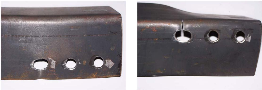
Figura 2.18 – Estricção e ruptura da seção líquida em ligações excêntricas
