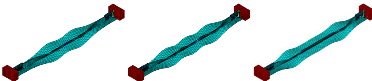
Figura 2.11 – Exemplos de imperfeições geométricas iniciais para dupla cantoneira (em escala ampliada) obtidas por meio de modelos numéricos em Elementos Finitos.
