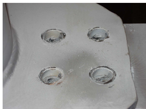
Figura 5.11 - Fotos das deformações nas mesas e anéis e alargamento dos furos na região tracionada.
