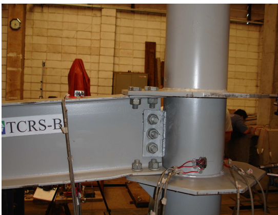
Figura 5.13 - Fotos da plastificação da mesa comprimida.
