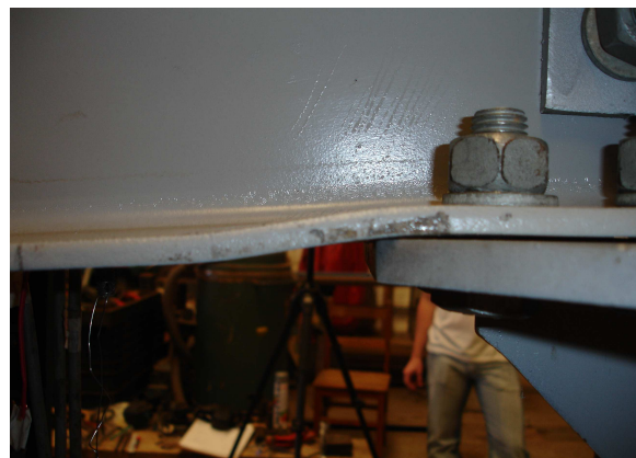
Figura 5.13 - Fotos da plastificação da mesa comprimida.
