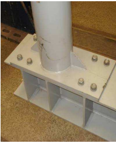
Ligação da viga base com a coluna
