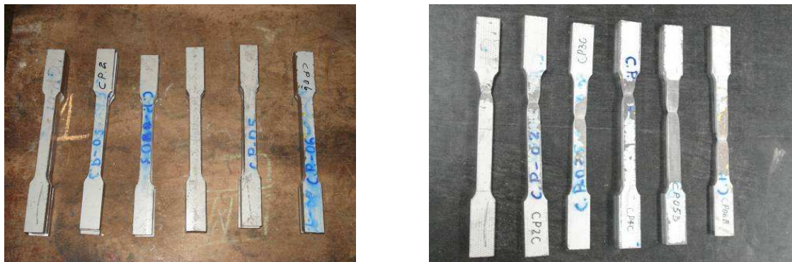
Figura 3.11 - Fotos dos corpos de prova antes e depois dos ensaios de caracterização.
