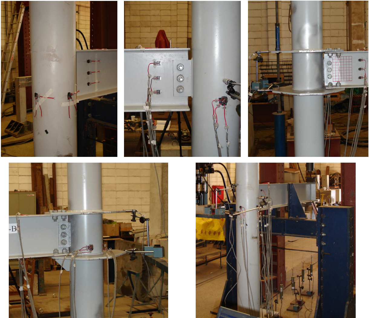
Figura 3.10 – Fotos dos detalhes da instrumentação dos protótipos.
