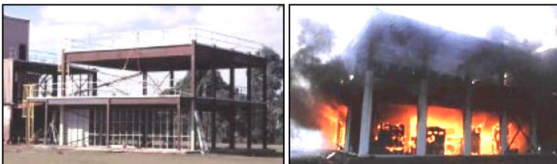
**Figura 2.10** – Imagens dos ensaios de resistência ao fogo de Collins Street conduzidos pela BHP na Austrália. Fonte: BRITISH STEEL (1999).
