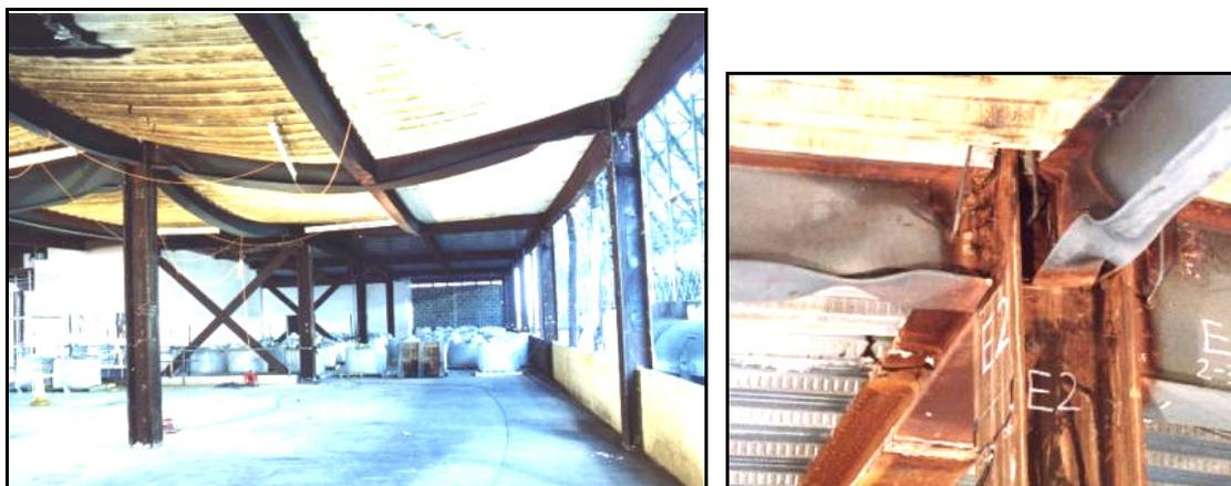
**Figura 2.12** - Vista geral de um dos pavimentos e configuração deformada dos elementos estruturais após ensaios. Fonte: LAMONT (2001).
