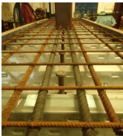
(a) Armação da laje do Modelo 2.
