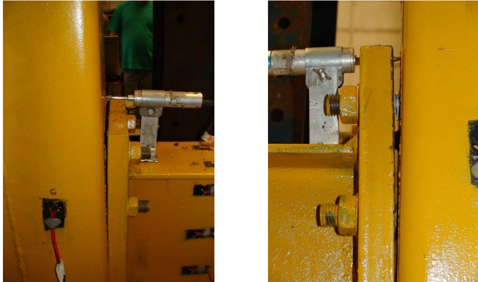
Figura 3-50 – Abertura da ligação do Modelo Piloto.
