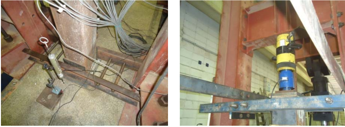
Figura 3-44 – Travamento da base e topo dos pilares.
