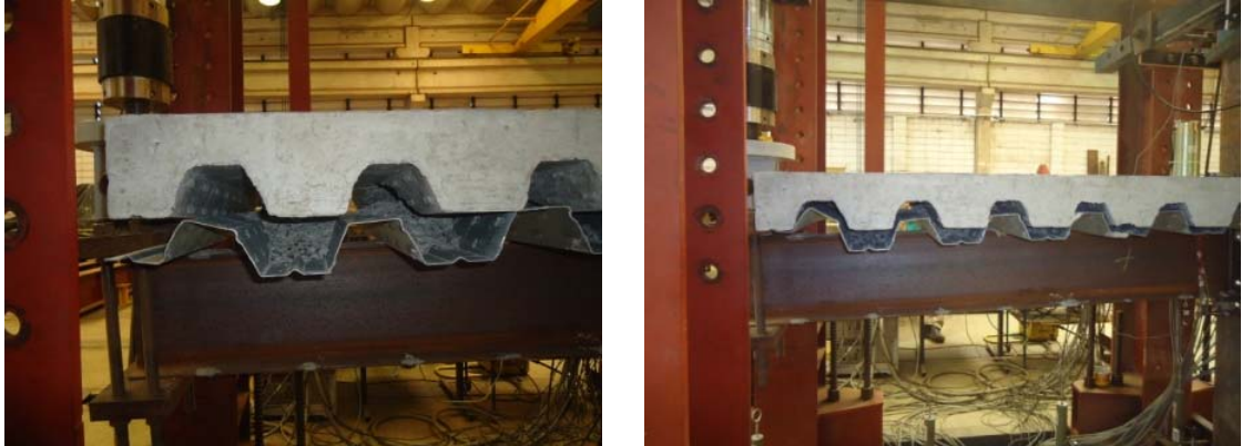
Figura 3-65 – Descolamento da laje e a viga do Modelo 2.
