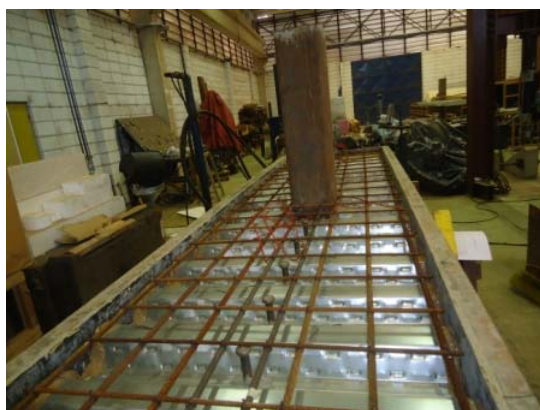
(a) Armação da laje do Modelo 3.
