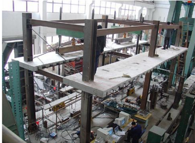
Figura 2-23 – Pórticos ensaiados por Wang e Li (2007).
