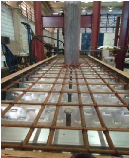
(a) Armação da laje do Modelo 1.
