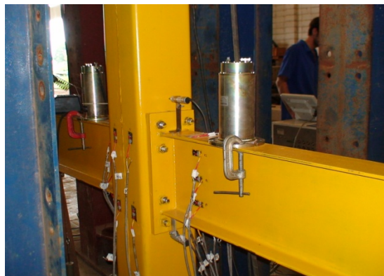
Figura 3-39 – Instrumentação da abertura da ligação no Modelo Piloto.
