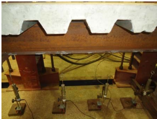
Figura 3-33 – Transdutores localizados abaixo da viga.
