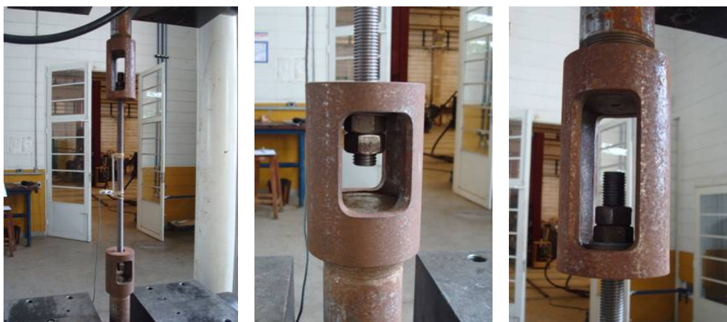
Figura 3-5 – Ensaios de tração das barras rosqueadas (parafusos).
