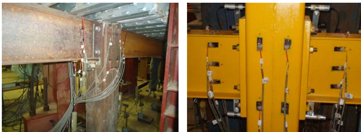
Figura 3-30 – Modelos de ligações com a instrumentação concluída.
