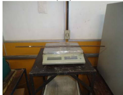
Pesagem das barras de 12,5 mm.
