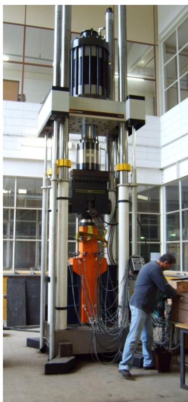
Figura 3.31 – Máquina Universal da marca INSTRON.
