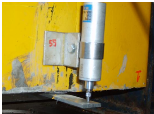
Figura 3.41 – Transdutor instalado para medir deslizamento do núcleo.
