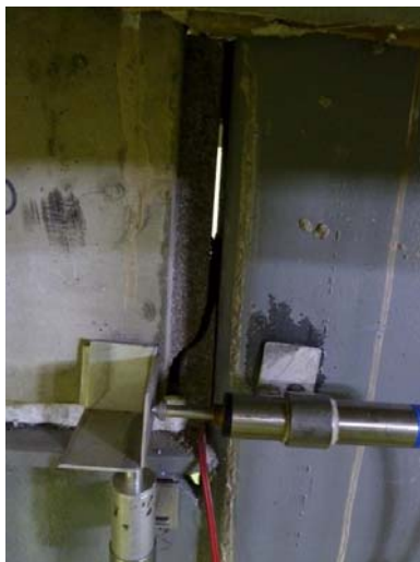
Figura 3.100 – Aspecto do graute entre a viga e o pilar ao final do ensaio – modelo 3.
