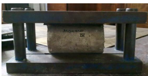
(a) Corpo-de-prova em aparato para ensaio de tração.
