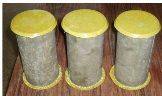
Figura 3.6 – Corpos-de-prova para ensaio de compressão.
