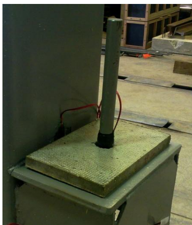
Figura 3.22 – Almofada de apoio pronta e instalada no consolo metálico.
