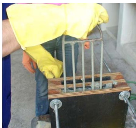
(a) preenchimento com auxílio do ‘garfo’.
