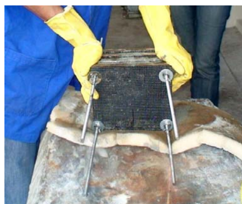
(b) Adensamento em mesa vibratória.
