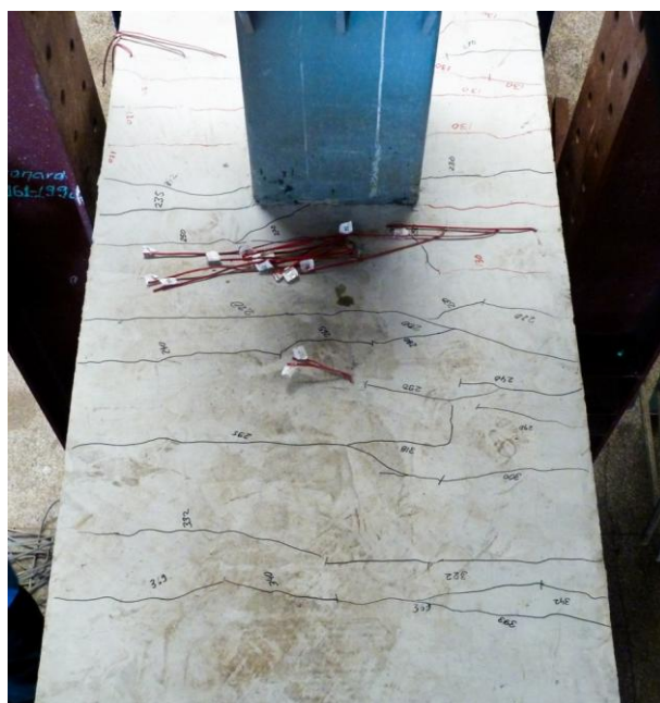
Figura 3.123 – Fissuração da capa – modelo 4.
