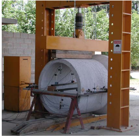
Figura 5.6 Vista geral do ensaio de compressão diametral.
