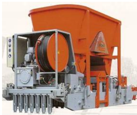
Figura 2.2: Fôrma deslizante. [Elliott (2005)]
