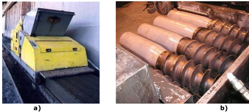
Figura 2.3: a) Extrusora; b) Detalhe das hélices. [Rettne & Edekling (2006)]
