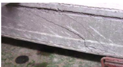
Figura 4.21: Fissuração de elemento de laje alveolar protendida, ensaiado por Tkalčić et al (2007).
