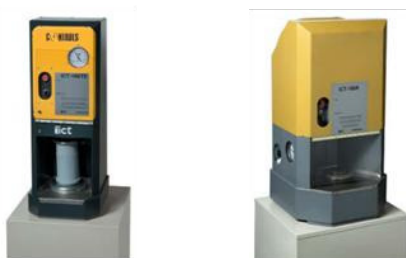
Figura 3.38: Equipamentos utilizados em ensaio de compactação de concreto com baixa trabalhabilidade [Invelop Oy (2009)]
