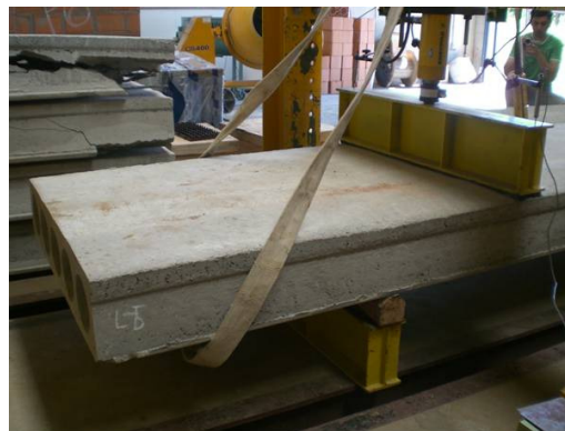
Figura 6.31: Ensaio da laje L30-S-26-9D12,7-W_C, 1 m de balanço e força aplicada a 2,5 h do apoio.
