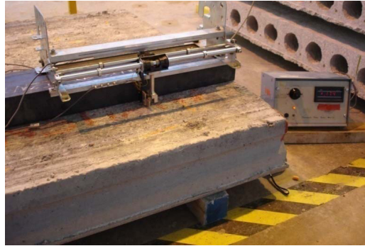
Figura 4.28: Instrumento para medir rugosidade superficial. [Ibrahim et al. (2008)]
