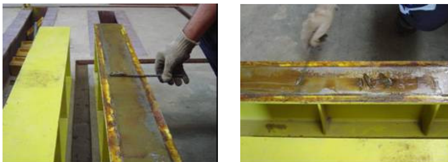
Figura 5.2: Aplicação de camada de graxa sobre os apoios.
