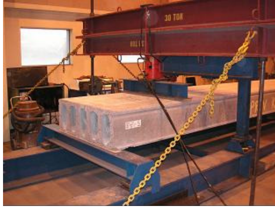
Figura 3.17: Ensaio típico para a determinação da resistência de lajes alveolares ao cisalhamento. [Rettne & Edekling (2006)]
