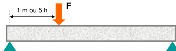
Figura 3.40: Ensaio indicado para observar a interação de flexão com cisalhamento.
