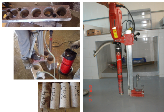
Figura 3.37: Equipamento para a extração de testemunhos de concreto.
