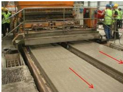
Figura 2.5: Sistema de fôrma tipo carrossel. [Elliott (2005)]
