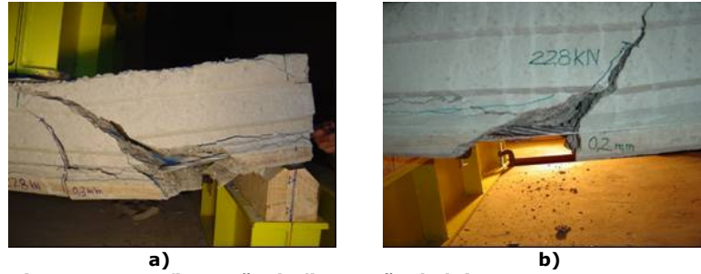
Figura 6.3: Configuração de fissuração da laje L2-S-20-8D12,7-X_C. a) Fissuração da face oposta; b) Fissuração da face frontal.
