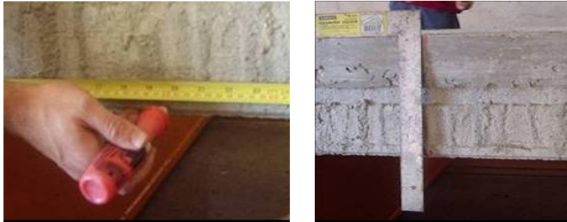
Figura 5.1: Medição e marcação nas faces da peça a ser ensaiada.
