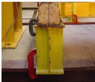
Figura 5.3: Apoio fixado à laje de reação.
