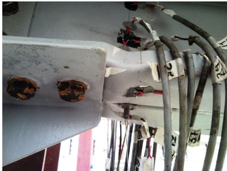
Figura 4.14 – Mecanismo de falha do modelo parafusado
