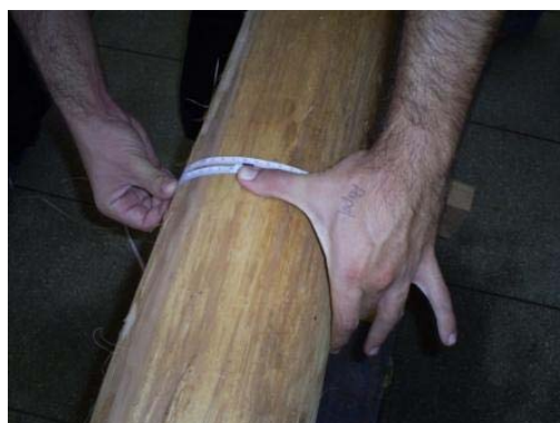
Figura 6.9: Medida do perímetro externo com utilização de uma fita métrica flexível. Fonte: Foto tirada pelo autor.
