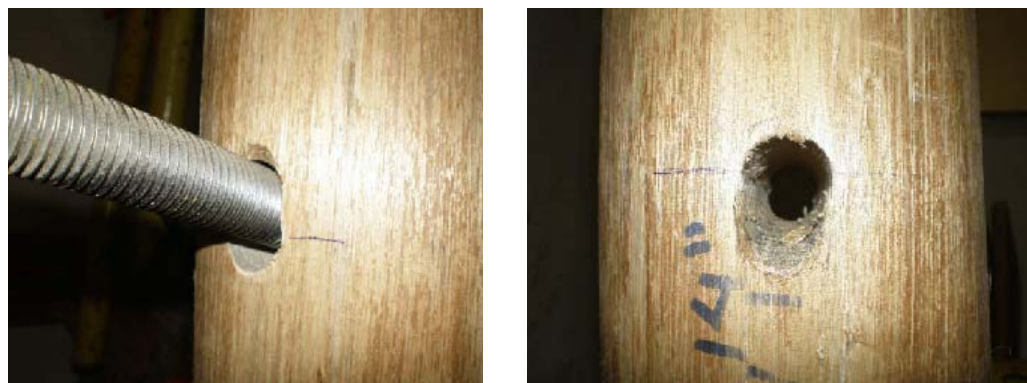
Figura 4.37 – Modo de falha por embutimento do pino na madeira roliça. Fonte: ZERBINO (2007).
