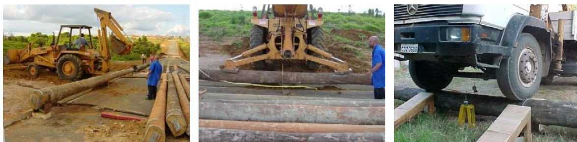
Figura 2.25: Ensaios das peças roliças c/ Eucalipto Citriodora: L_m = 11,4\text{ m} e d_m = 34,3\text{ cm} . Fonte: LaMEM.
