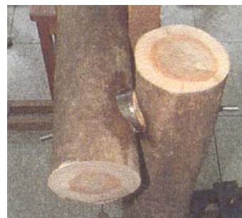
b) ensaio b: ruptura e flexão do pino.
