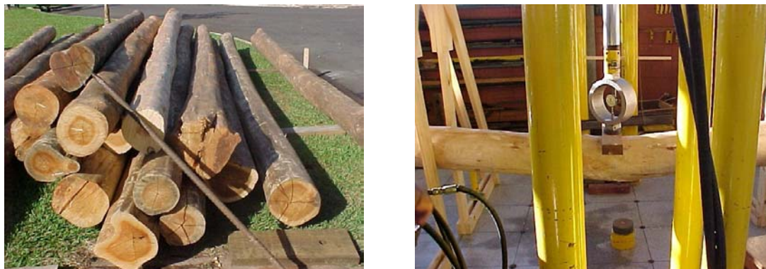
Figura 2.24: Ensaio de flexão com peças roliças c/ Eucalipto Citriodora: L = 6,01\text{ m} e d_m = 26,4\text{ cm} . Modo de ruptura: fratura fibrosa “dúctil”, no centro da viga. Fonte: Ensaio realizado no LaMEM.
