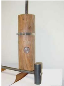
Conector com barra de aço e pino metálico galvanizado (Dowel-nut), utilizados nas ligações viga-coluna.
