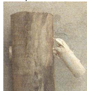
d) ensaio d: ocorreram dois casos, ruptura da viga e ruptura da cavilha.
