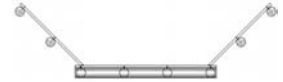
Planta do muro de contenção de terra. Posição das colunas de contraforte.
