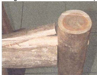
d) ensaio d: ocorreram dois casos, ruptura da viga e ruptura da cavilha.
