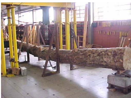
a) Ensaio de flexão Pinus Oocarpa
