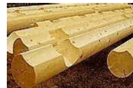
Entalhes para conexões nos encontros de paredes, de construções com sistemas estruturais tipo Log Homes.
