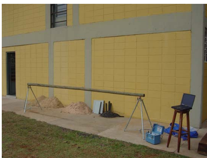
Figura 2.18: Ensaio de Peças Roliças pela Técnica da Vibração Transversal. Peças simplesmente apoiadas em Tripés. Fonte: Ensaio realizado no LaMEM.
