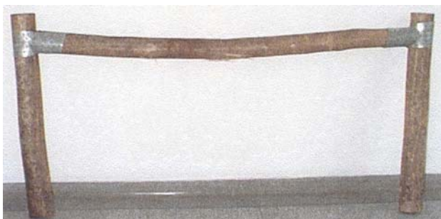
a) ensaio a: ruptura no centro da viga
