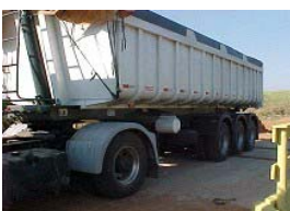
Carreta carregada para prova de carga.
