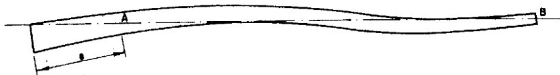
Figura 2.4: Curvatura Dupla, dois planos ou em duas direções no mesmo plano. Fonte NBR 8456:1984
