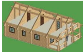
Perspectiva 1: Estrutura das paredes, vigas e colunas.
