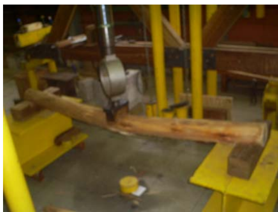
Figura 2.27: Ensaio estático à flexão com peças roliças de Eucalipto Camaldulensis (ensaio com anel dinamométrico e relógio comparador). Fonte: Fotos tiradas pelo autor, em ensaios realizados no LaMEM.
