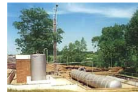
Madeira de reflorestamento, tratada com Impregnação de CCA em autoclave.
