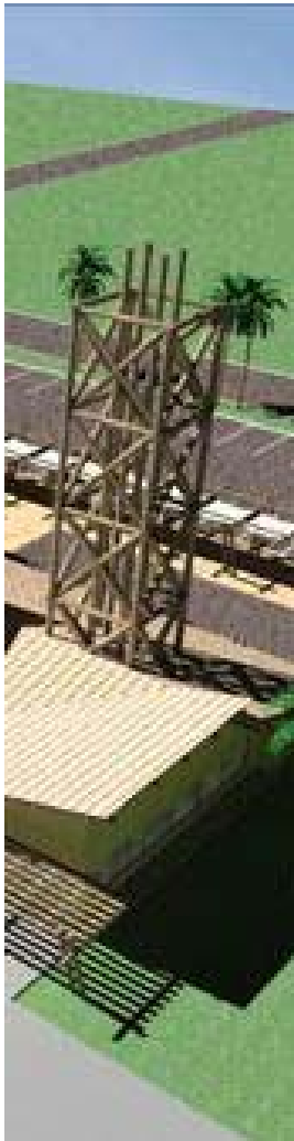
Maquete eletrônica. Projeto da torre com peças roliças de madeira, contraventada em X nas duas direções.
