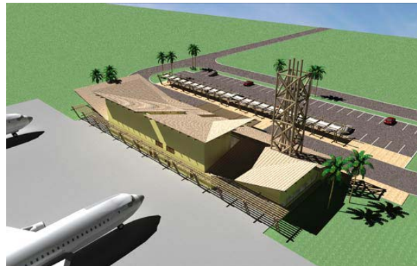
Maquete eletrônica: Vista da fachada principal de acesso às aeronaves e da estrutura da torre com peça roliça de madeira.
