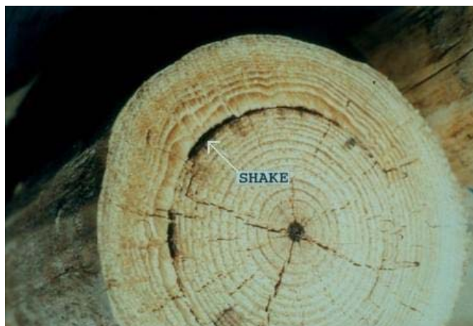
Figura 2.14: Abertura entre os anéis de crescimento. Fonte: Base de Dados LaMEM.
