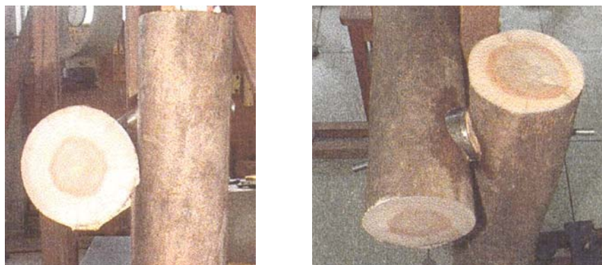
Figura 4.38: Modo de falha por flexão do pino metálico. Fonte: PARTEL (1999).
