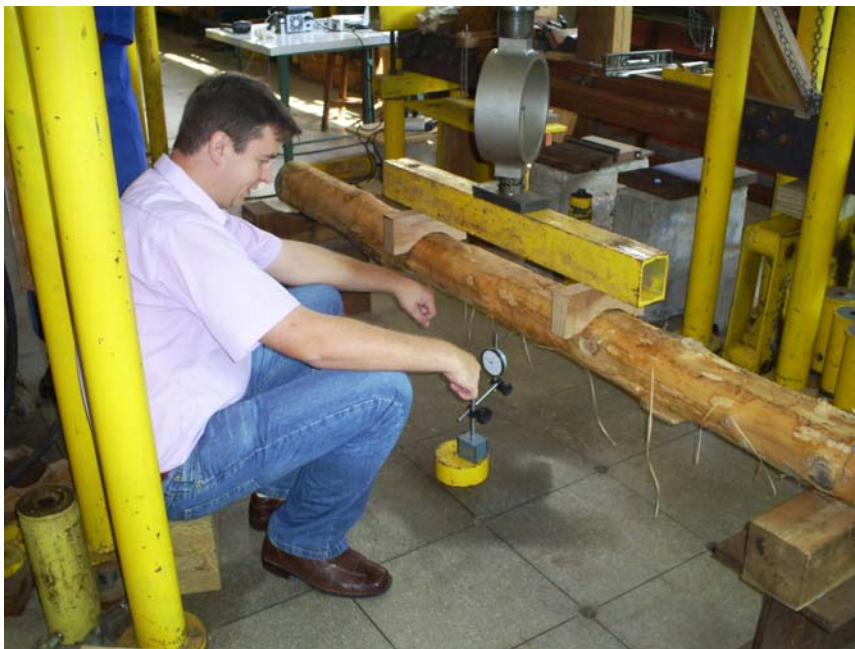
Figura 2.22: Ensaio estático de flexão com relógios comparadores de deslocamentos. Fonte: LaMEM. Fonte: Foto do autor, ensaios realizados no LaMEM em 2008.
