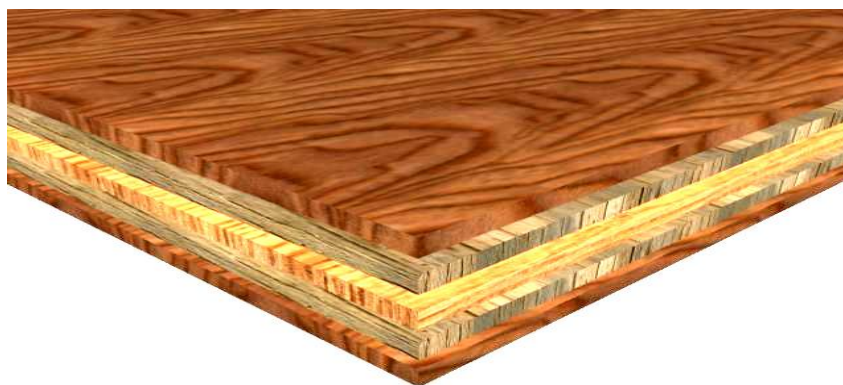
Figura 5.3 – Exemplo de material composto por diversas camadas de materiais com propriedades diferenciadas.
