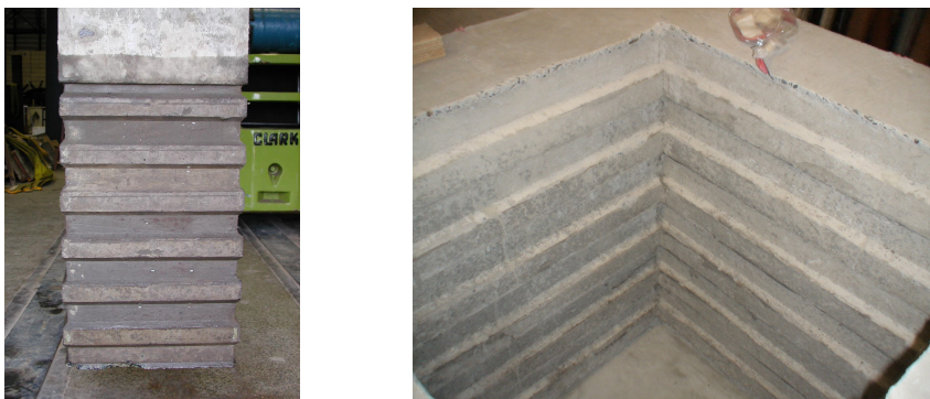
Figura 4.32 – Chaves de cisalhamento no pilar e colarinho de modelos ensaiados por Canha (2004)
