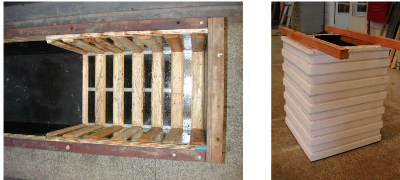
Figura 5.2 – Formas para moldagem do pilar e do cálice com interface rugosa
