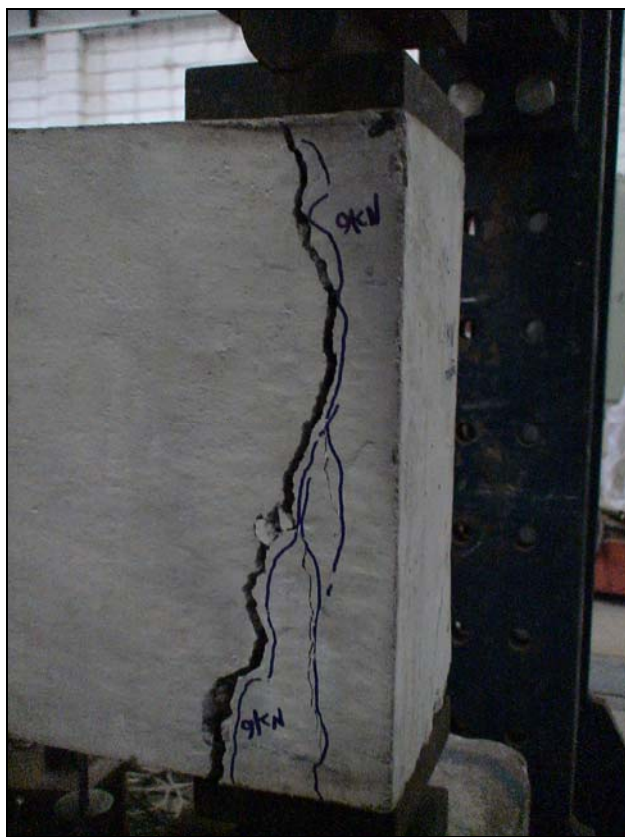
Figura 5.9 - Extremidade próxima ao apoio de uma das vigas do modelo 1.
