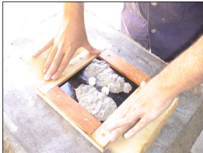
Figura 3.19 - Moldagem das almofadas de apoio.
