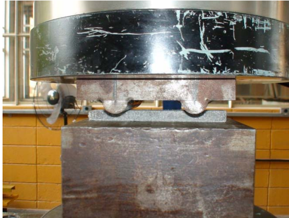
Figura 2.11 - Esquema de ensaio de afundamento (MONTEDOR, 2004)
