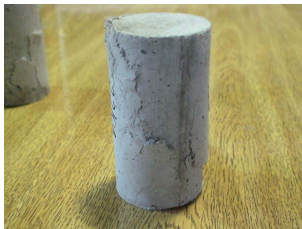
Figura 5.2 - Corpo-de-prova PP12 após ensaio de compressão simples
