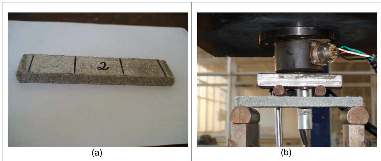
Figura 4.20 - (a) Amostra para ensaio de flexão; (b) Esquema de ensaio de flexão
