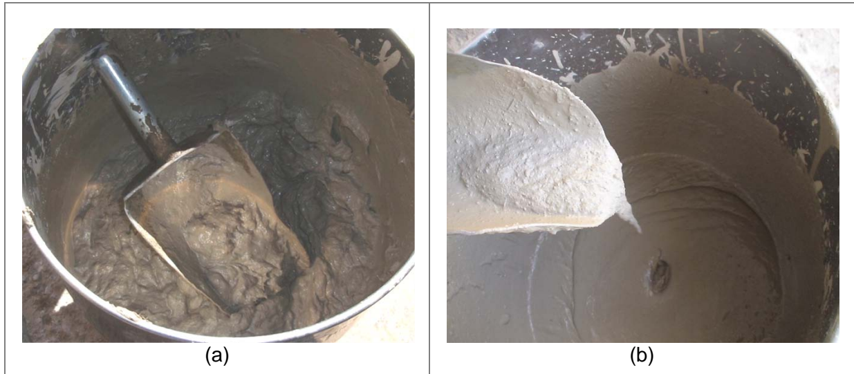
Figura 3.4 - Massa fresca com fibra de (a) 12 \mu m e (b) 180 \mu m
