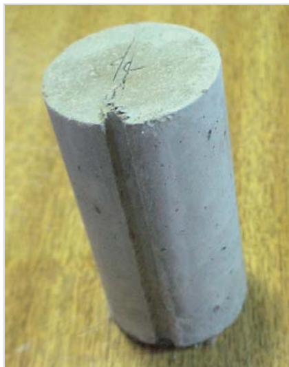
Figura 5.4 - Corpo-de-prova após ensaio de Tração
