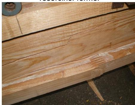
Figura 44 – Ruína de uma viga com alma de madeira serrada colada com adesivo a base de poliuretano
