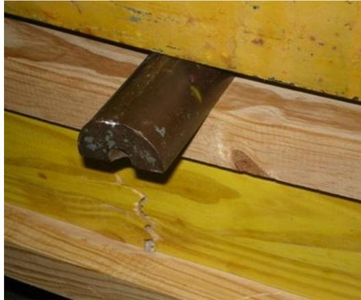
Figura 37 – Ruína da viga com alma de compensado sarrafeado.
