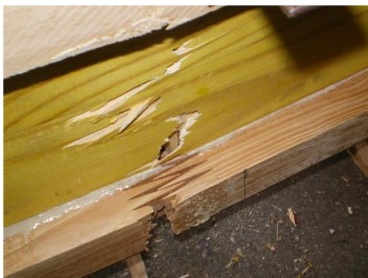
Figura 41 – Ruína de uma viga com alma de compensado laminado colada com adesivo de poliuretano
