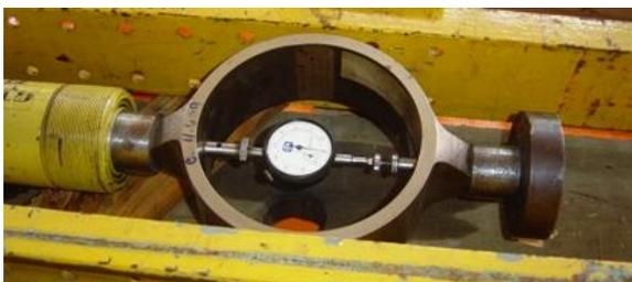
Figura 11 – Anel dinamométrico.
