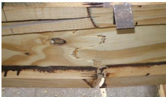
Figura 45 – Ruína de uma viga com alma de compensado laminado colada com adesivo a base de resorcinol-formol
