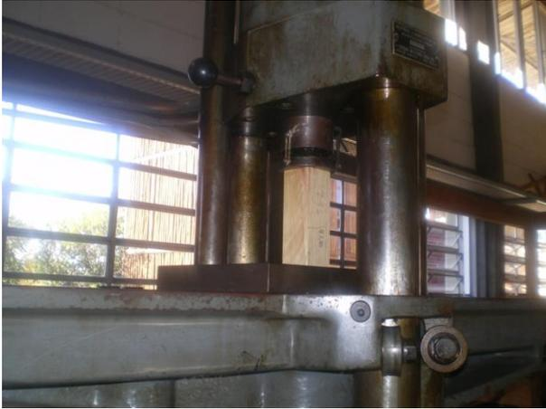
Figura 22 – Compressão paralela no corpo-de-prova retirado da madeira da mesa.
