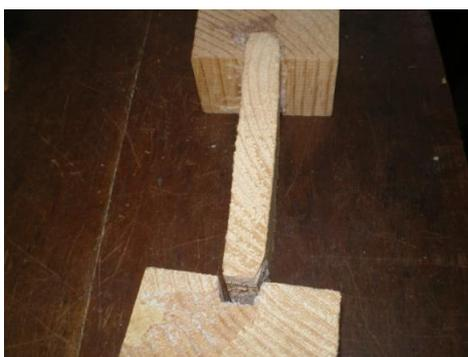
Figura 14 – Ruptura na linha de cola com emenda em cunha
