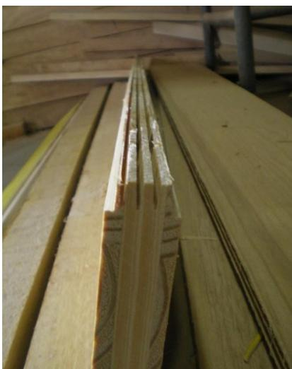
Figura 34 – Tentativa de fabricar os dentes no compensado sarrafeado.
