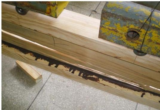
Figura 43 – Ruína de uma viga com alma de madeira serrada colada com adesivo a base de resorcinol-formol
