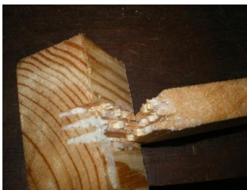
Figura 15 – Ruptura ao cisalhamento com emenda dentada.
