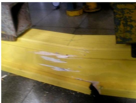
Figura 17 – Modo de ruína de uma viga H20 no ensaio para momento fletor.
