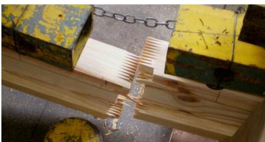
Figura 46 – Ruína de uma viga com alma de compensado laminado colada com adesivo a base de poliuretano
