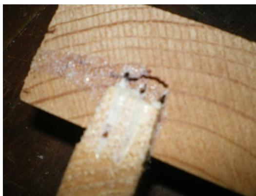
Figura 16 – Ruptura do corpo-de-prova com emenda dentada.
