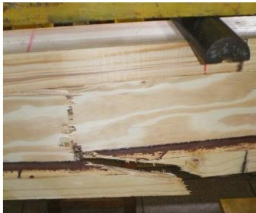
Figura 38 – Ruína da viga com alma de compensado laminado colada com adesivo a base de resorcinol-formol
