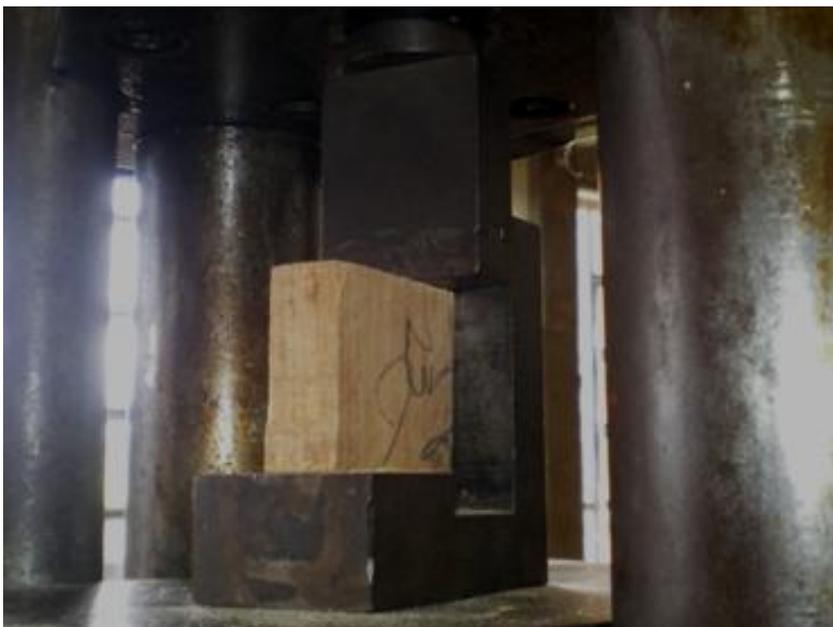
Figura 31 – Corpo-de-prova de cisalhamento da alma.
