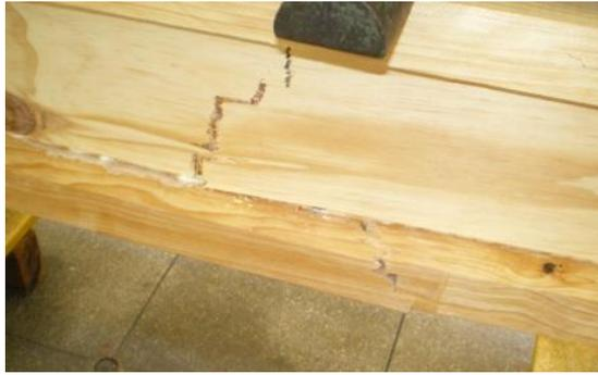
Figura 42 – Ruína da viga com alma de compensado laminado colada com adesivo a base de poliuretano
