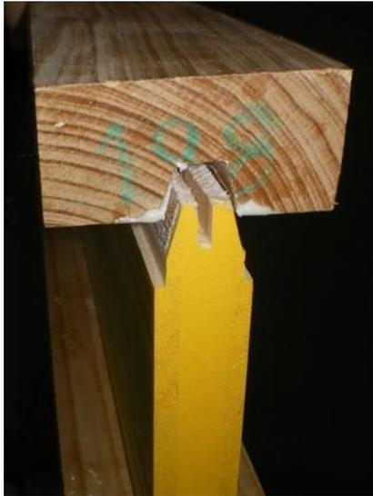
Figura 39 – Ruína de uma viga com alma de compensado sarrafeado colada com adesivo a base de poliuretano
