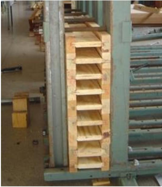
Figura 12 – Prensa feita para aplicar a pressão de colagem das vigas.
