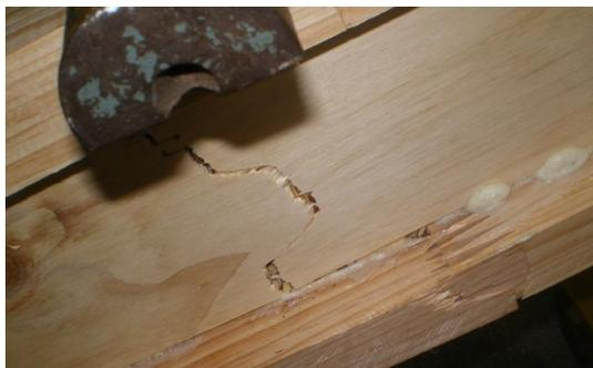
Figura 40 – Ruína da viga com alma de compensado laminado colada com adesivo a base de poliuretano
