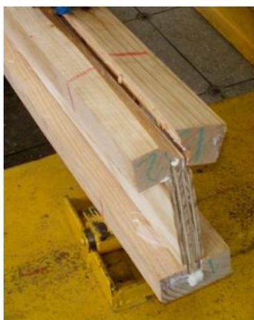
Figura 47 – Ruína de uma viga com alma de compensado laminado colada com adesivo a base de poliuretano
