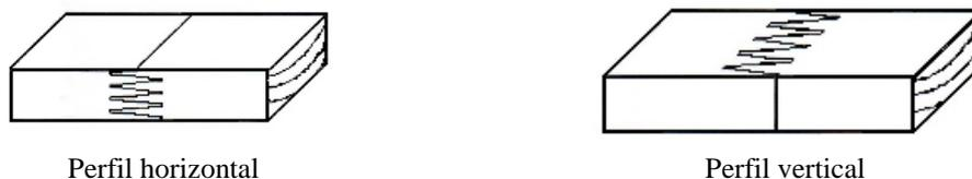
Figura 8 – Perfis das emendas dentadas.
